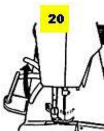
Механизм подъема прижимной лапки - 20. Для прижимной лапки предусмотрены три положения:
