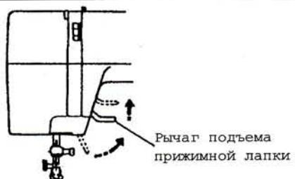
С помощью рычага лапку можно поднять и опустить. Лапку можно поднять на 1/4 выше, чем обычное верхнее положение. Это помогает перемещать лапку и прошивать толстый материал.
