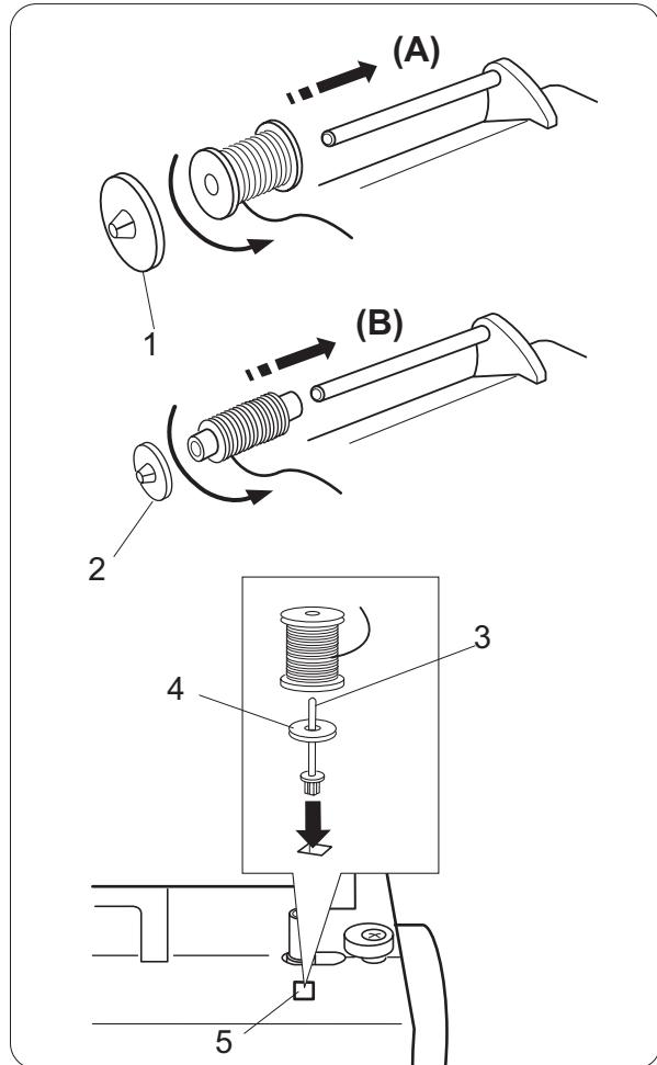
**Установка катушки на катушкодержатель**
