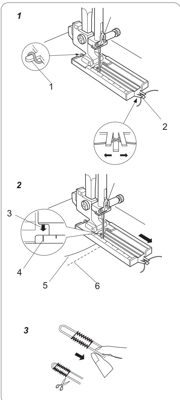
**1** Поднимите лапку для петли, набросьте шнур на крючок сзади лапки. Переведите концы шнура вперед, заправив под лапку. Засцепите шнур в вилке впереди лапки, чтобы натянуть его.
