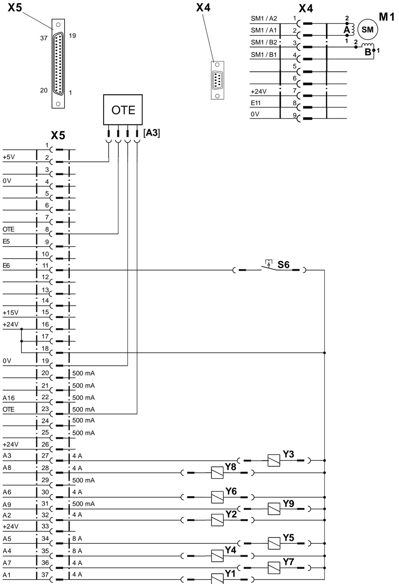
Bedeutung der Magnete bzw. Magnetventile, Taster / Meaning of magnets and/or solenoids and keys
