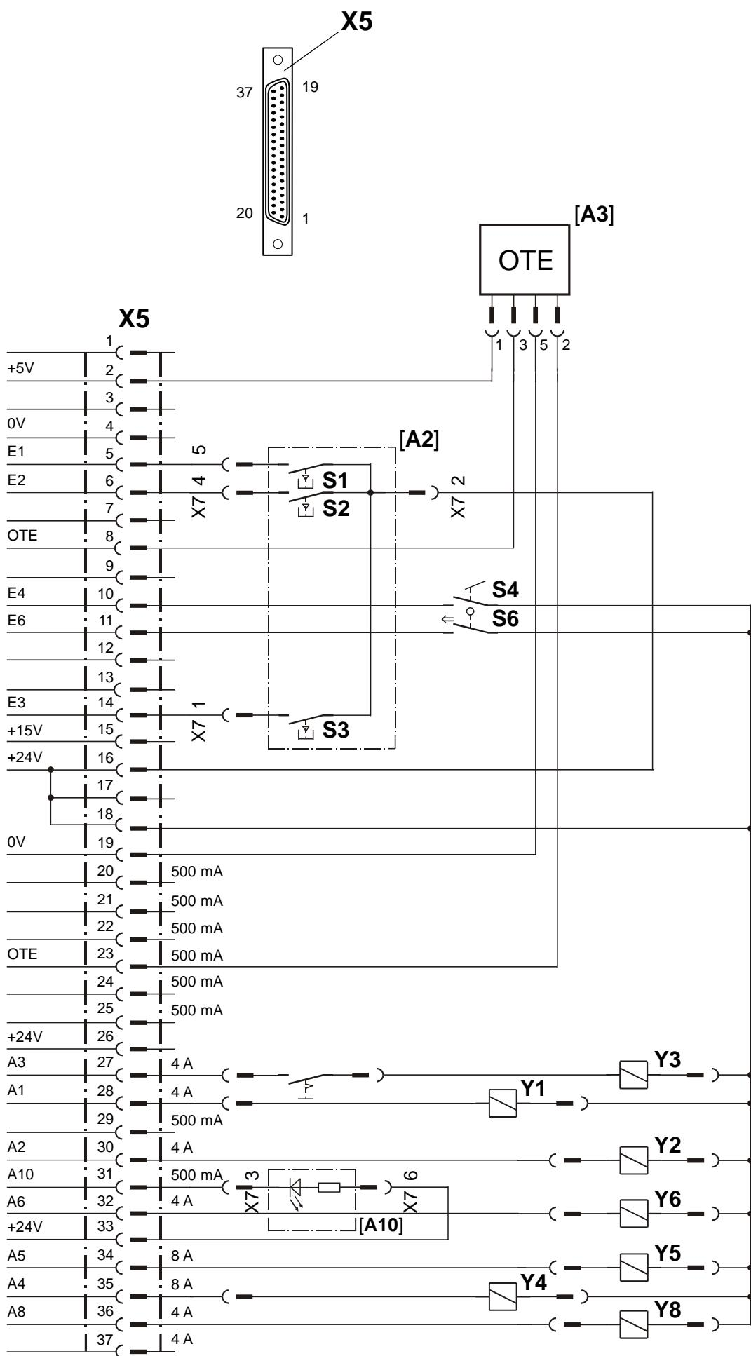
Bedeutung der Magnete bzw. Magnetventile, Taster / Meaning of magnets and/or solenoids and keys
