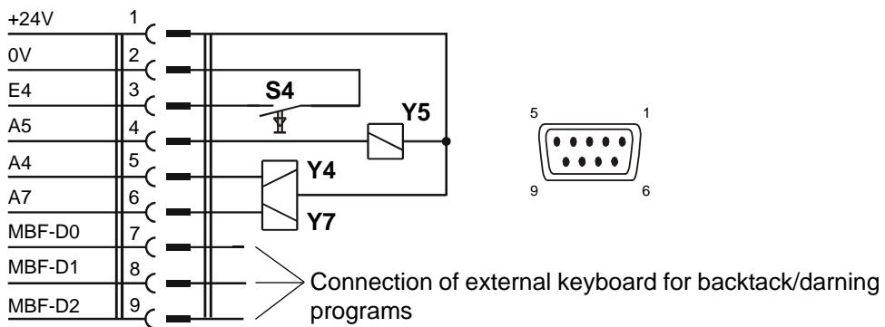
Bedeutung der Magnete bzw. Magnetventile, Taster / Meaning of magnets and/or solenoids and keys
