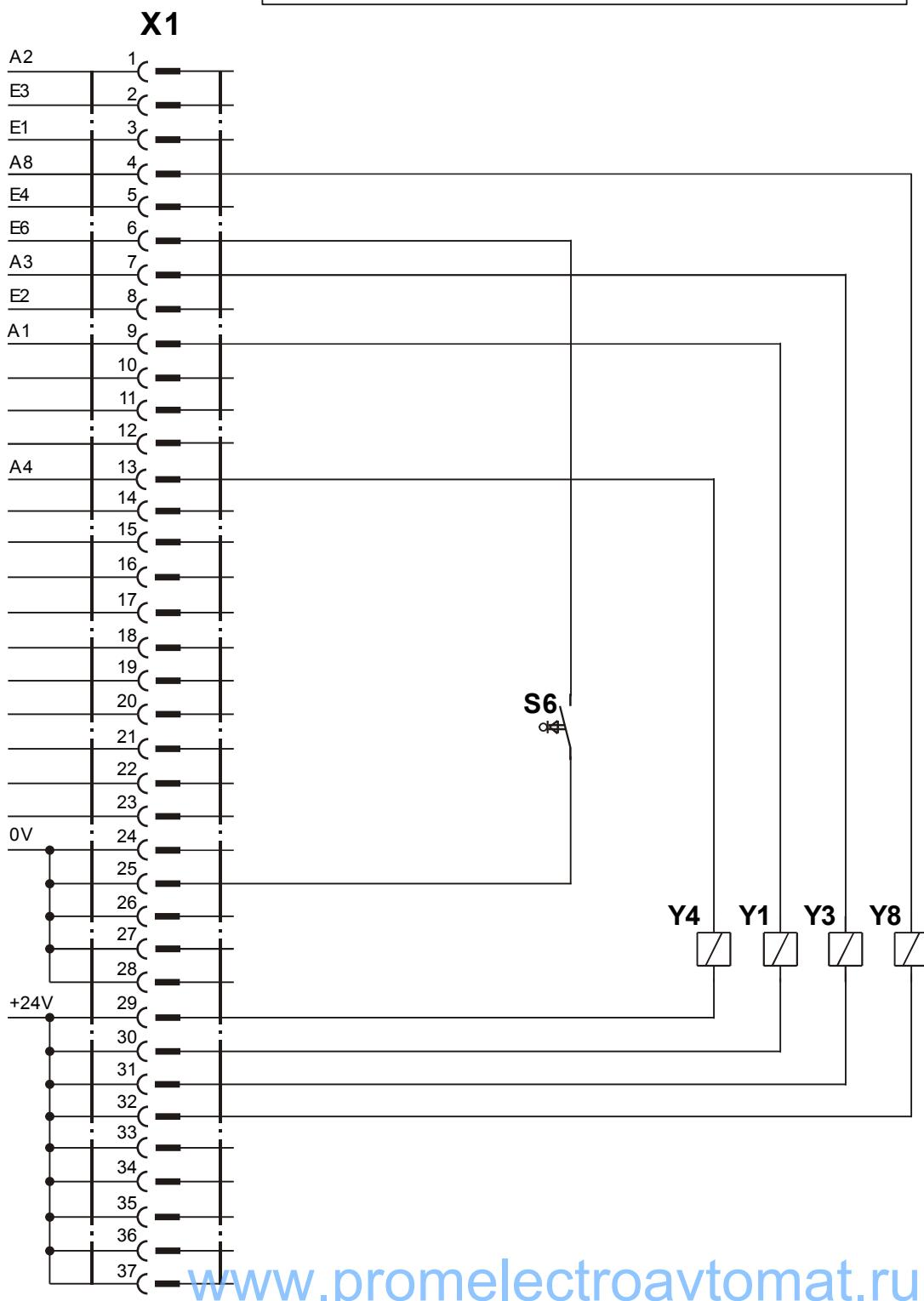
Bedeutung der Magnete bzw. Magnetventile, Taster / Meaning of magnets and/or solenoids and keys
