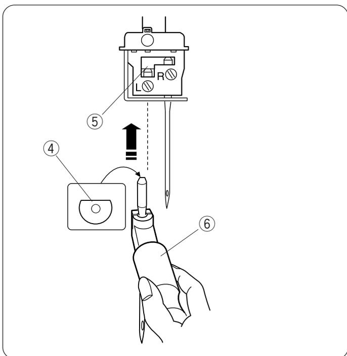
Вставьте новую иглу в фиксатор иглы плоской стороной назад, подтолкните иглу вверх к стопору.
