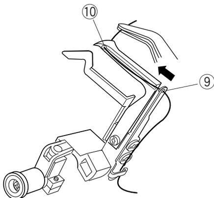
3 Удерживая нить с двух сторон, вставьте ее между дисками натяжения, немного натяните. ( Если поднят рычаг прижимной лапки, нить легко пройдет между дисками натяжения).
