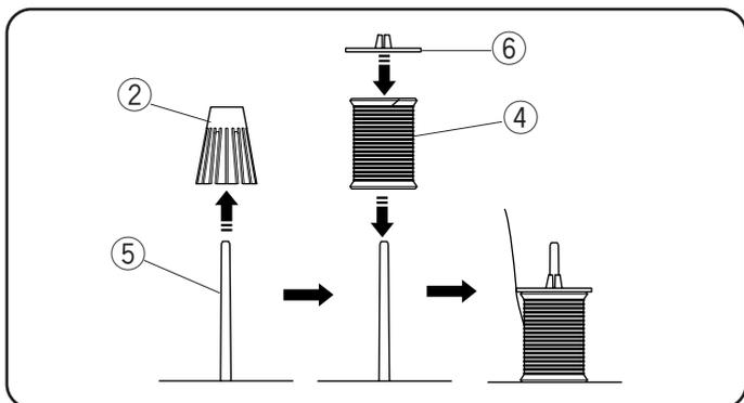
При использовании маленьких катушек снимите с катушечных стержней держатели катушек.
