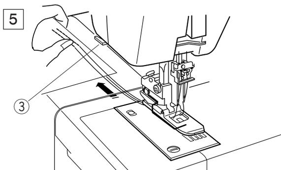
5 Снимите ткань и обрежьте нити при помощи нитеобрезателя.
