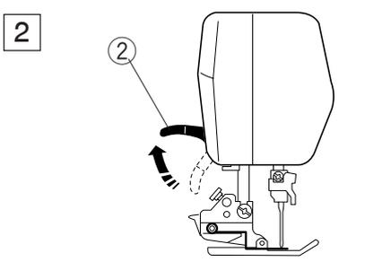
2 Поднимите рычаг прижимной лапки и саму лапку.
