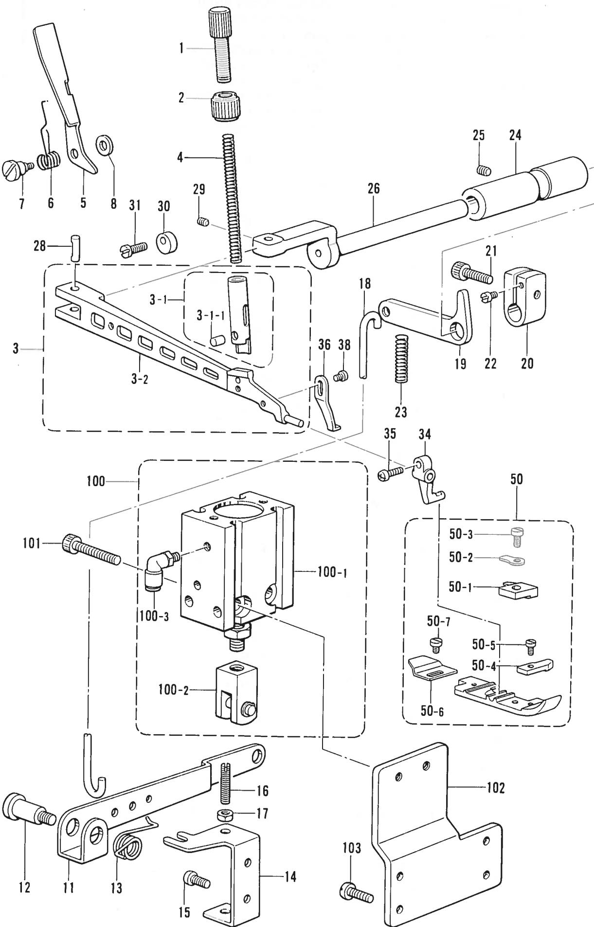
D. 押工関係/Presser foot mechanism/Stoffdrückerfuß/
