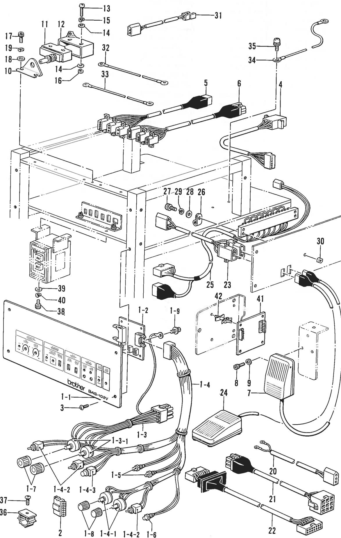
Q. 電装品関係 / Power supply equipment mechanism / Stromversorgung / Mécanisme de l'équipement en alimentation électrique / Mecanismo del equipo de alimentación de corriente
