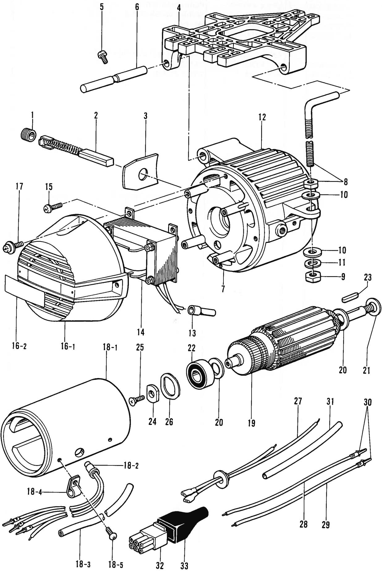
T1. モータ関係(1)/Motor mechanism (1)/Motors (1)/
