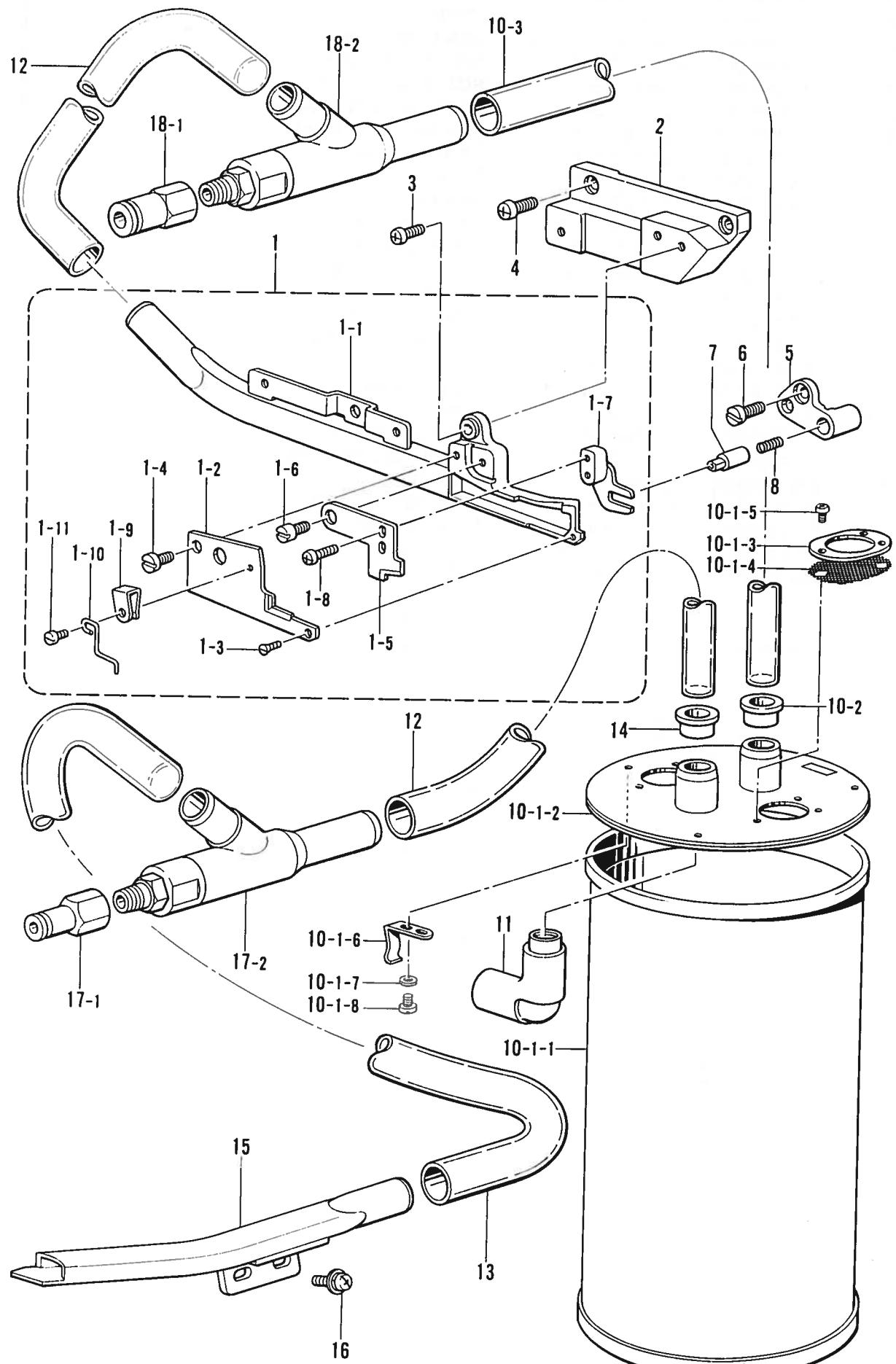
N. チェンカッタ・クリーナー装置 /Chain cutter and cleaner device/Kettenstich-Fadenabschneider/
