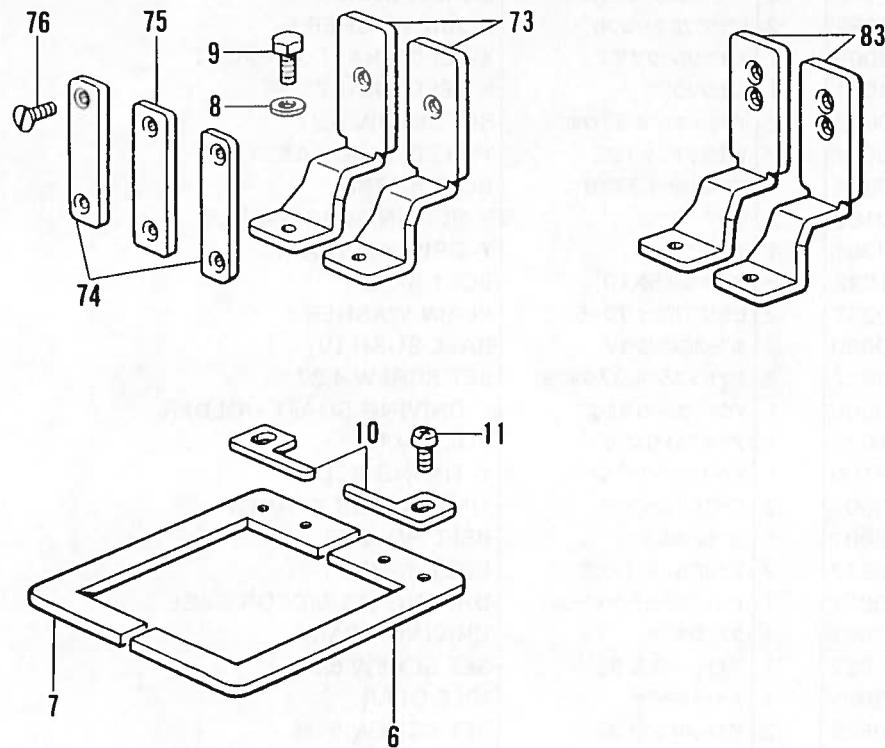
E. ワイパー関係 / Thread wiper mechanism / Fadenwischvorrichtung /
