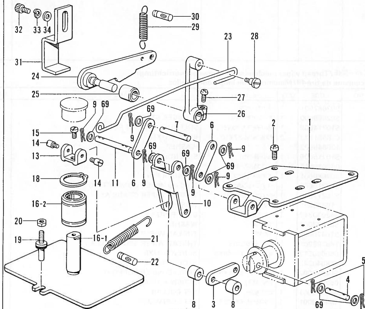
F. 押工上ヶ関係 /Work clamp lifter mechanism /Stoffhalterhebervorrichtung /
