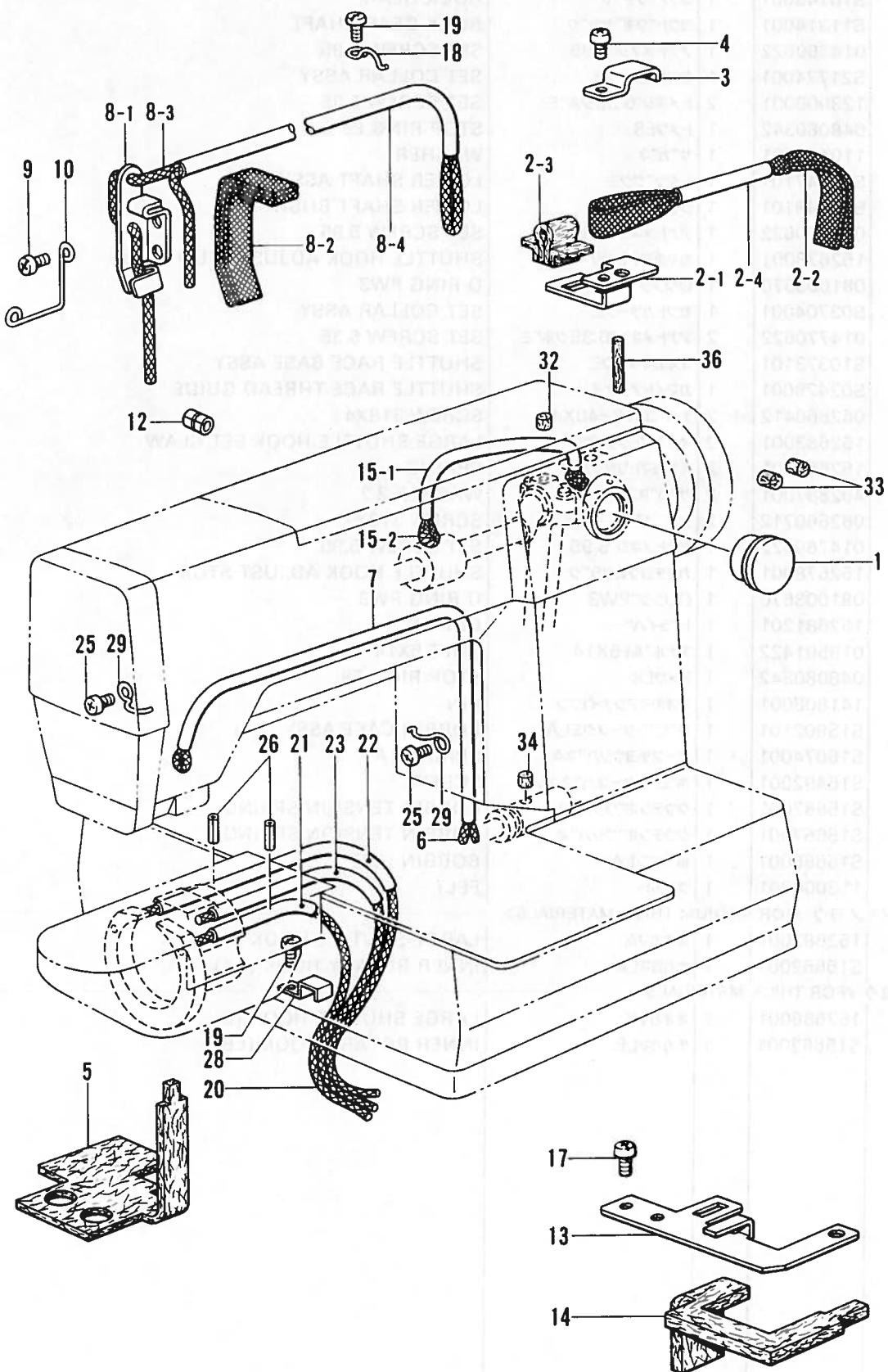
J. 給油・潤滑関係 / Lubrication / Schmierung / Lubrification / Lubricación
