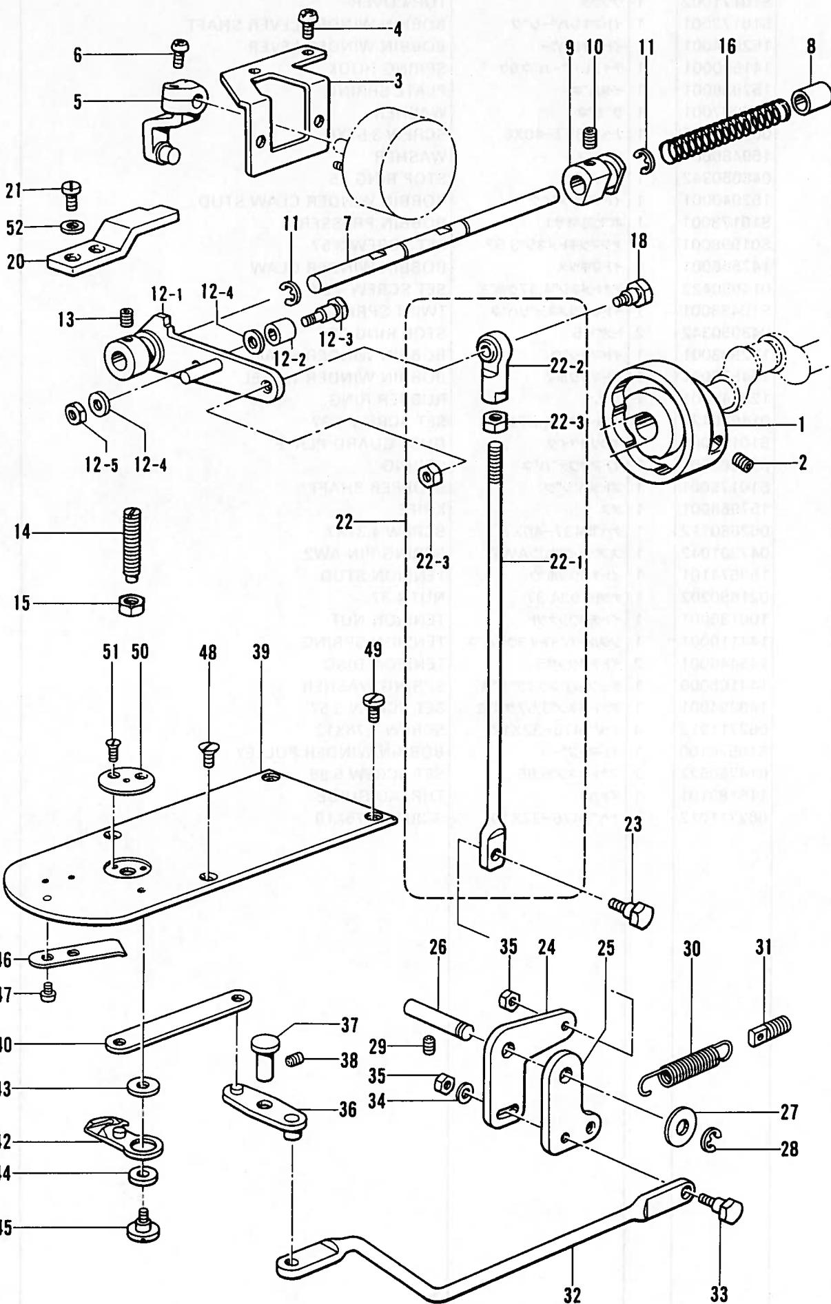
M. 糸切り関係/Thread trimmer mechanism/Fadenabschneidevorrichtung/
