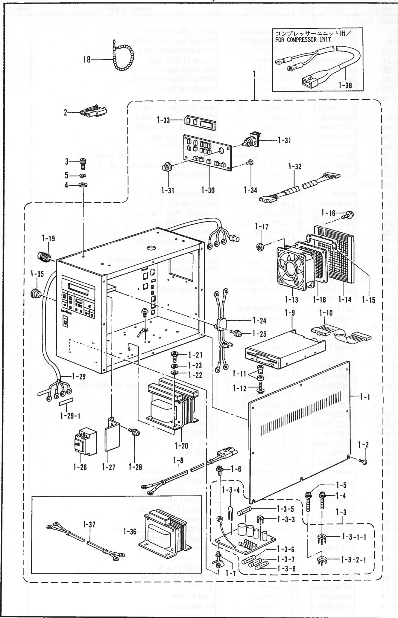
S. コントロールボックス関係 / Control box mechanism / Stromversorgung /
