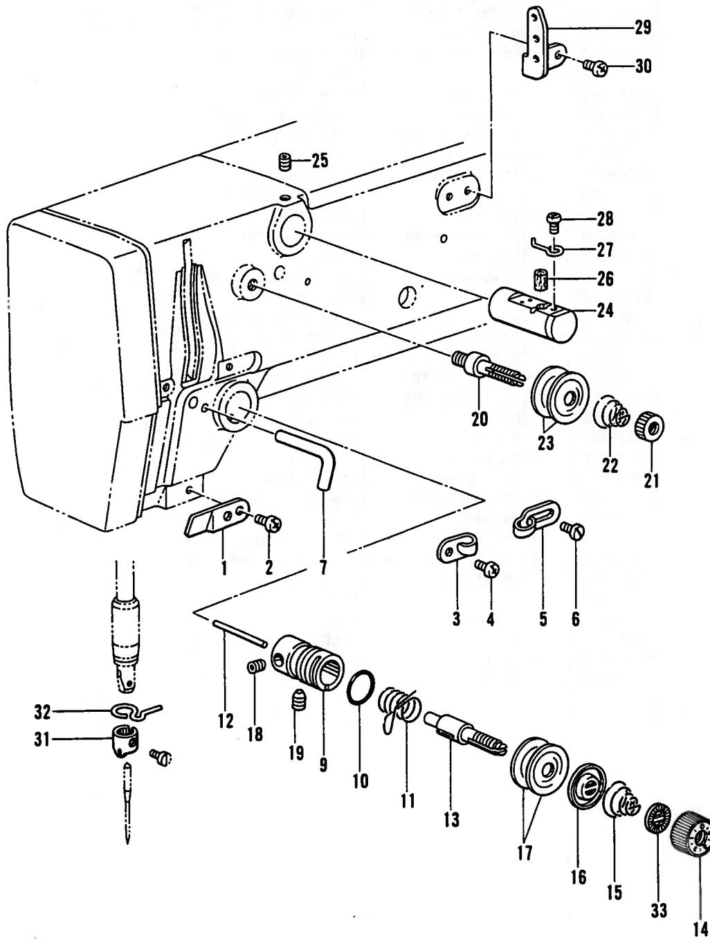
J. 糸通シ関係 / Threading mechanism / Fadenführungs vorrichtung /
