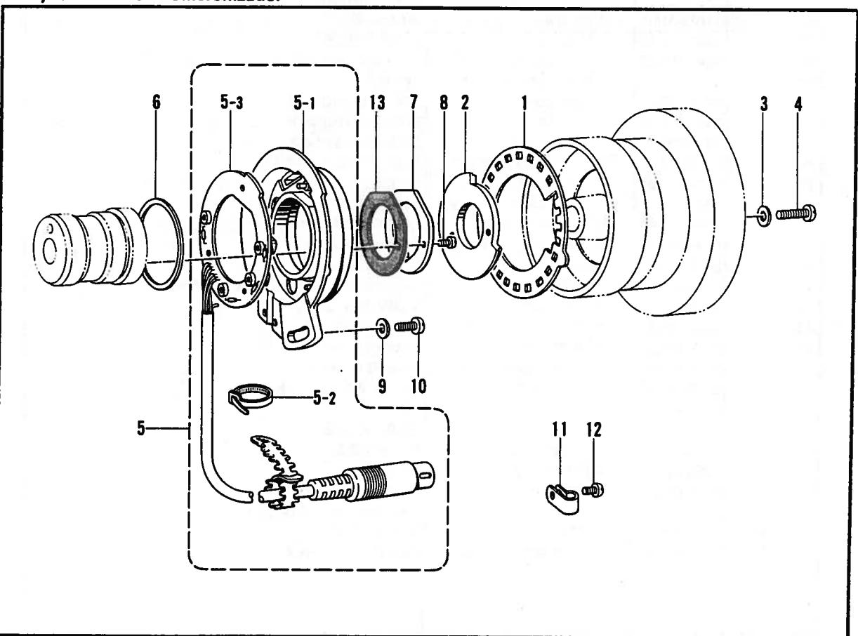
M. ウィパー関係 / Thread wiper mechanism / Fadenwischvorrichtung /
