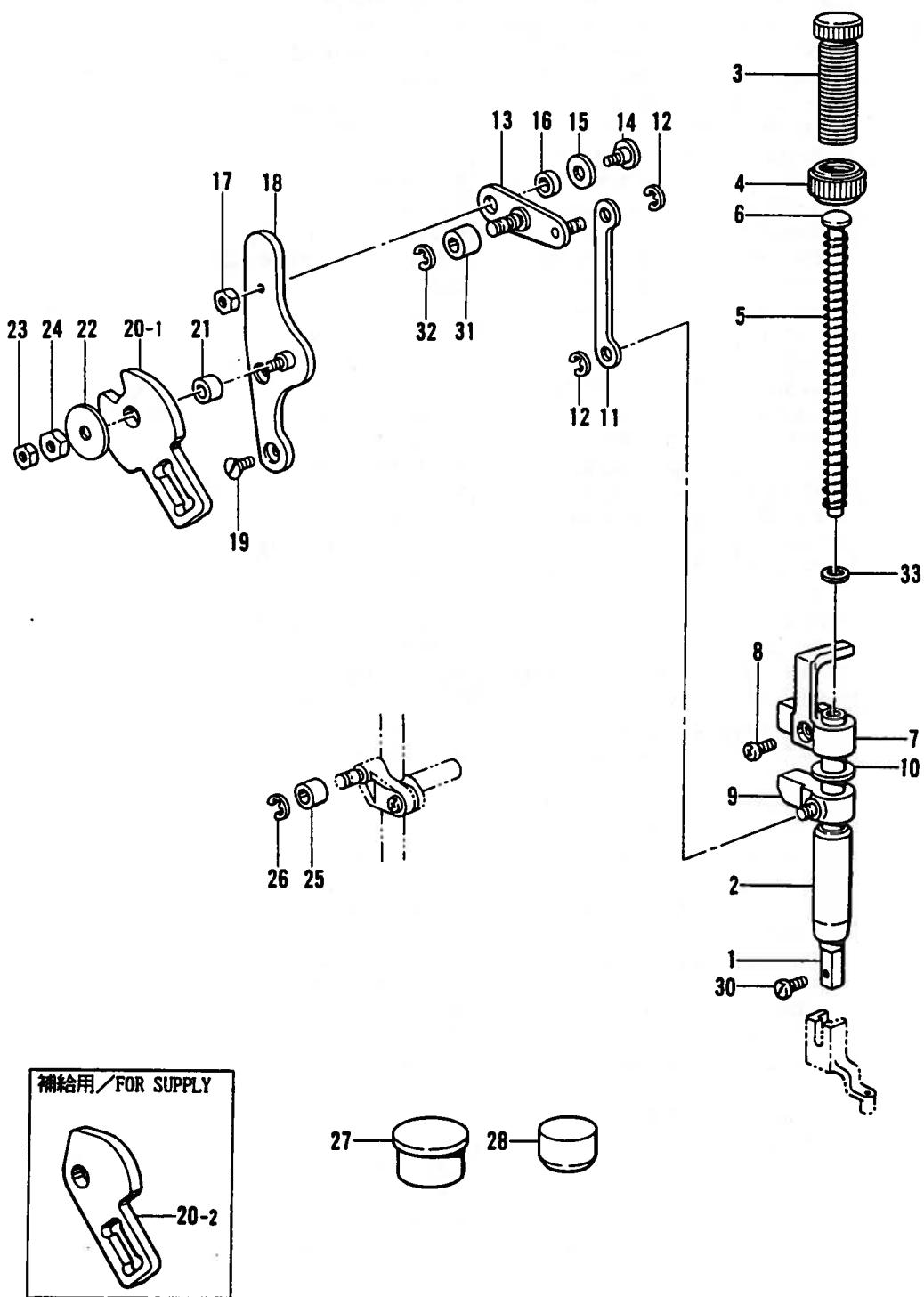
E. 押工上部関係 / Work Clamp Lifter mechanism / Stoffhalterhebervorrichtung /
