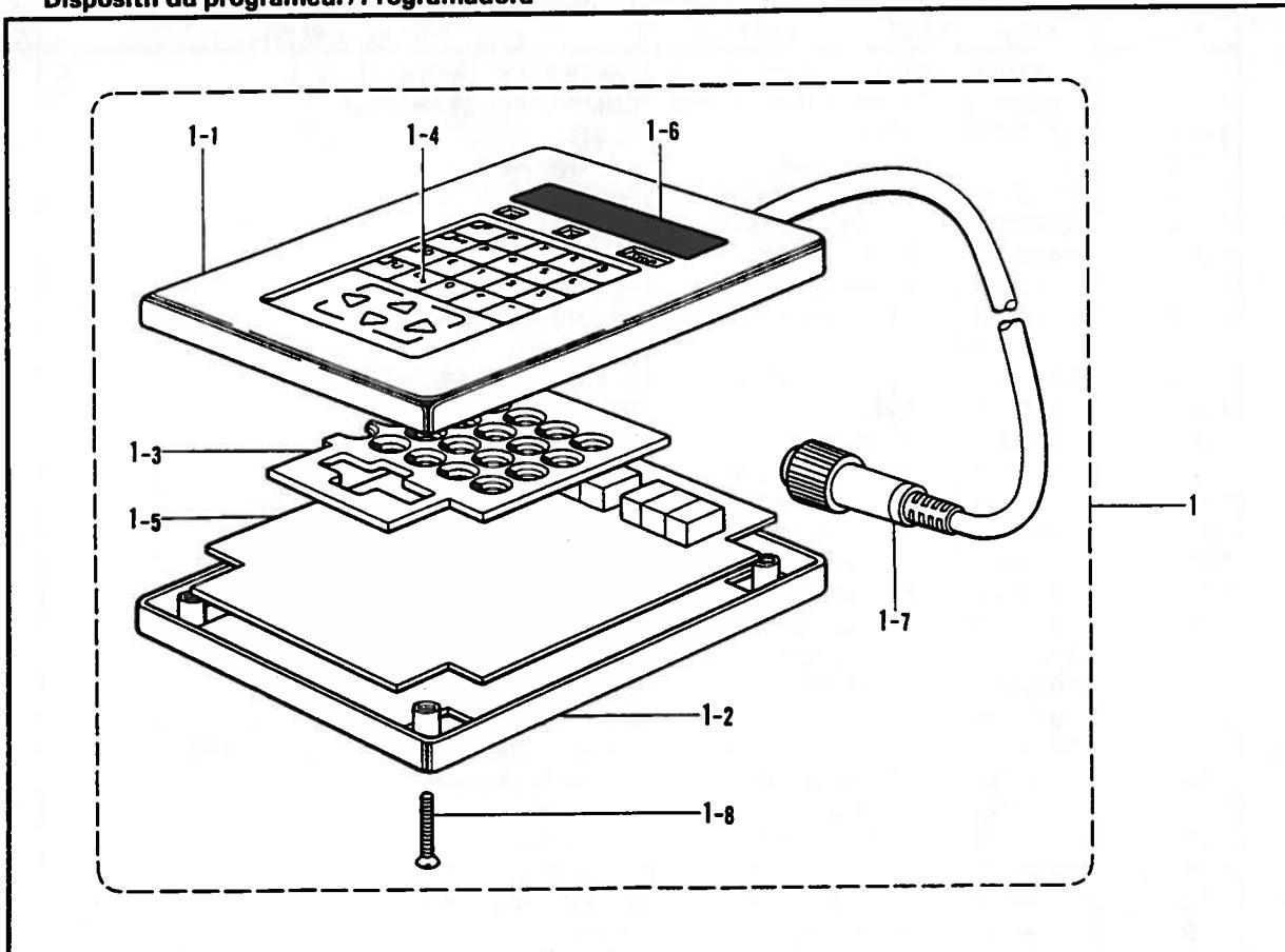
Y. 付属装置関係 / Programmer device / Programmvorrichtung /
