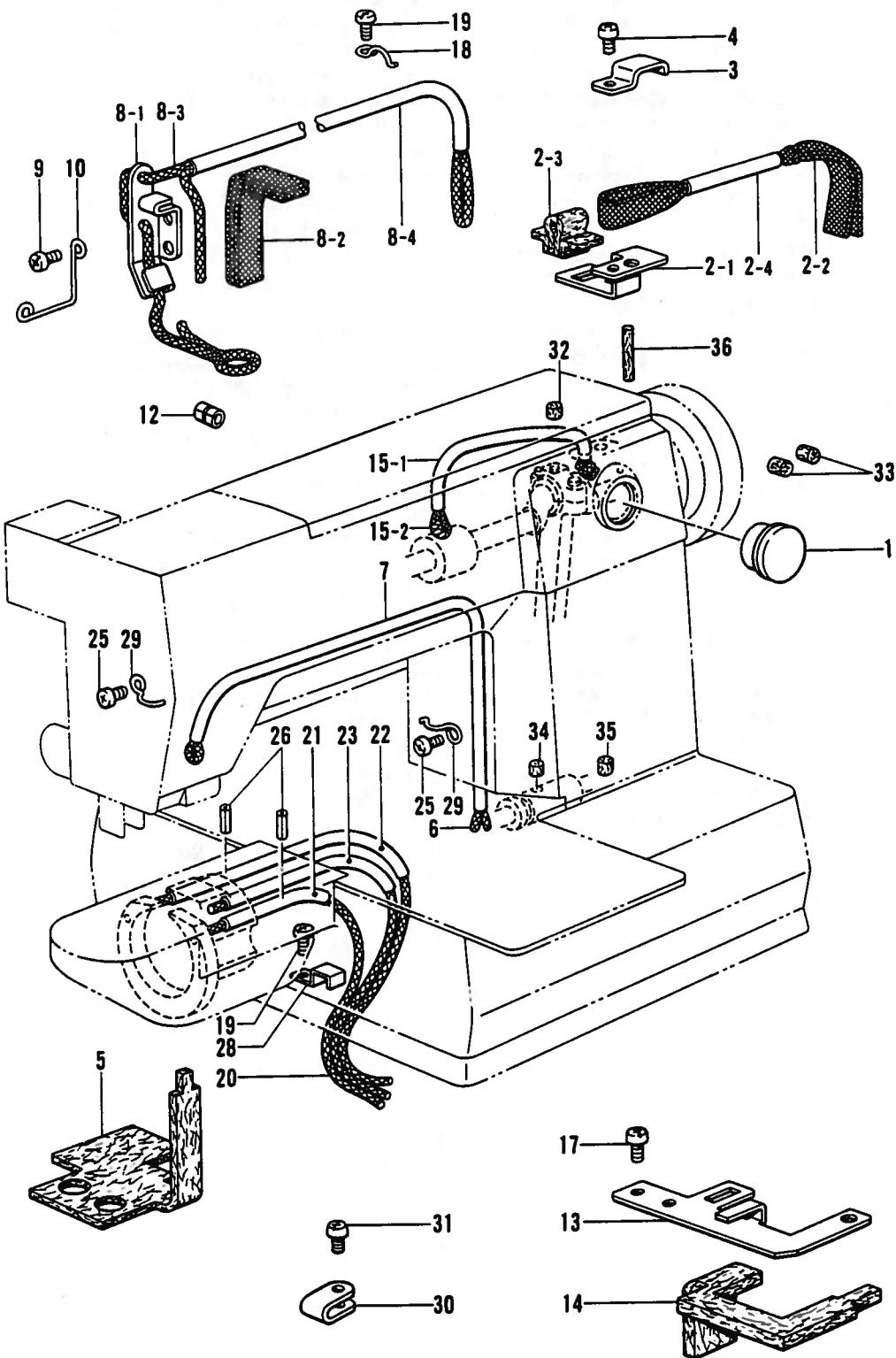
H. 給油・潤滑関係 / Lubrication/Schmierung/
