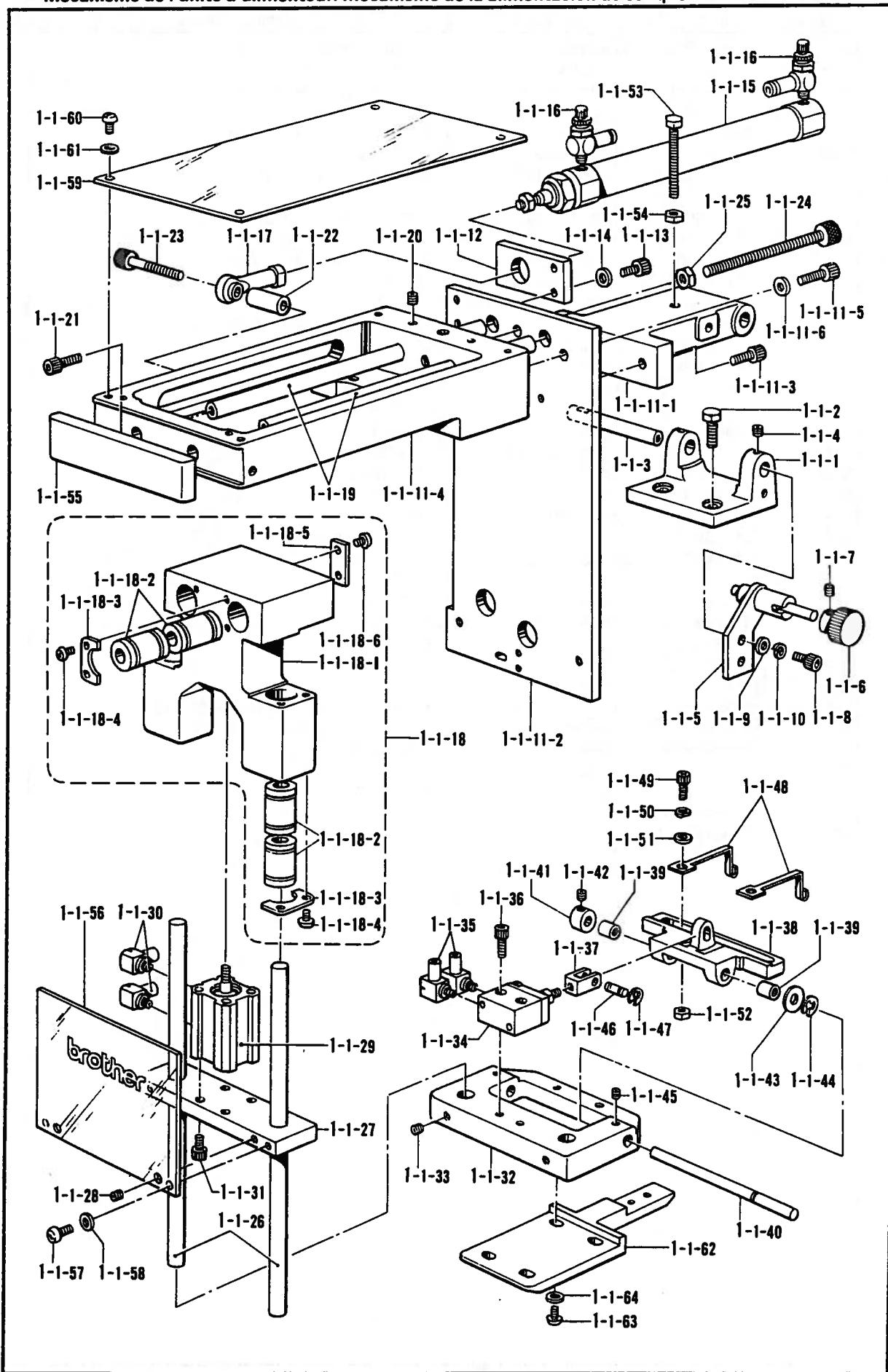
S1. フィーターユニット関係 / Feeder unite mechanism / Transport-Kupplung /
