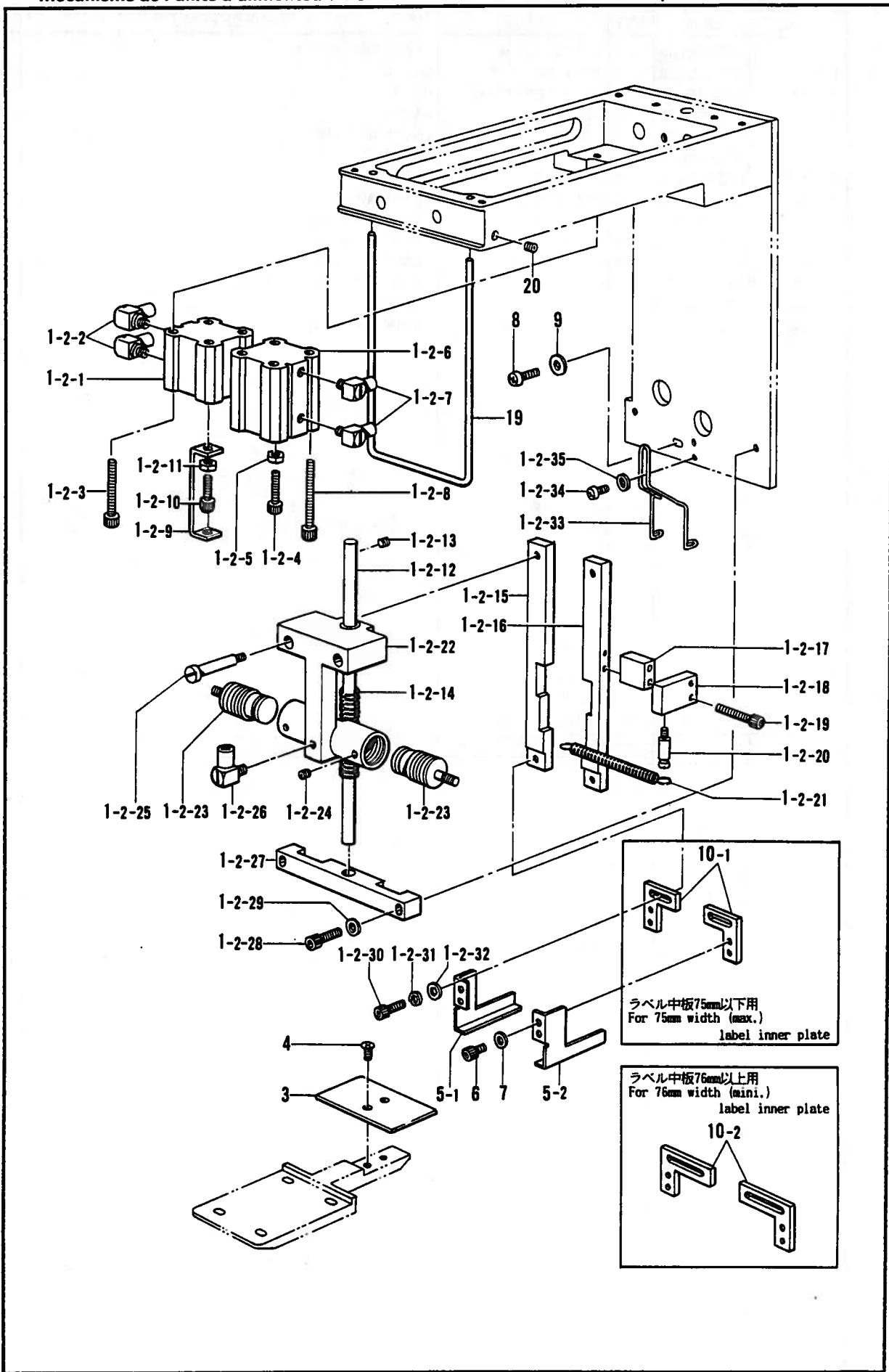
S2. フィーダーユニット関係 /Feeder unite mechanism/Transport-Kupplung/
