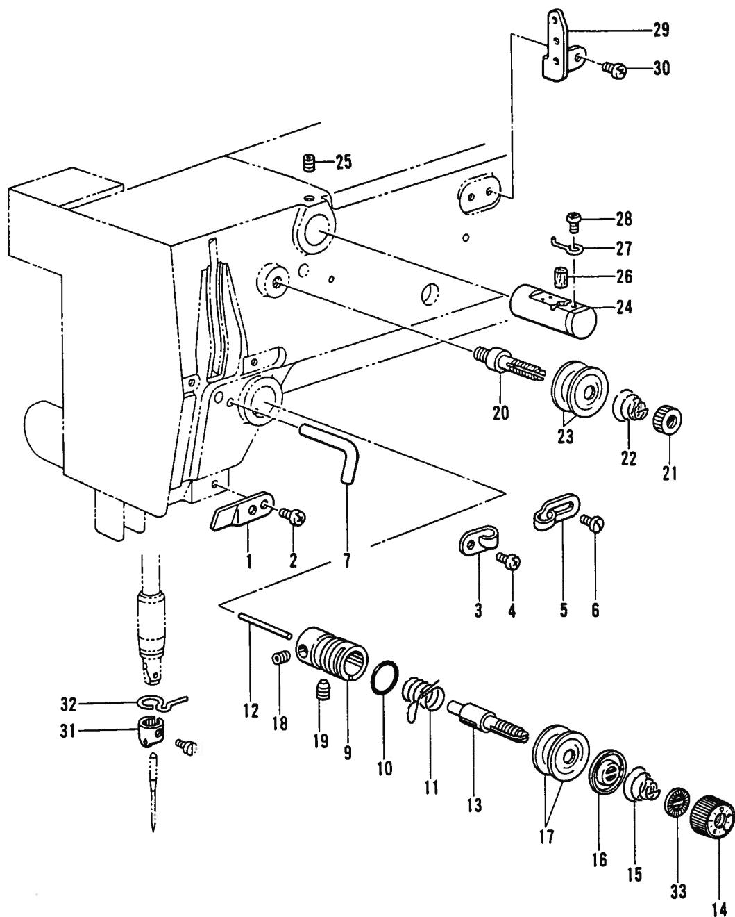
H. 糸通し関係 / Threading mechanism / Fadenführungs vorrichtung /
