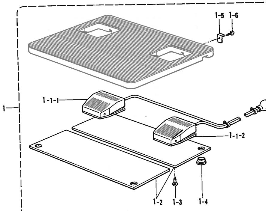
Y. 付属装置関係 /Programmer device/Programmvorrichtung/
