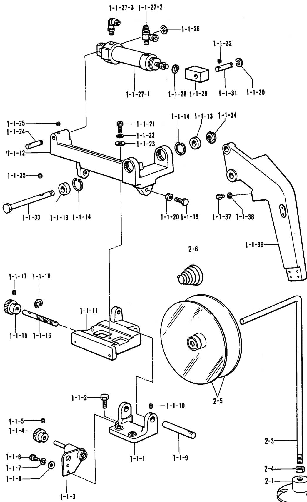
R1. フィーダーユニット関係 / Feeder unite mechanism / Transport-Kupplung /
