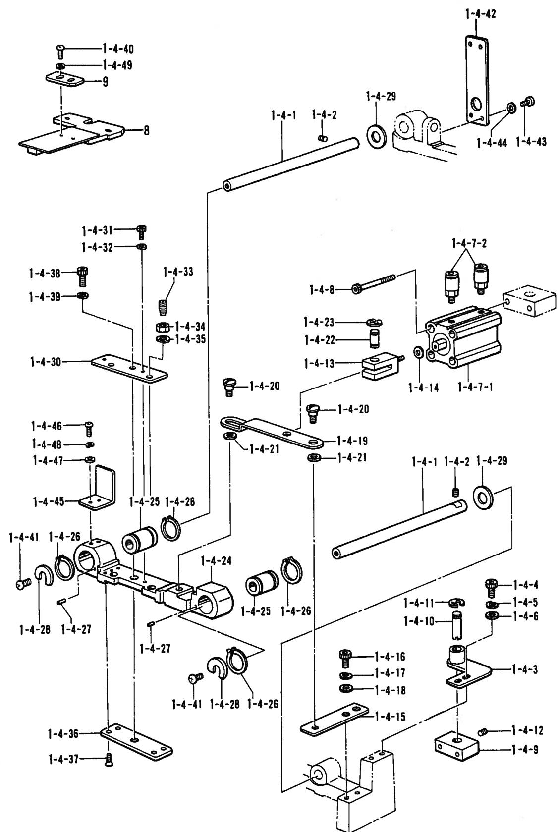
R4. フィーダーユニット関係 / Feeder unite mechanism / Transport-Kupplung /
