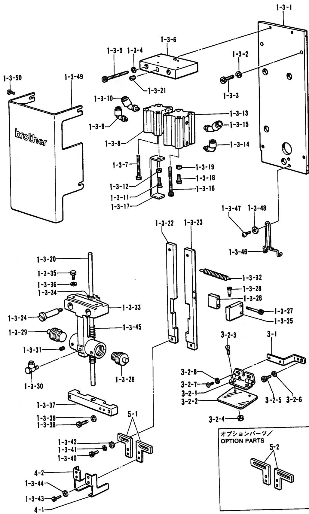
R3. フィーダー単位関係 / Feeder unit mechanism / Transport-Kupplung /
