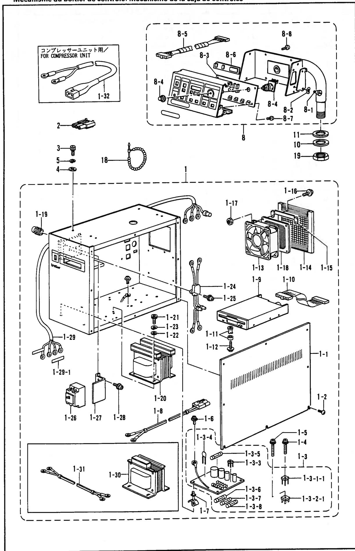
R. コントロールボックス関係 / Control box mechanism / Schaltkasten /
