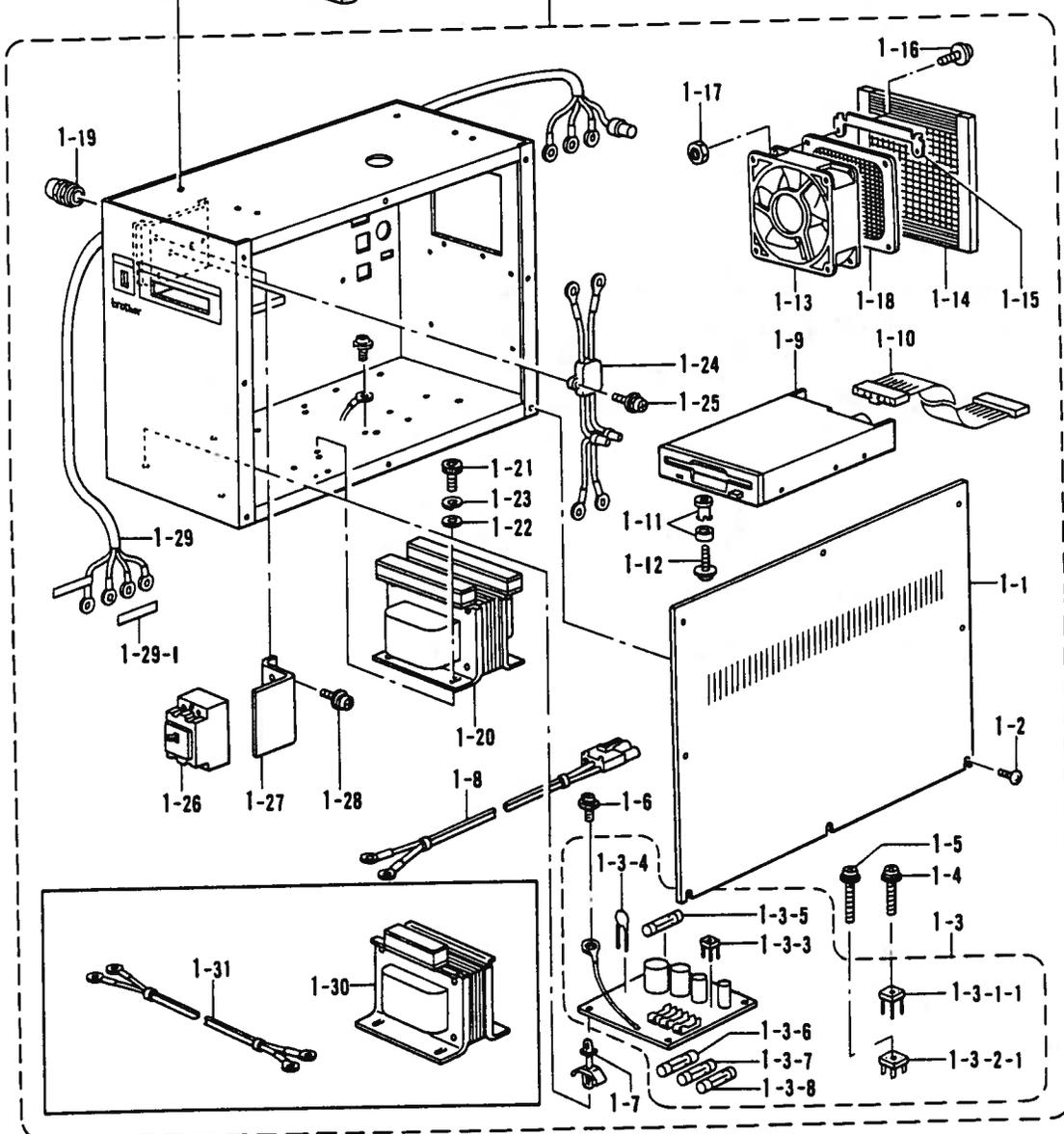
T. コントロールボックス関係 / Control box mechanism / Schaltkasten /
