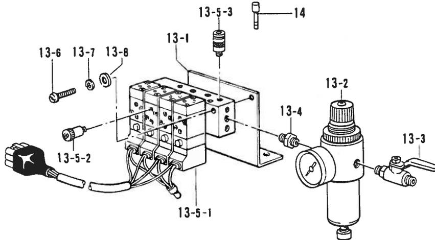
U. 空圧関係 / Air pressure mechanism / Luftdruck /
