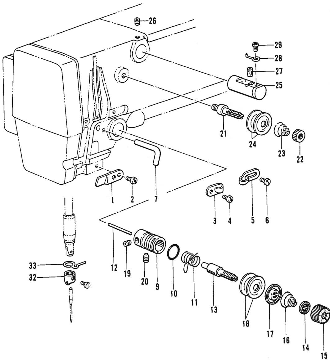
J. 糸通シ関係 / Threading mechanism / Fadenführungsrichtung /
