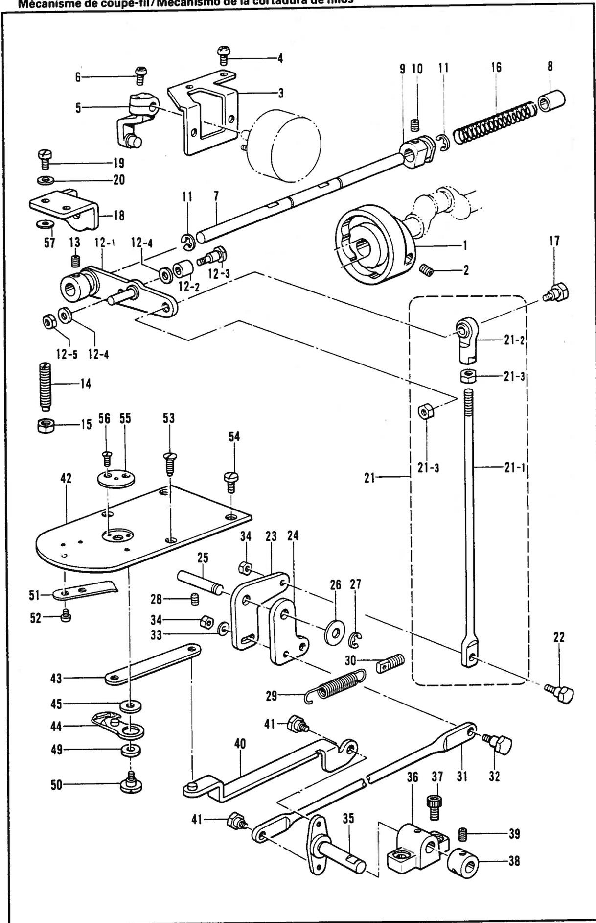
L. 糸切り関係/Thread trimmer mechanism/Fadenabschneidevorrichtung/
