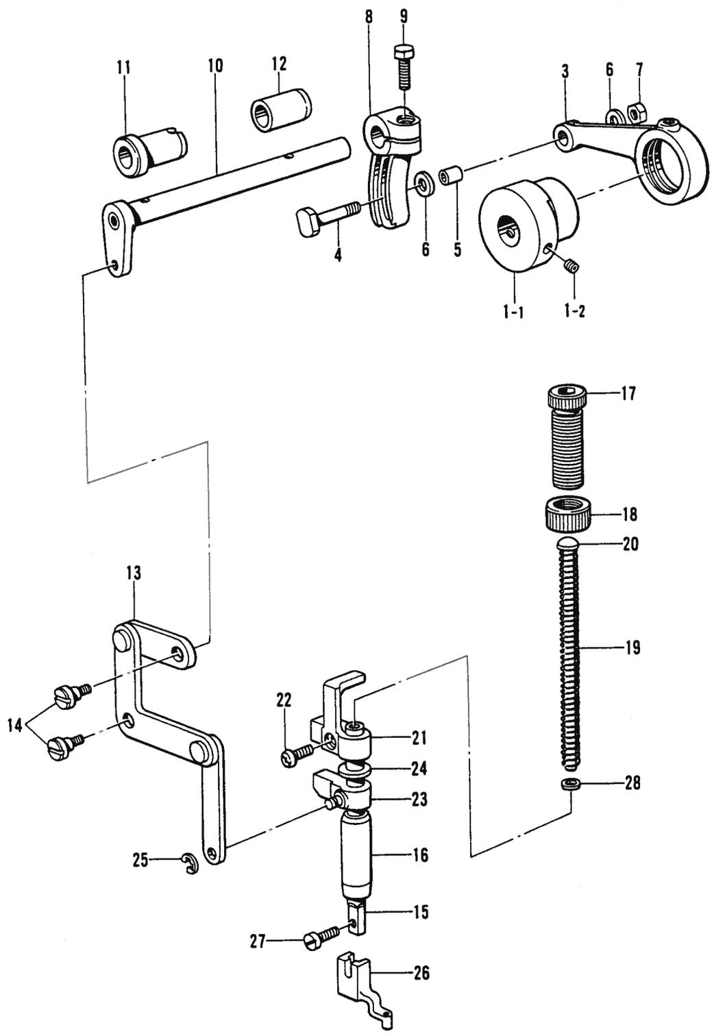
E. 押工上ケ関係/Work clamp lifter mechanism/Stoffhalterhebevorrichtung/
