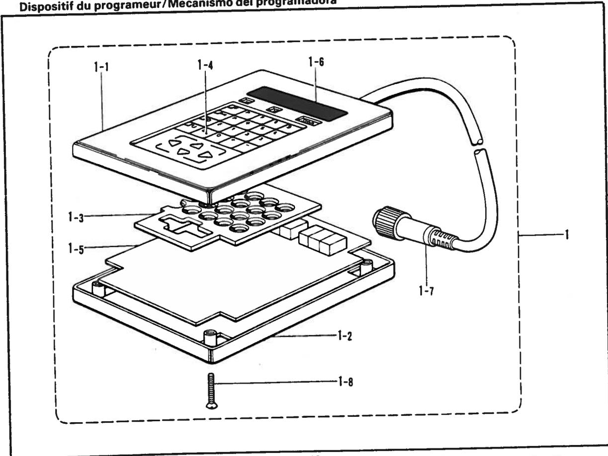
W. プリント基板関係 / Printed circuit board mechanism / Leiterplatten /
