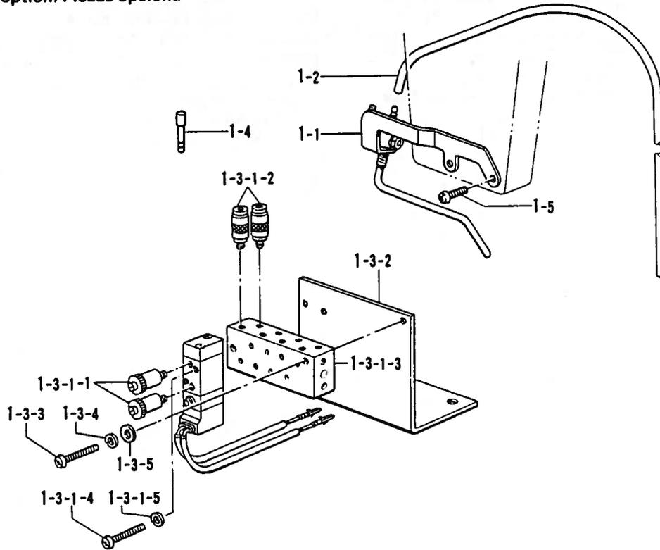
Y. 針冷却装置 / Needle cooler / Nadelkühlungsvorrichtung /
