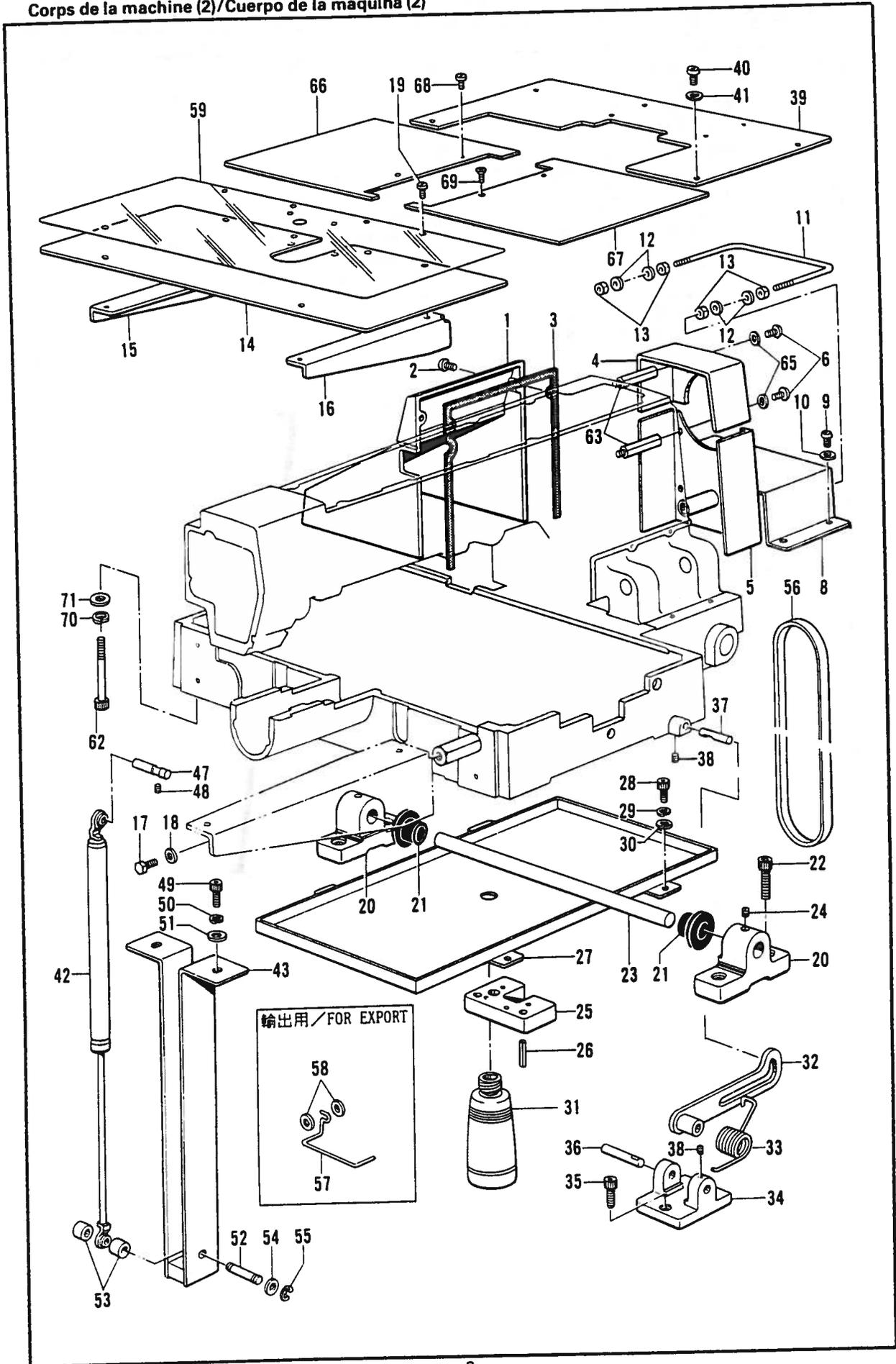
B. 主体関係 (2) / Machine body (2) / Maschinengehäuse (2) /
