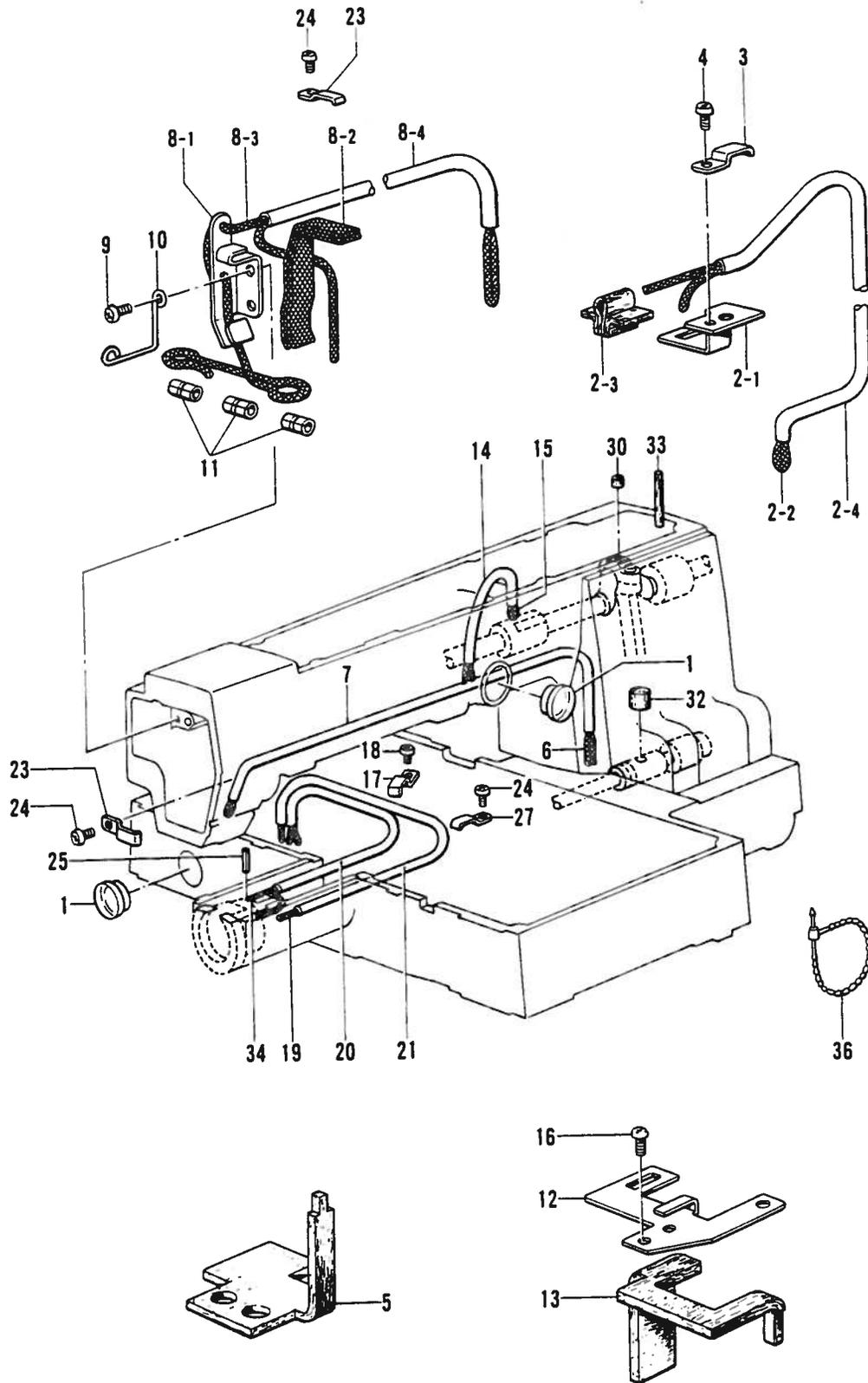
H. 給油潤滑関係/Lubrication/Schmierung/
