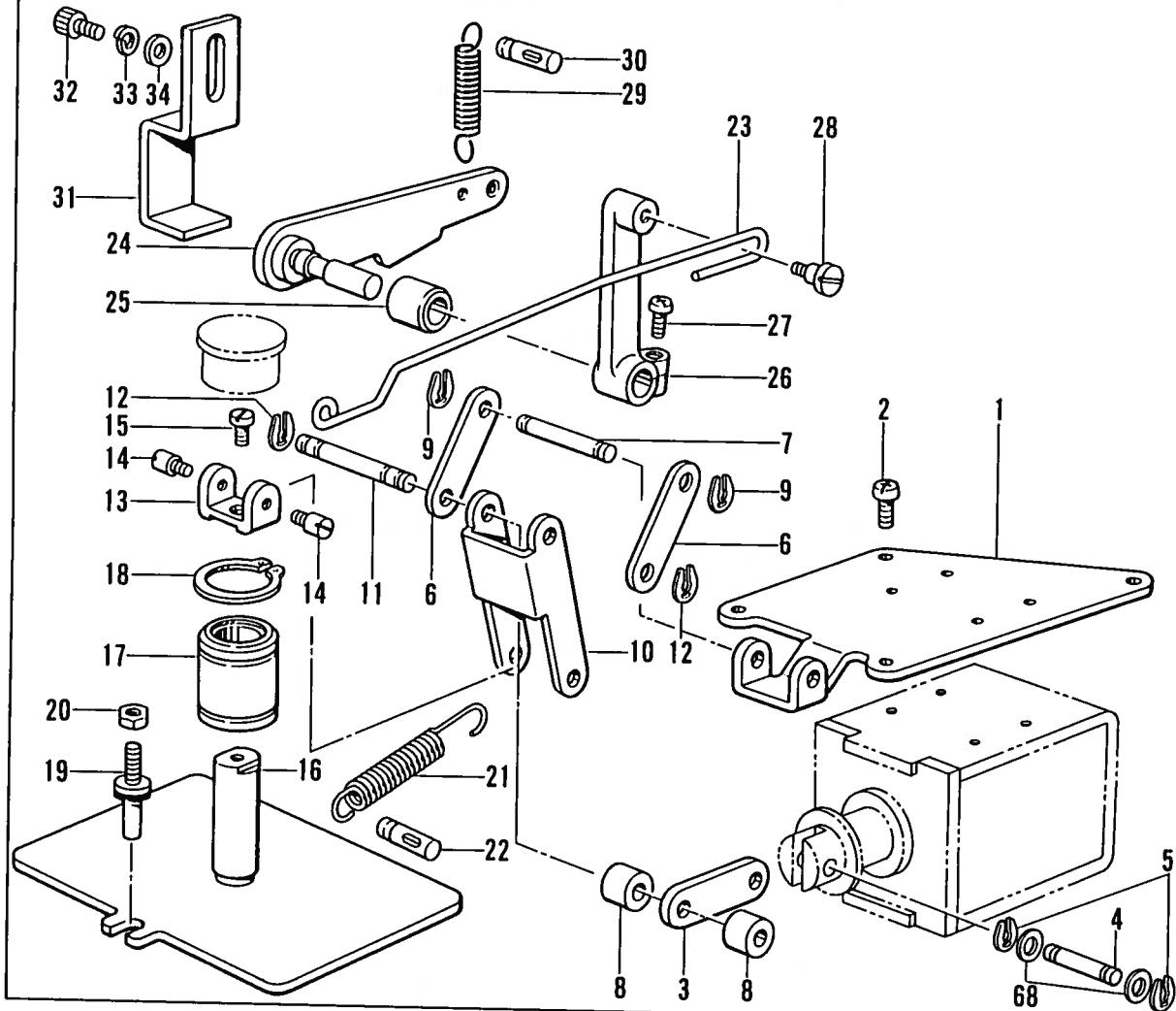
D. 押工上ヶ関係/Work Clamp Lifter mechanism/Stoffhalterhebervorrichtung/
