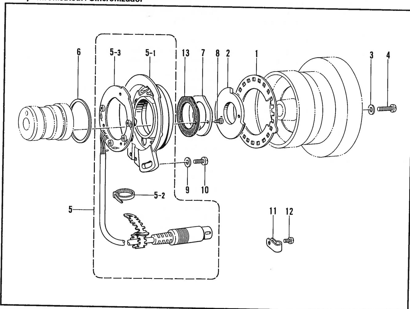
L. ワイパー関係 / Thread wiper mechanism / Fadenwischvorrichtung /
