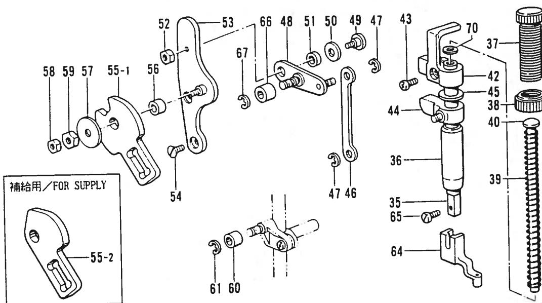
電磁、スナップ・ホックツケヨウ / SOLENOID, SNAP AND HOOK TYPE
