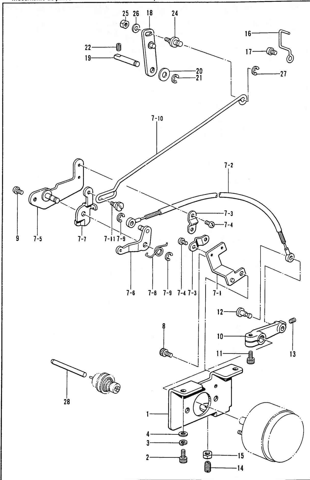
P. 糸締メ関係/Thread nipper mechanism/Fadenspannvorrichtung/
