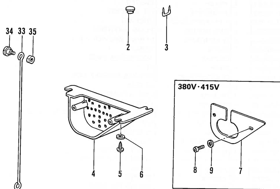
T. 踏板関係 / Foot switch pedal mechanism / Fußbetätigung /
