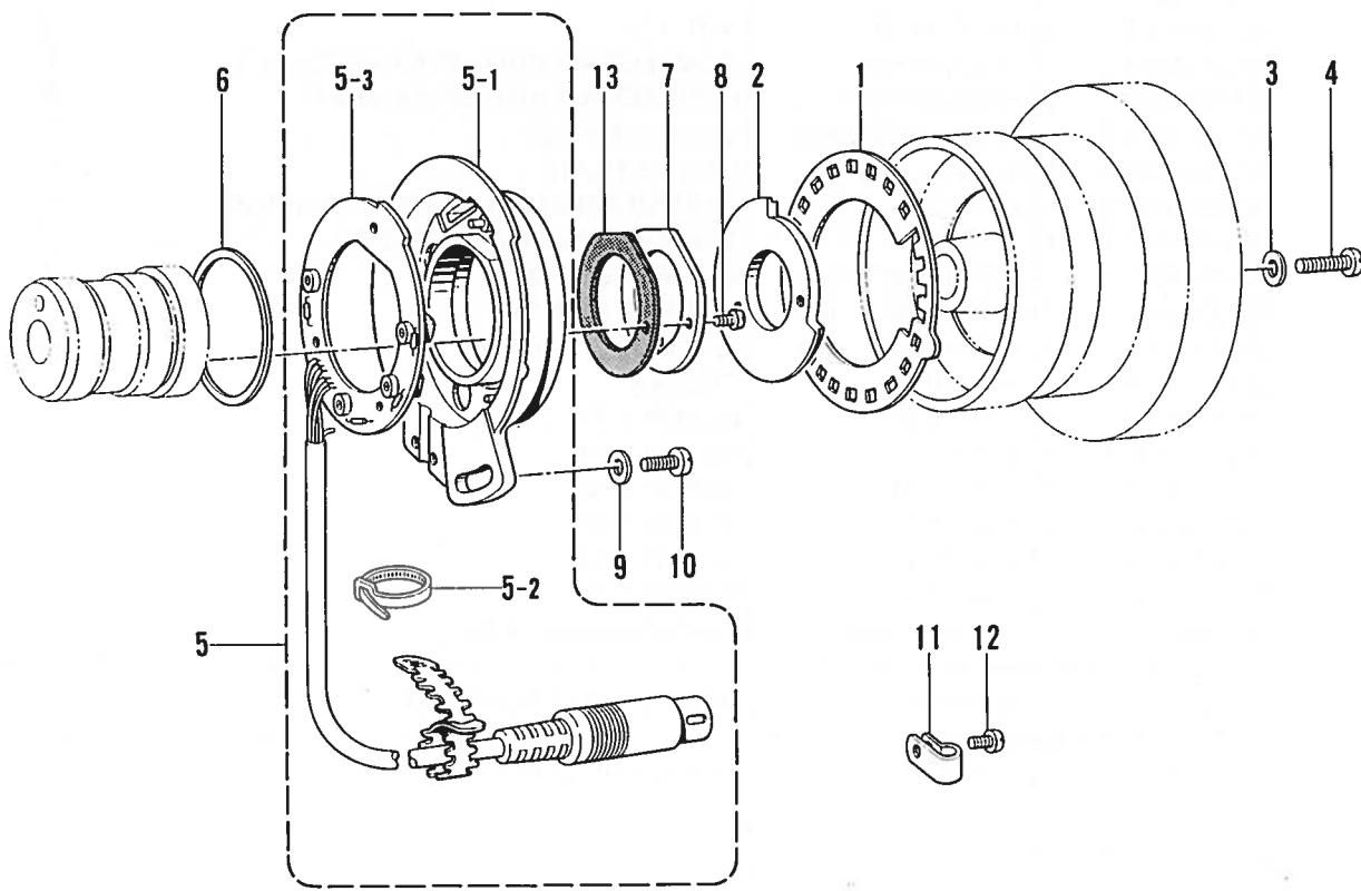
L. ワイパー関係 / Thread wiper mechanism / Fadenwischvorrichtung /
