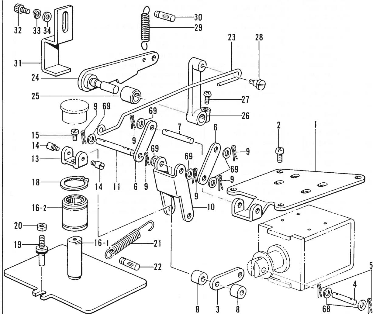
D. 押工上部関係 / Work Clamp Lifter mechanism / Stoffhalterhebervorrichtung /
