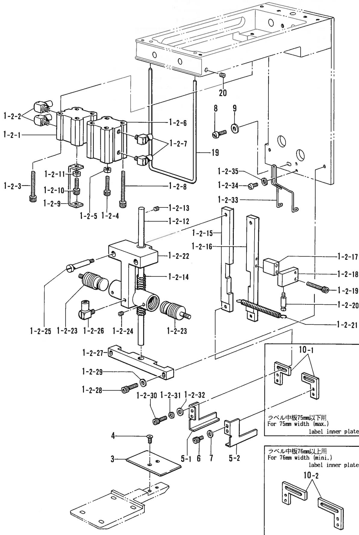
R. フィーダーユニット関係/Feeder unite mechanism/Transport-Kupplung/
