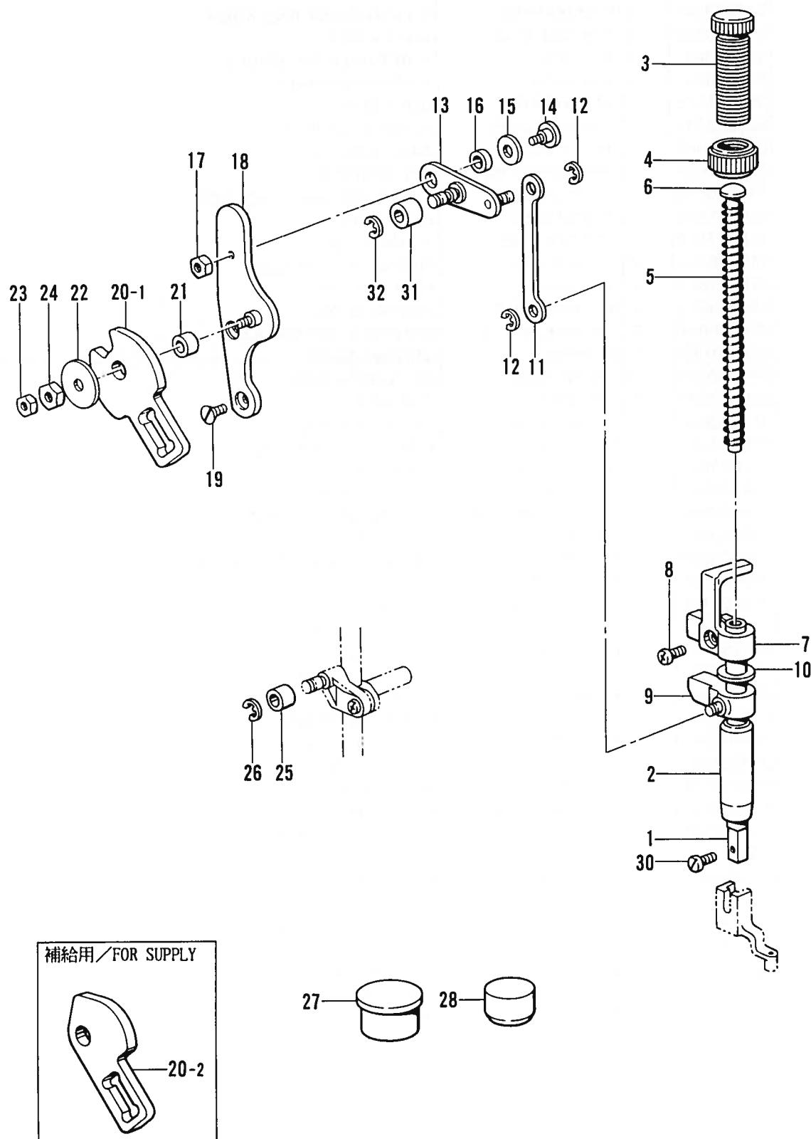
D. 押工上げ関係/Work Clamp Lifter mechanism/Stoffhalterhebervorrichtung/
