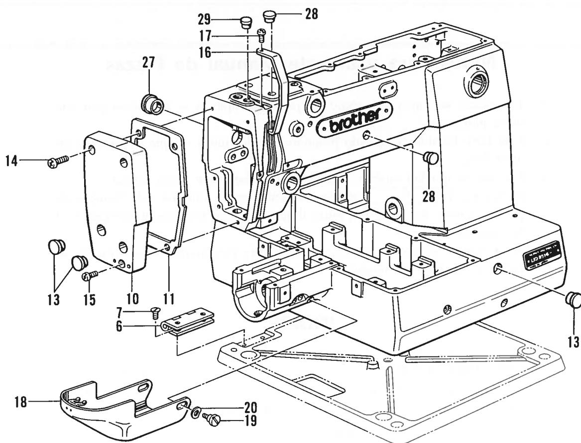
A1. 主体関係 / Machine body / Maschinengehäuse /
