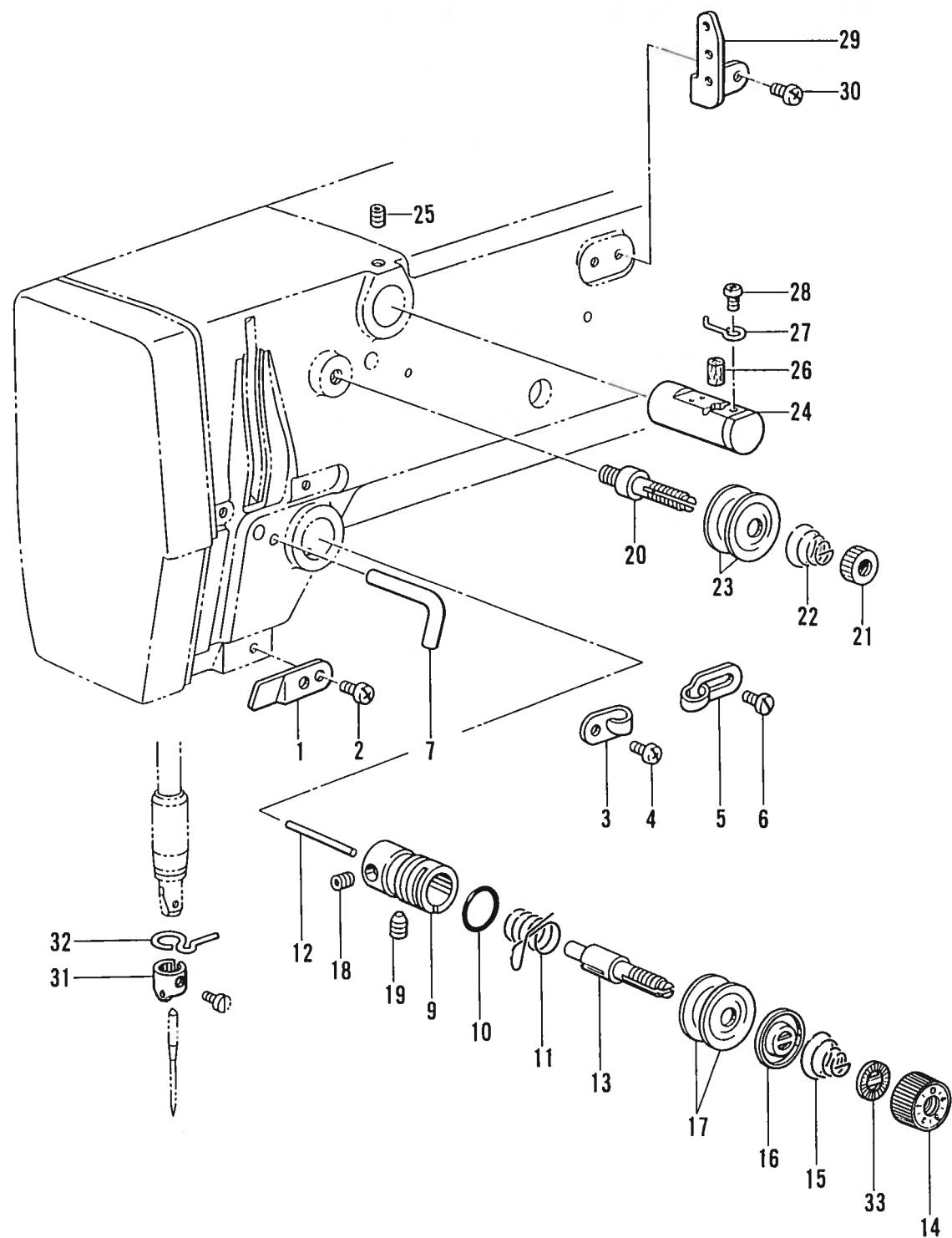
H. 糸通シ関係 / Threading mechanism / Fadenführungs vorrichtung /
