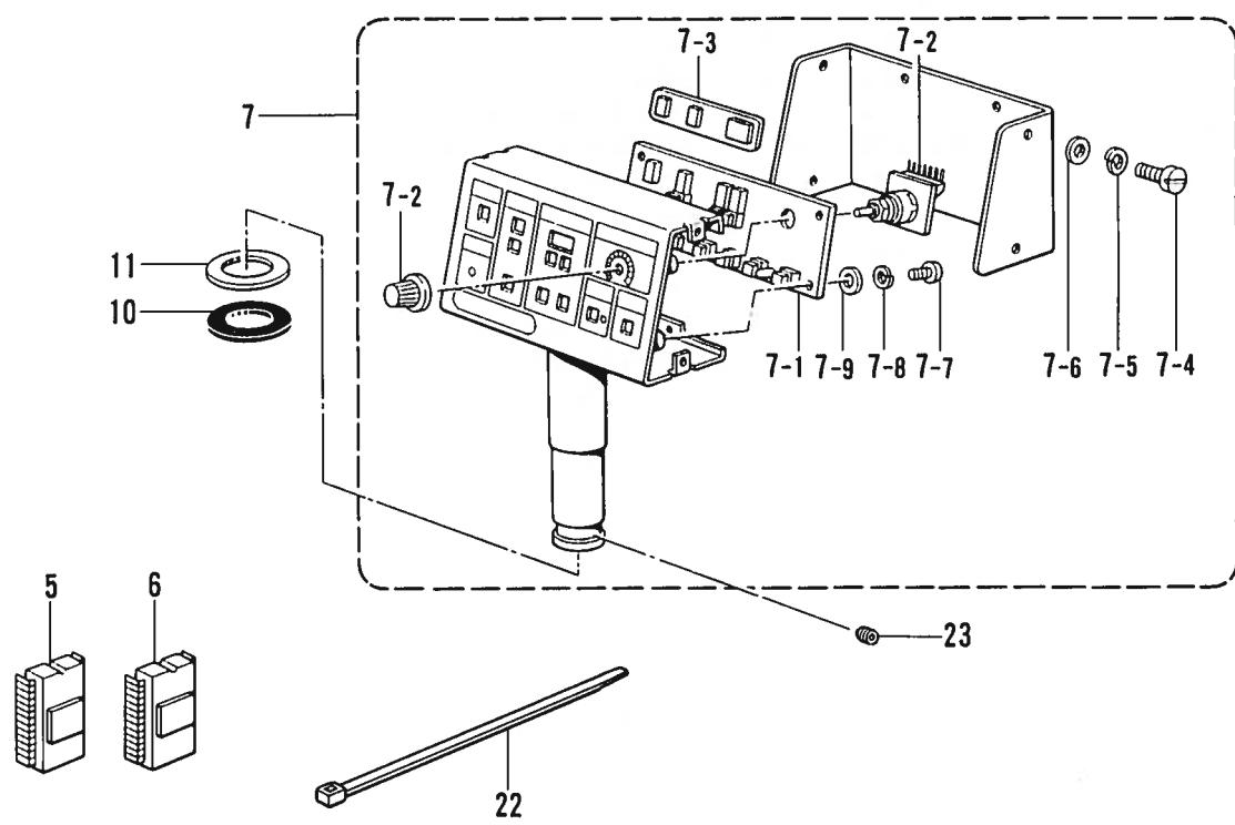
S. コントロールボックス関係 / Control box mechanism / Schaltkasten /
