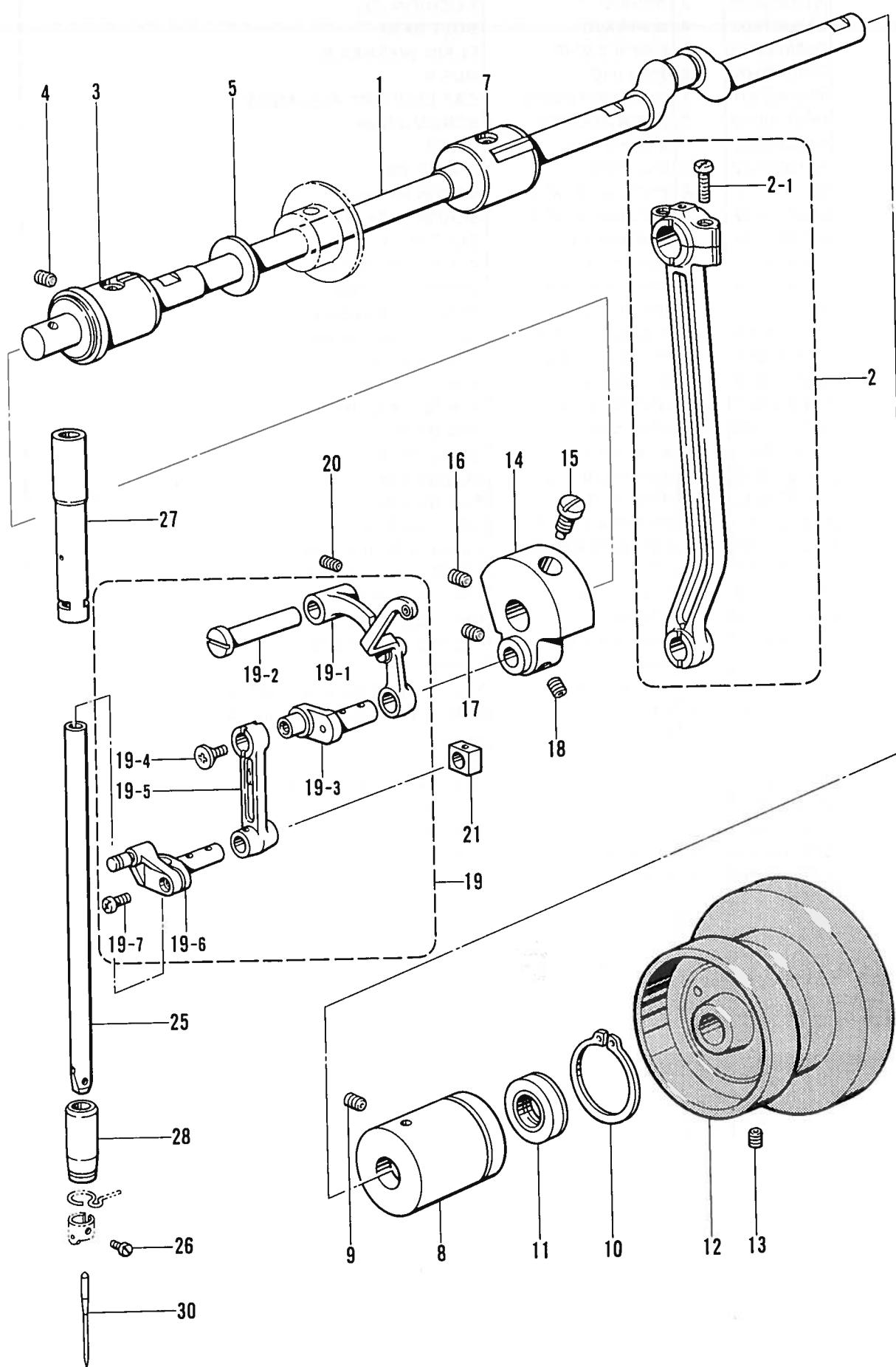
B. 上軸針棒関係 / Upper shaft and needle bar mechanism / Obere Welle und Nadelstangenvorrichtung / Mécanisme de arbre supérieur et barre à aiguille / Mecanismo del eje superior y la barra de aguja
