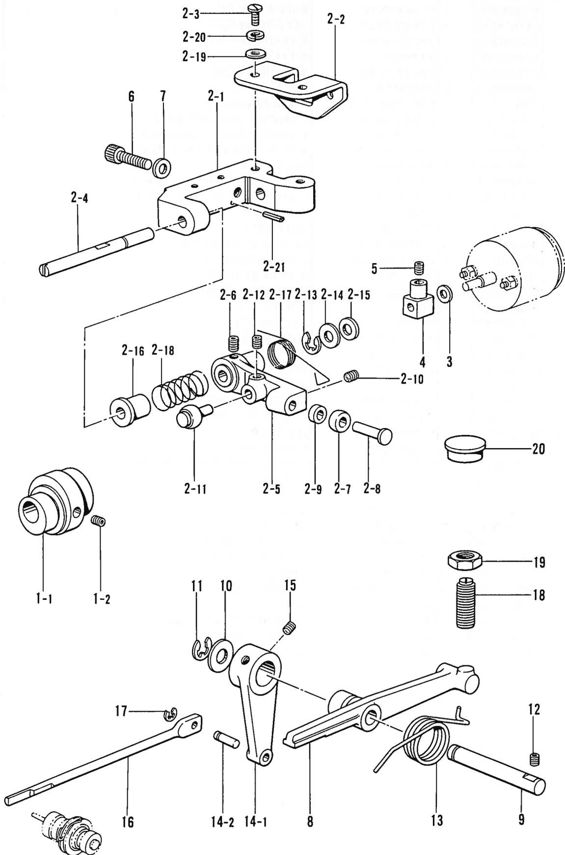
D. 押工上げ関係/Work clamp lifter mechanism/Stoffhalterhebevorrichtung/
