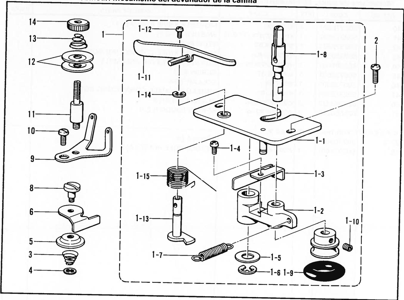
L. ワイパー関係/Thread wiper mechanism/Fadenwischvorrichtung/
