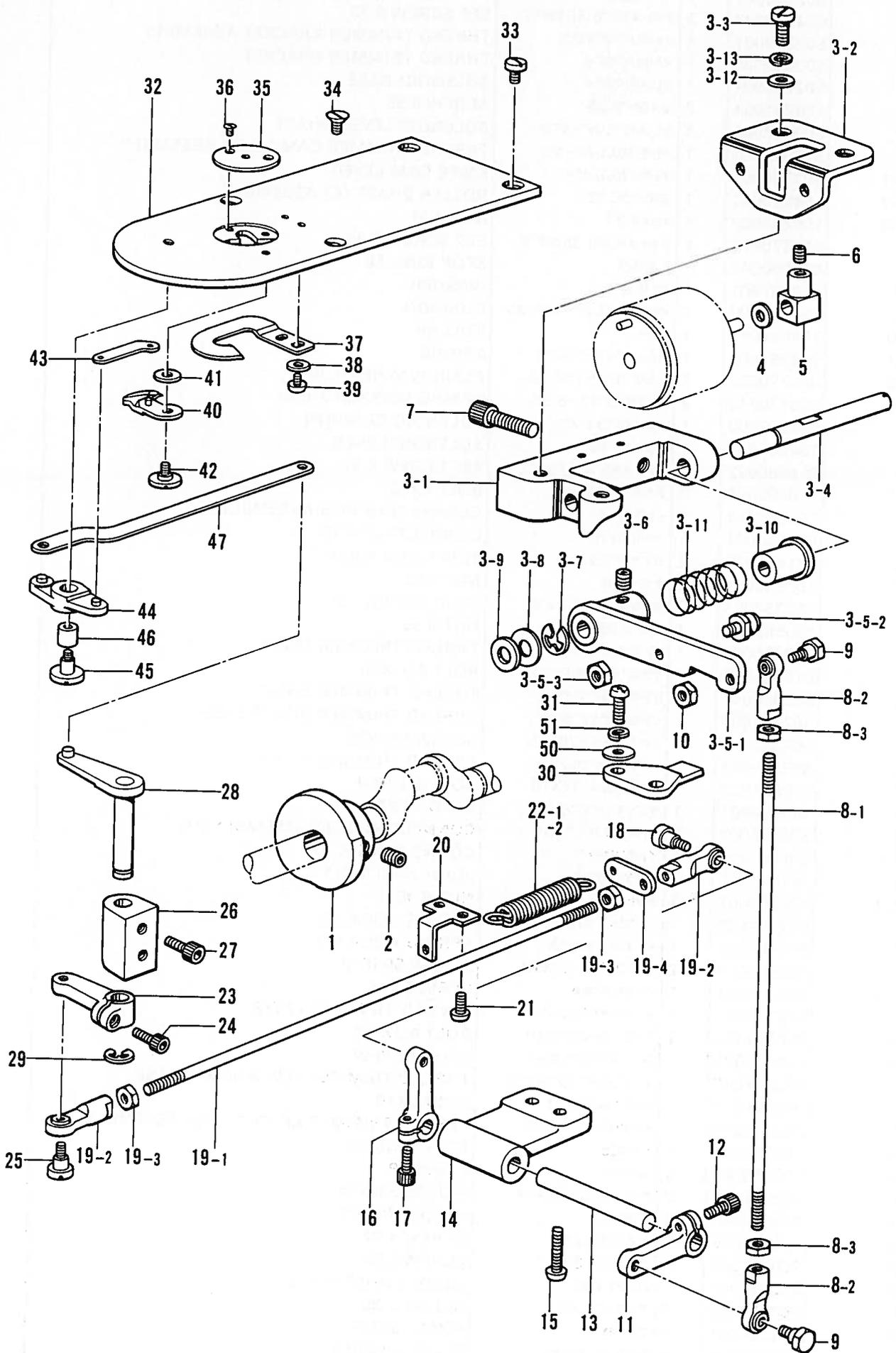
J. 糸切り関係 / Thread trimmer mechanism / Fadenabschneidevorrichtung /
