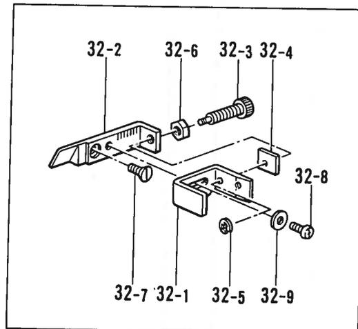
H. 糸通シ関係/Threading mechanism/FadenführungsVorrichtung/
