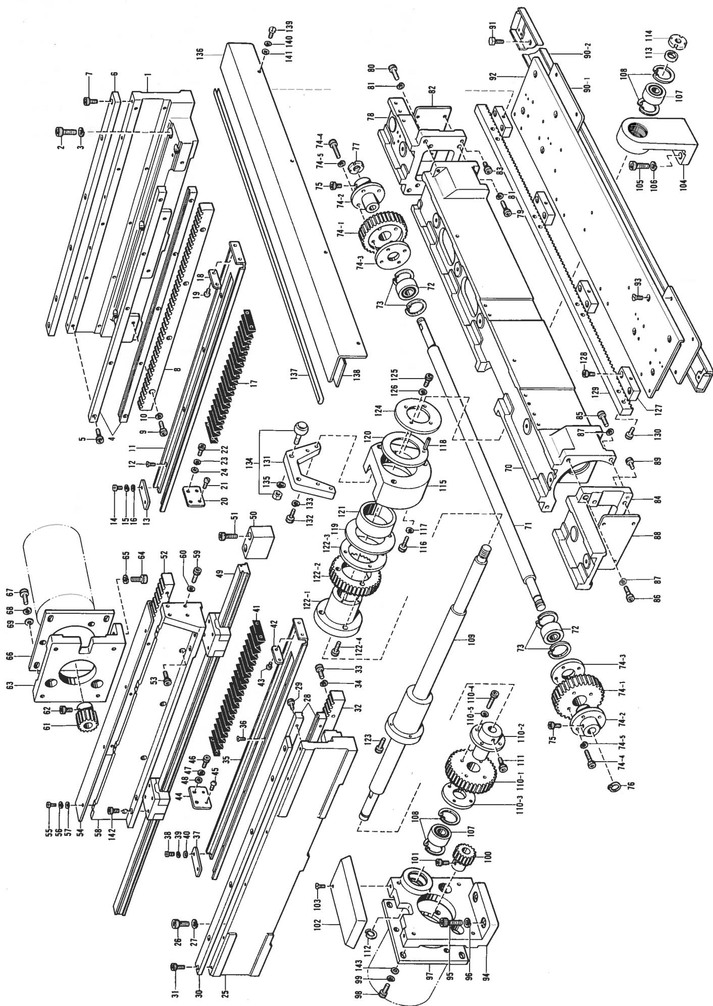
S. 送り案内関係 Feed guide mechanism / Transportführung / Mécanisme du guide de l'entraînement /
