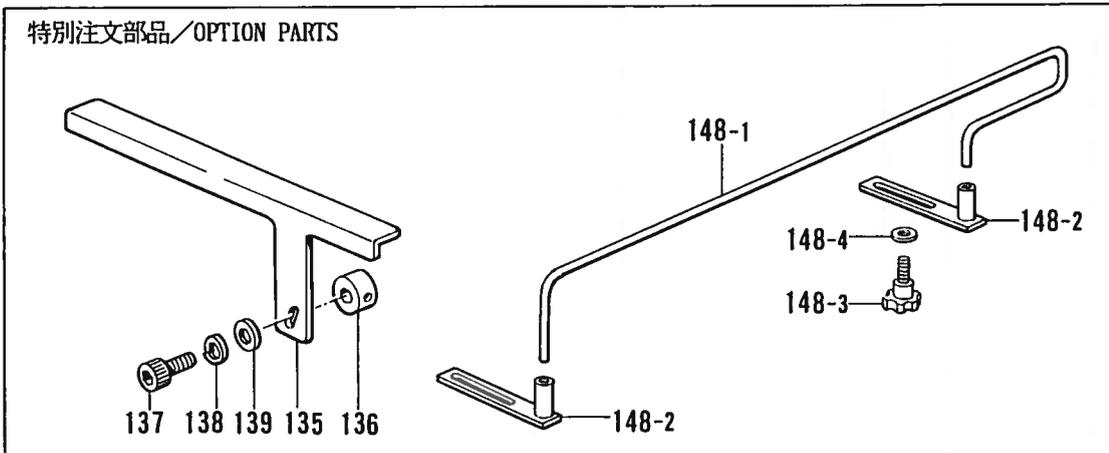
E1. 布制御関係 / Cloth control system mechanism / Stoffführungsvorrichtung /
