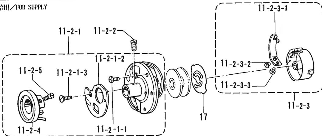
N. カマ関係 / Rotary hook mechanism / Greifervorrichtung /
