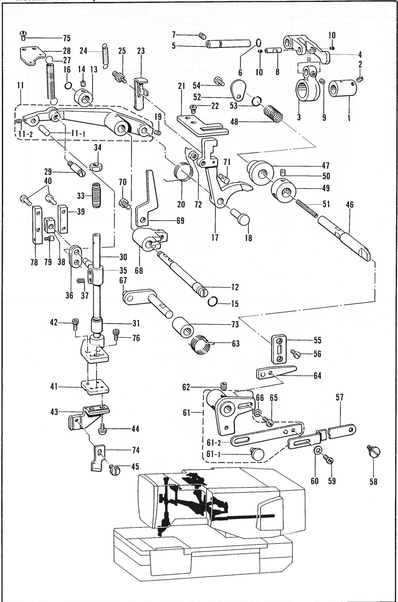
M. カッター関係 /Cutter mechanism/Abschneidevorrichtung/
