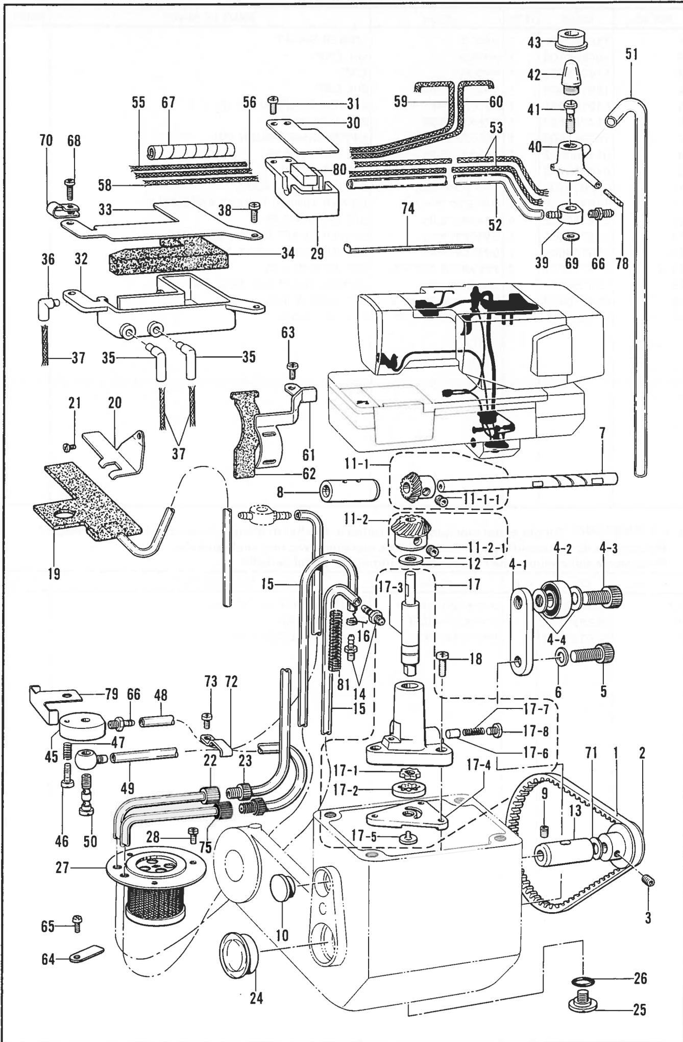
R. 給油潤滑関係 / Lubrication / Schmierung /
