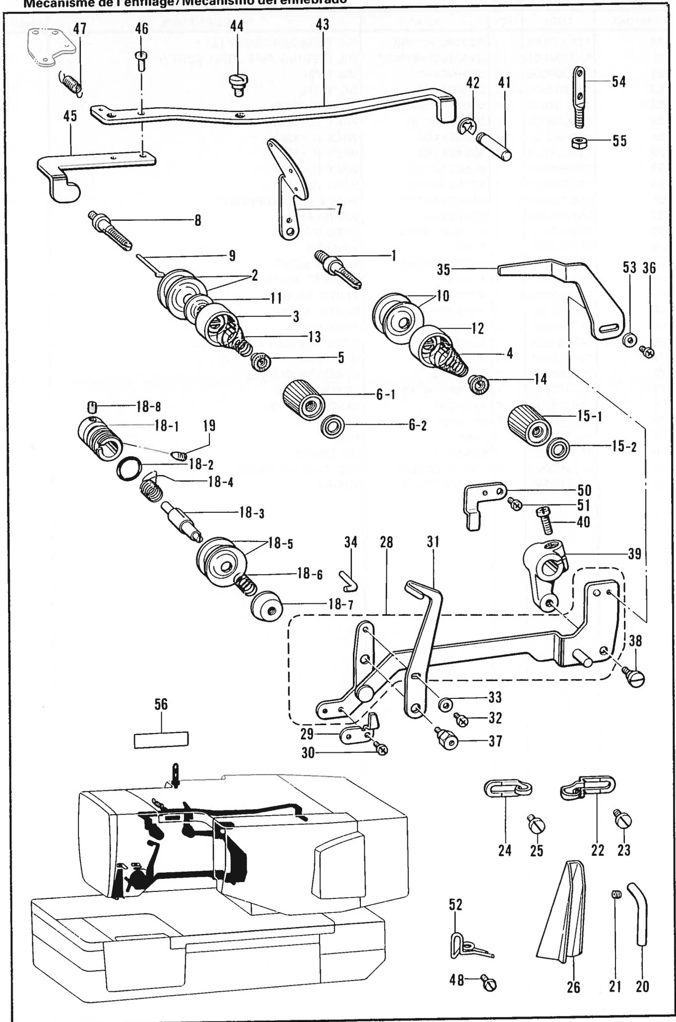
S. 糸通シ関係 / Threading mechanism / Fadenführungsrichtung /
