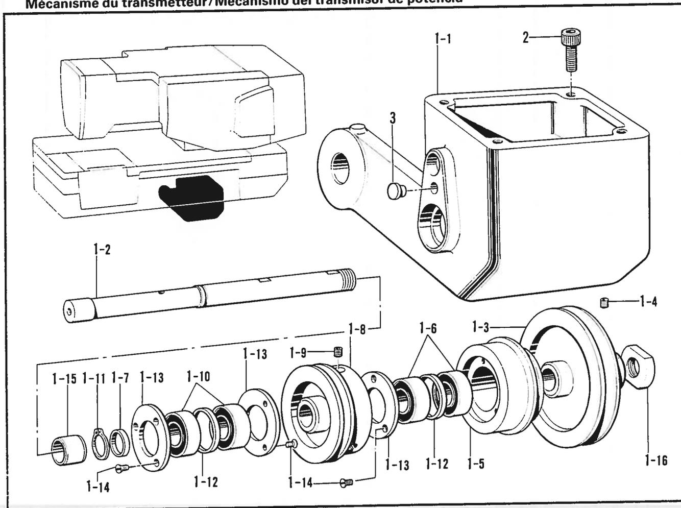
T. 糸巻装置 / Bobbin winder / Spuler /
