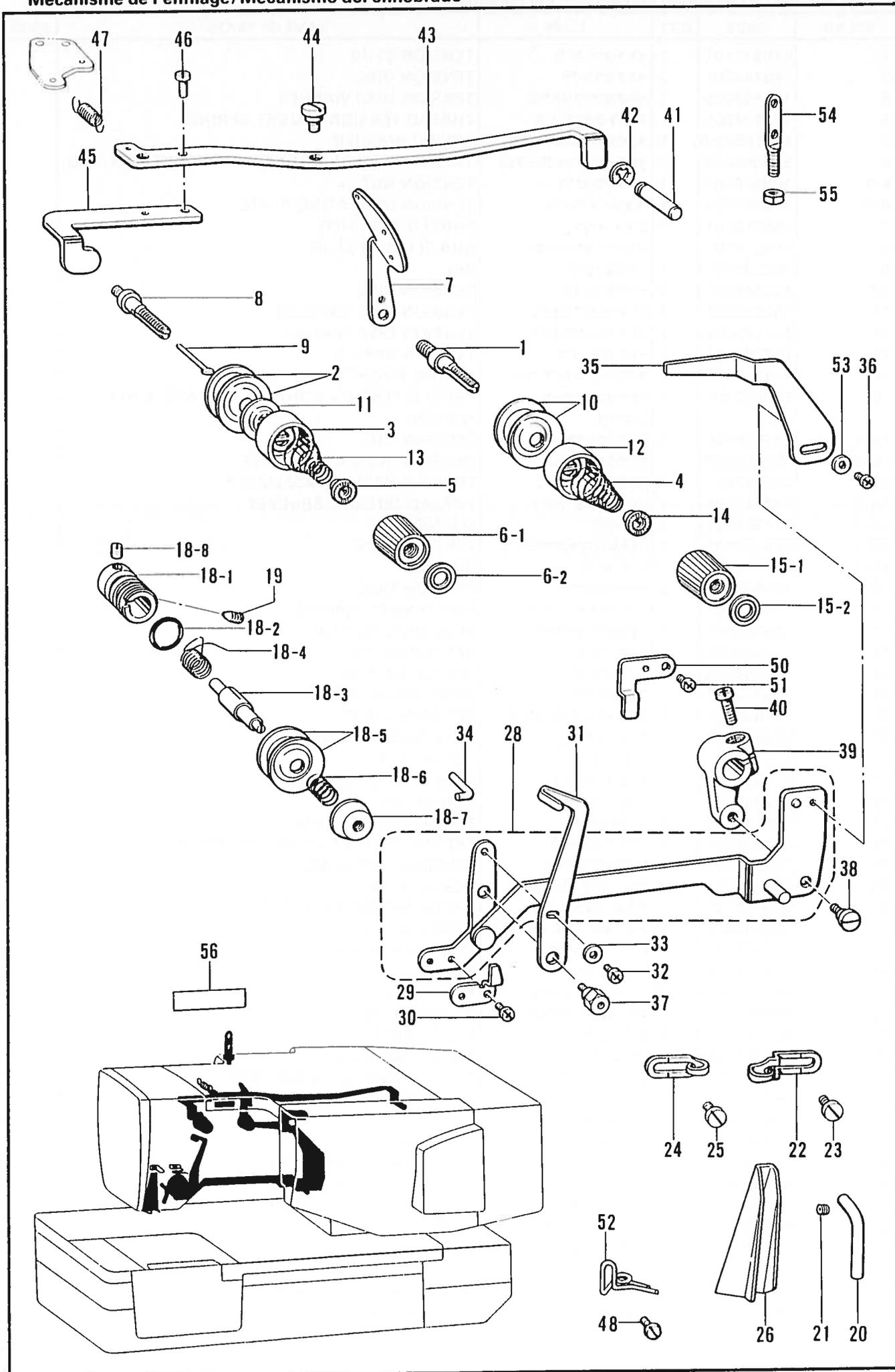
S. 糸通シ関係 / Threading mechanism / Fadenführungsrichtung /
