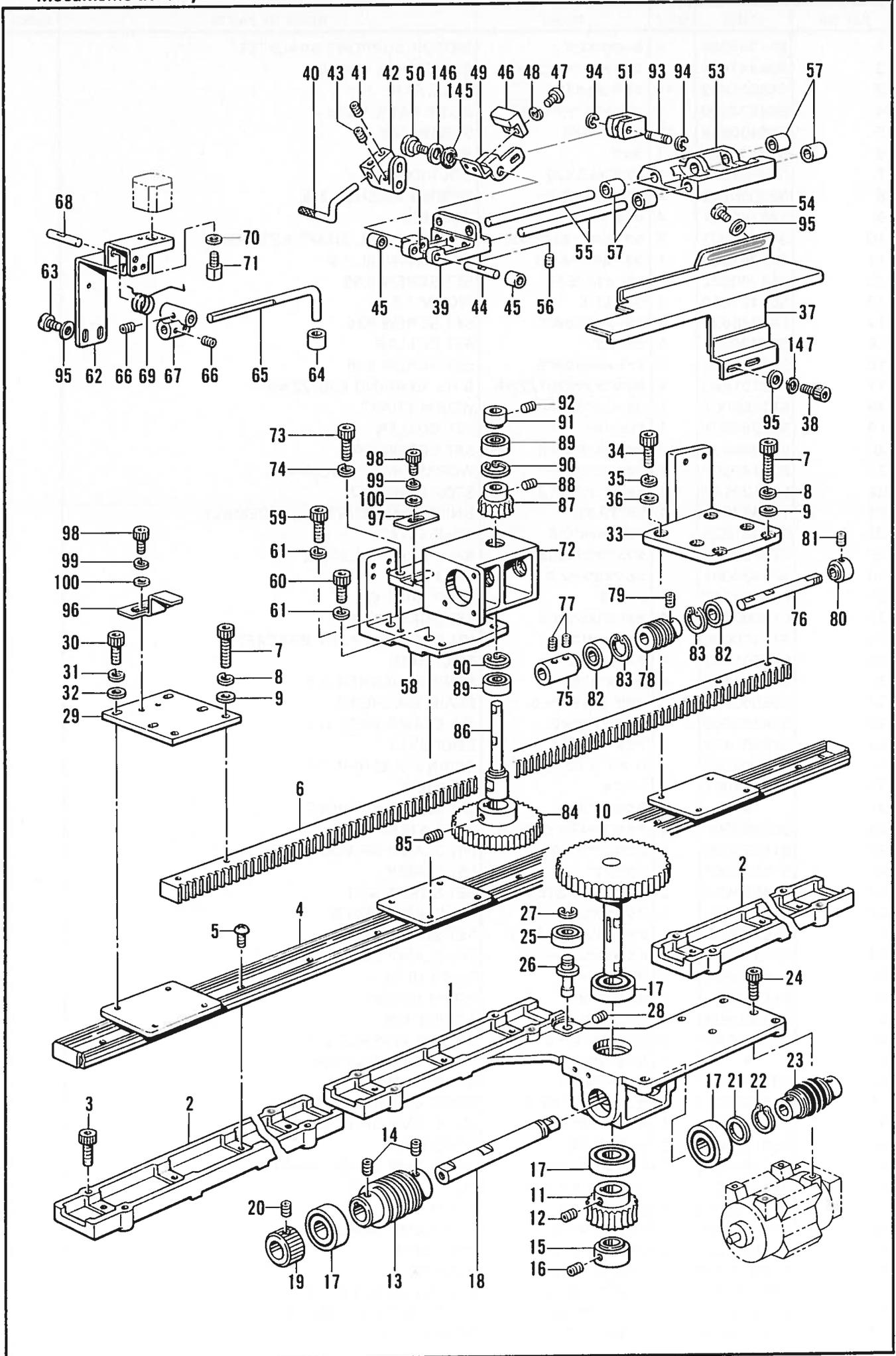
E1. 布制御関係 / Cloth control system mechanism / Stoffführungsvorrichtung /
