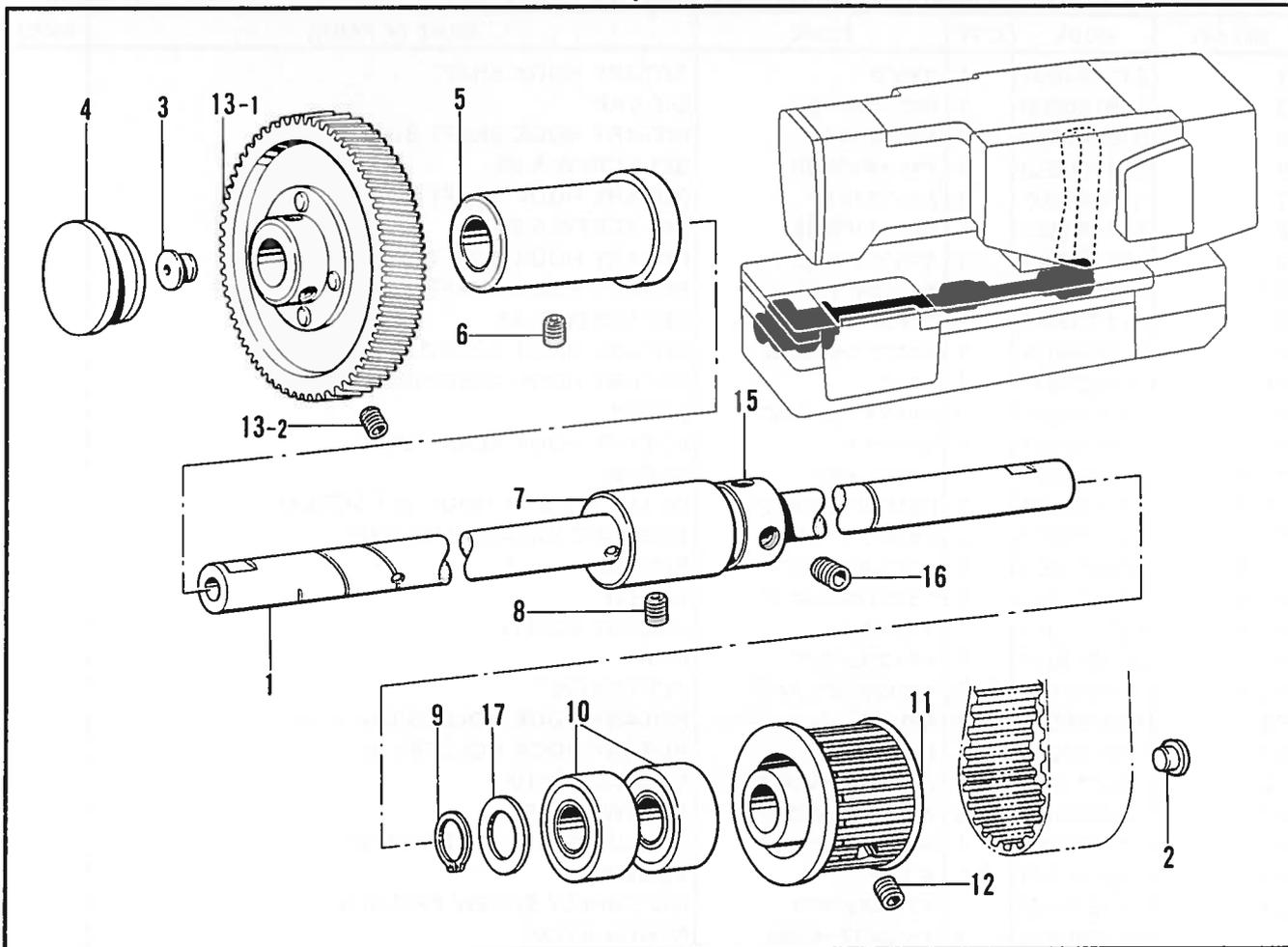
Q. OP 頭部組付関係 / Single pedal mechanism installed in the head / Maschineoberteil Mit Einem Pedal /
