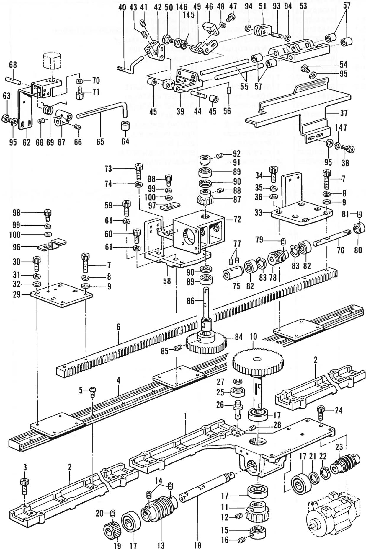
E1. 布制御関係 / Cloth control system mechanism / Stoffführungsrichtung /
