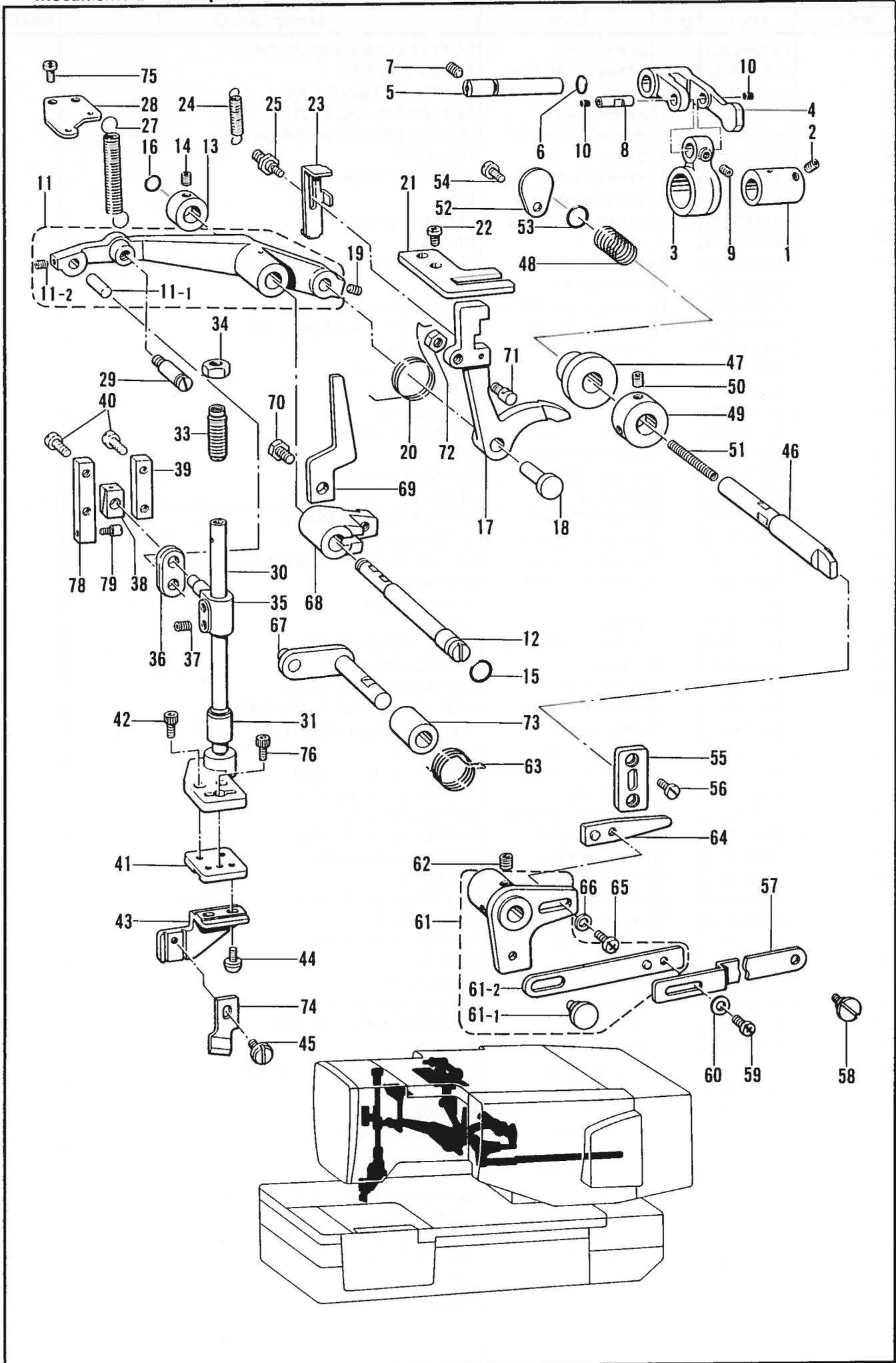
M. カッター関係 /Cutter mechanism/Abschneidevorrichtung/
