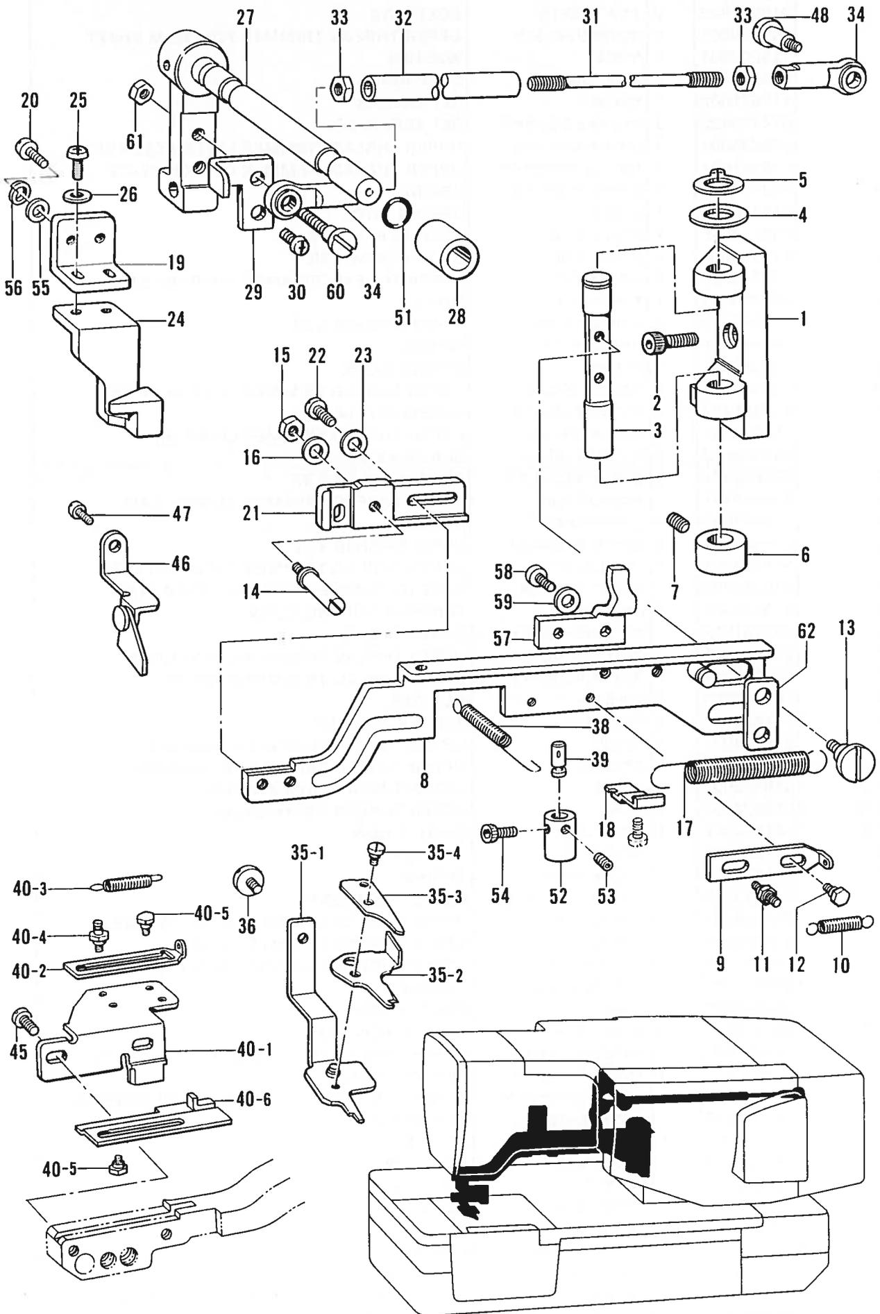
V. 上糸切り関係/Upper thread trimmer mechanism/Oberer Fadenabschneider/
