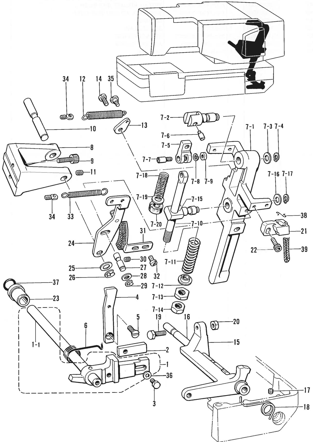
E. 停止関係 / Clutch mechanism / Kupplungsvorrichtung /
