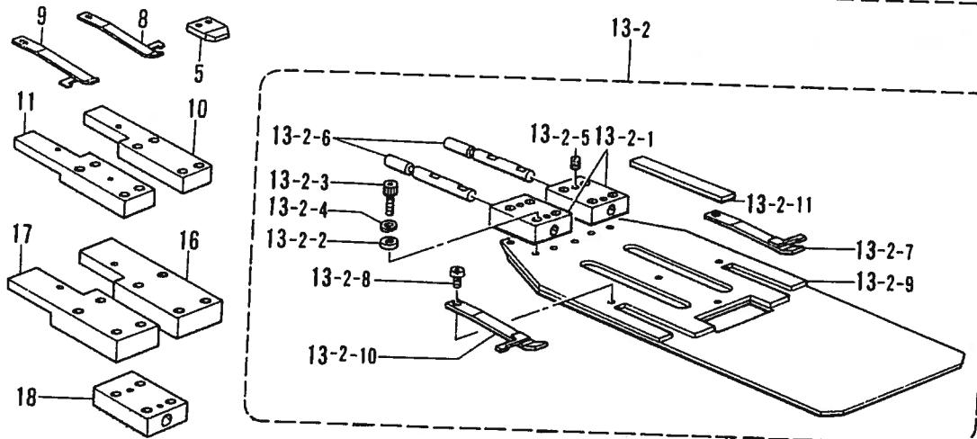
S. 折曲ゲ関係 (特別注文部品)/Folding margin mechanism (Option parts)/Faltungsvorrichtung (Sonderzubehör)/
