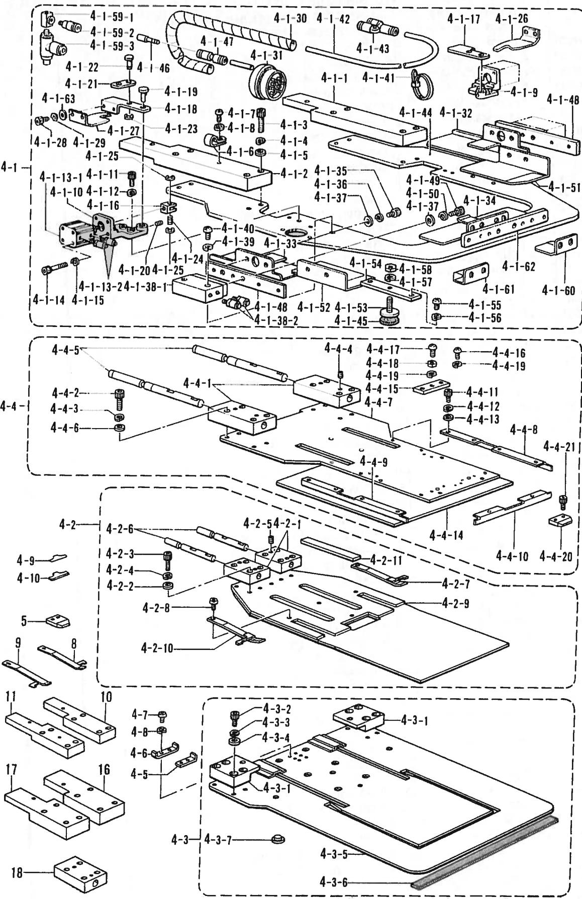
S. 折曲部関係 (特別注文部品)/Folding margin mechanism (Option parts)/Faltungsvorrichtung (Sonderzubehör)/
