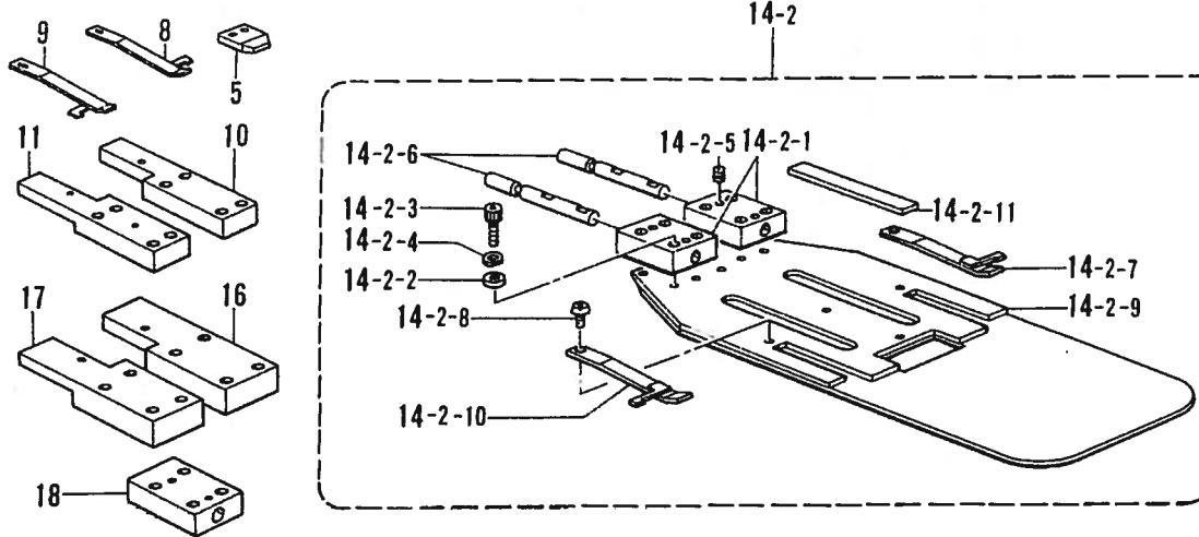
S. 折曲部関係 (特別注文部品)/Folding margin mechanism (Option parts)/Faltungsvorrichtung (Sonderzubehör)/
