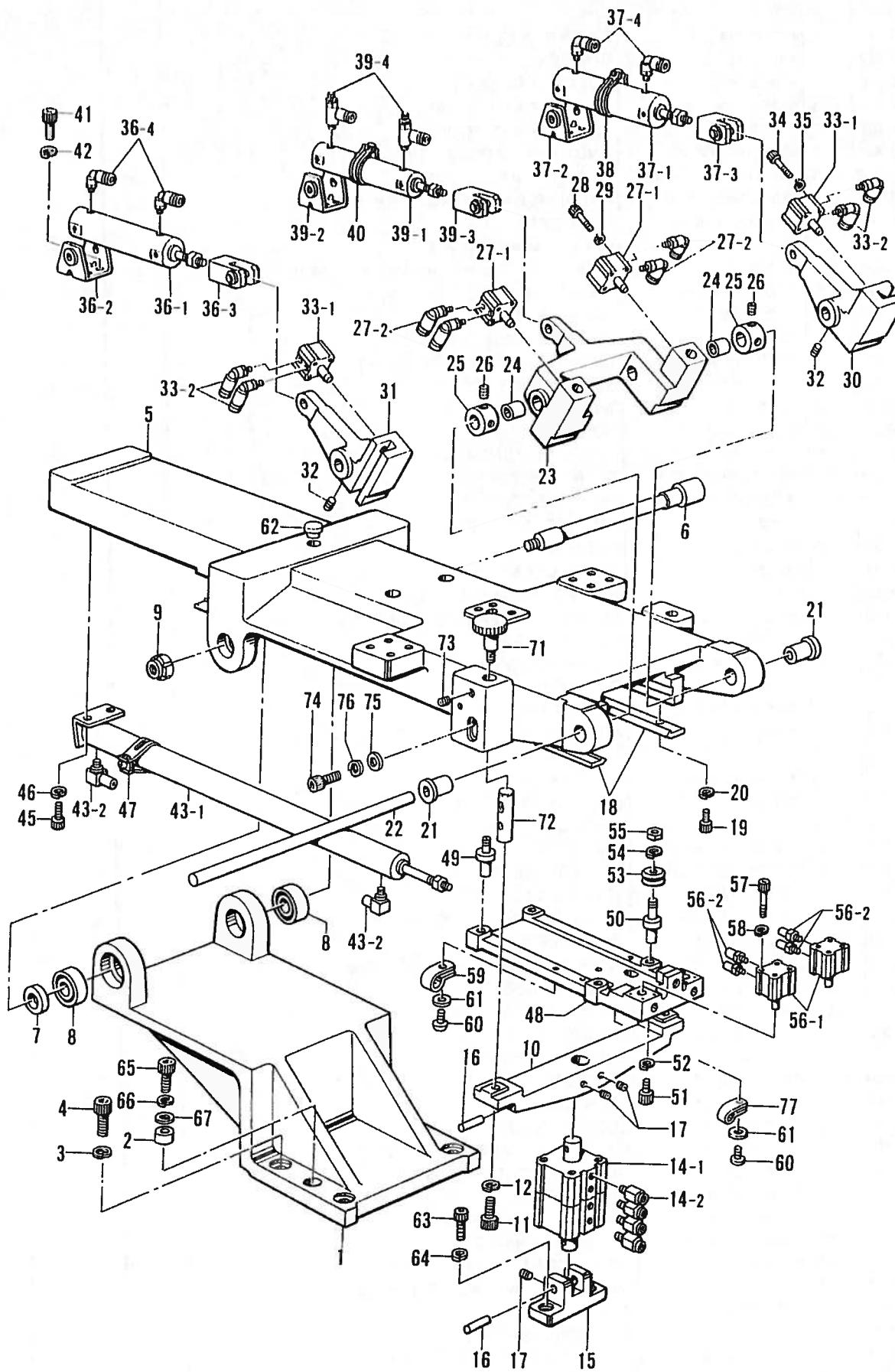
T. 折脚ケ土台関係/Folding margin base mechanism/Faltungsvorrichtungsgrundplatte/
