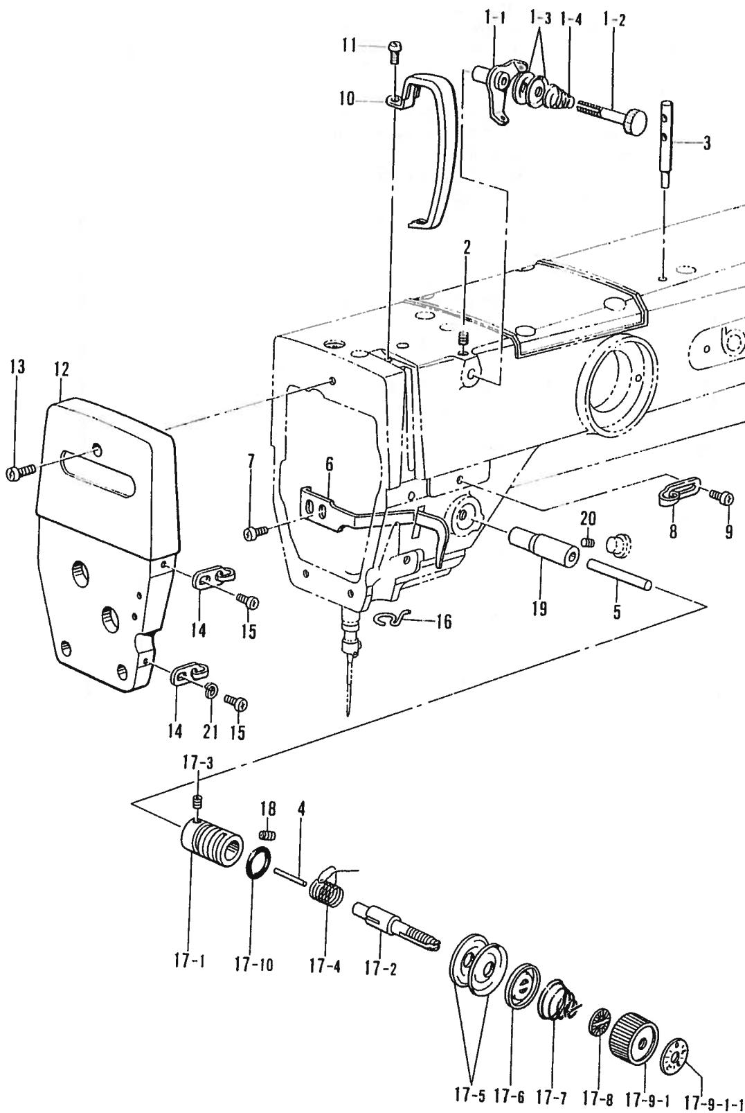
H. 糸通し関係/Threading mechanism/Fadenführungs vorrichtung/
