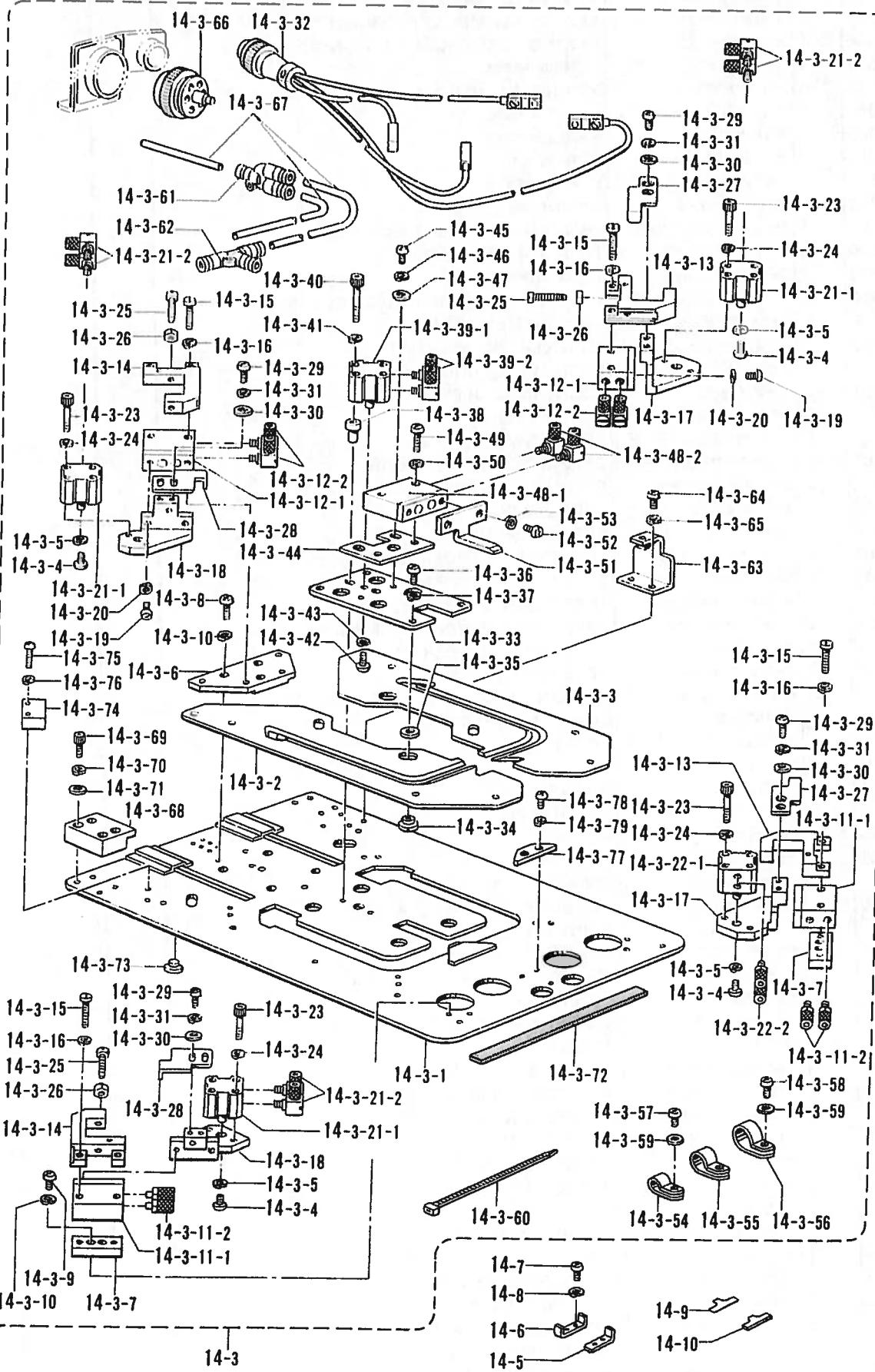
S. 折曲ゲ関係 (特別注文部品)/Folding margin mechanism (Option parts)/Faltungsvorrichtung (Sonderzubehör)/
