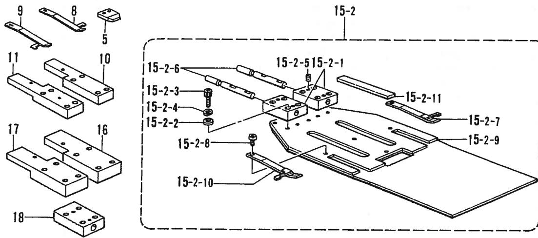
S. 折曲グリップ部(オプション部品)/Folding margin mechanism (Option parts)/Faltungsvorrichtung (Sonderzubehör)/
