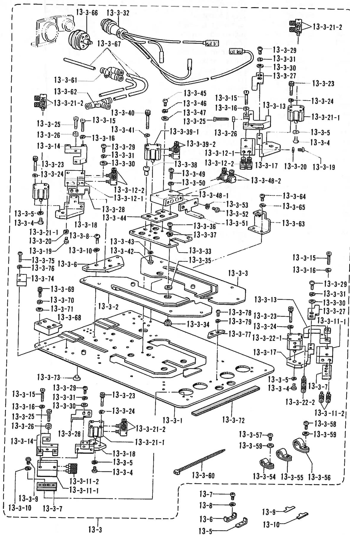
S. 折曲部関係 (特別注文部品)/Folding margin mechanism (Option parts)/Faltungsvorrichtung (Sonderzubehör)/
