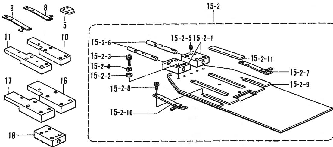
S. 折曲ゲ闇係 (特別注文部品)/Folding margin mechanism (Option parts)/Faltungsvorrichtung (Sonderzubehör)/
