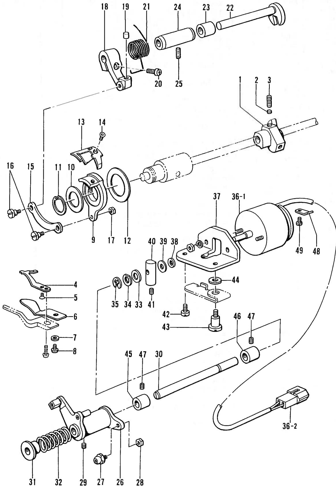
J. ポカリノ開機 / Thread trimmer mechanism / Fadenabschneidevorrichtung /
