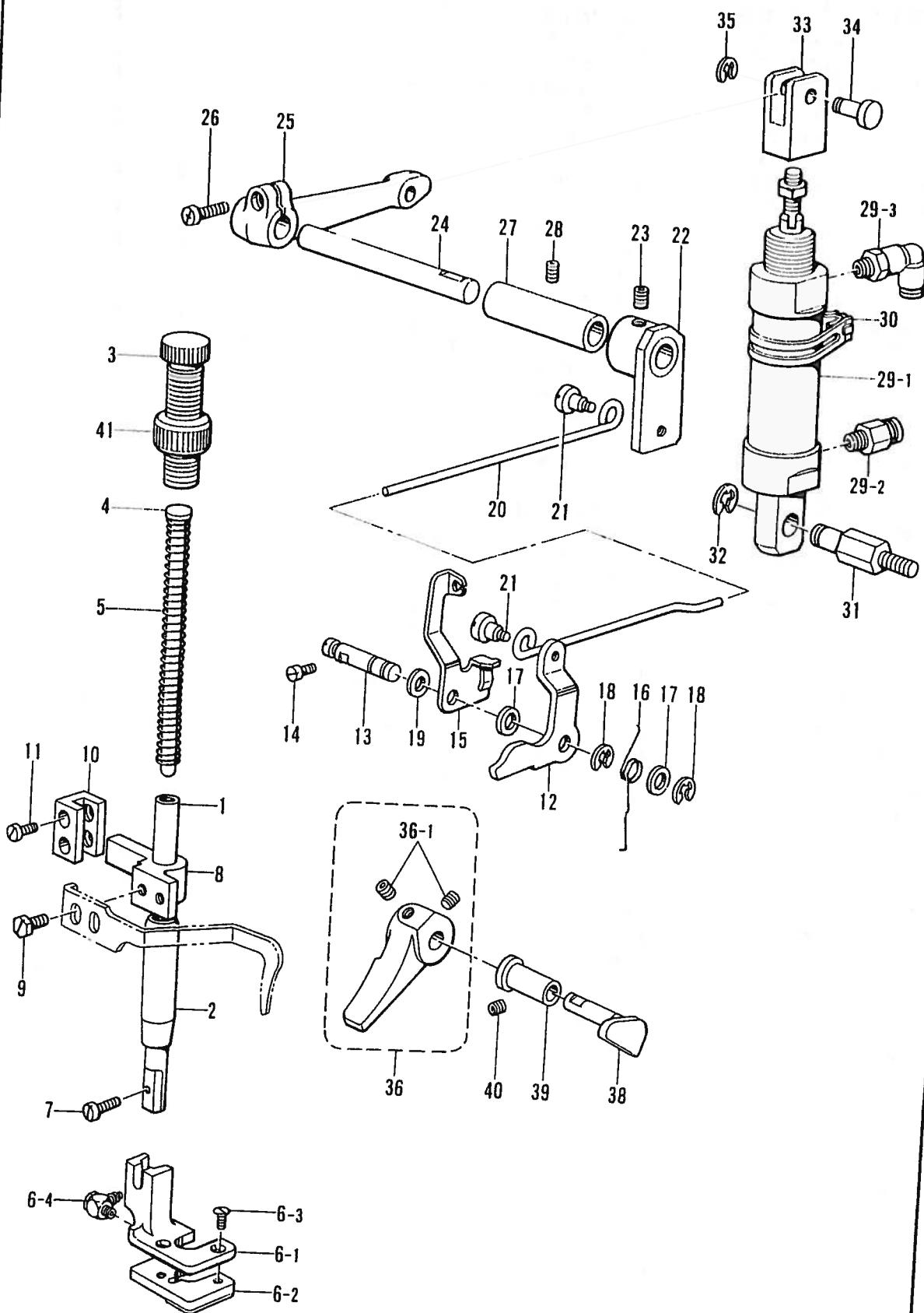
C. 押工関係/Presser foot mechanism/Stoffdrückerfuß/
