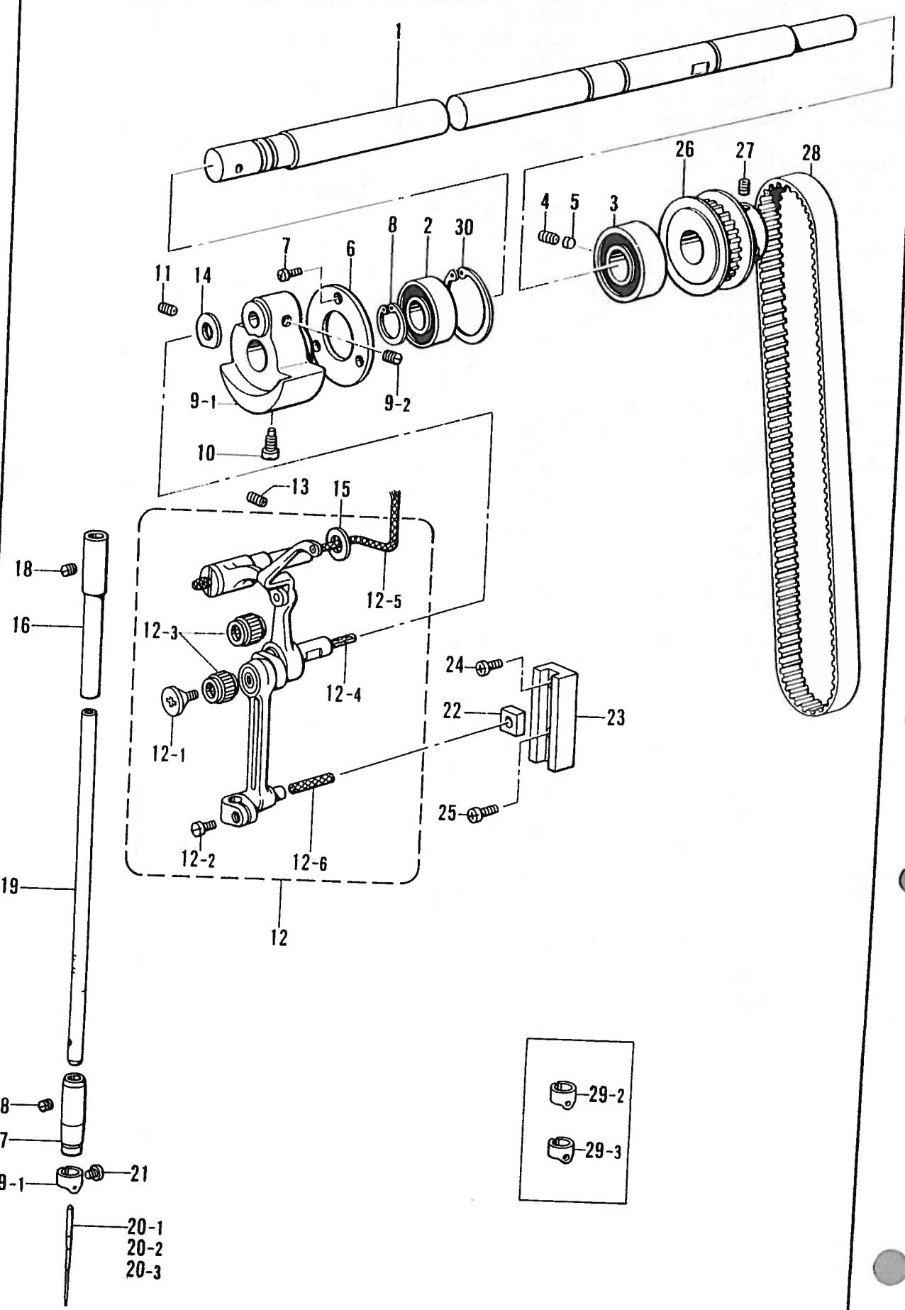
B. 針棒・天秤関係 / Needle bar and thread take-up mechanism / Nadelstangen und Fadenabnahmeverrichtung /
