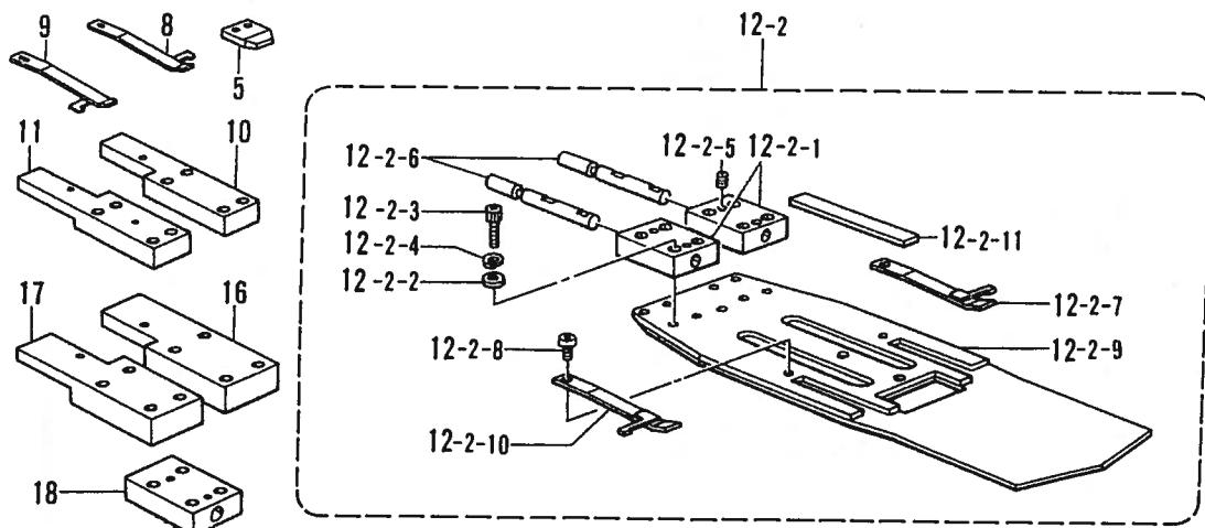
5. 折曲ケ関係 (特別注文部品)/Folding margin mechanism (Option parts)/Faltungsvorrichtung (Sonderzubehör)/
