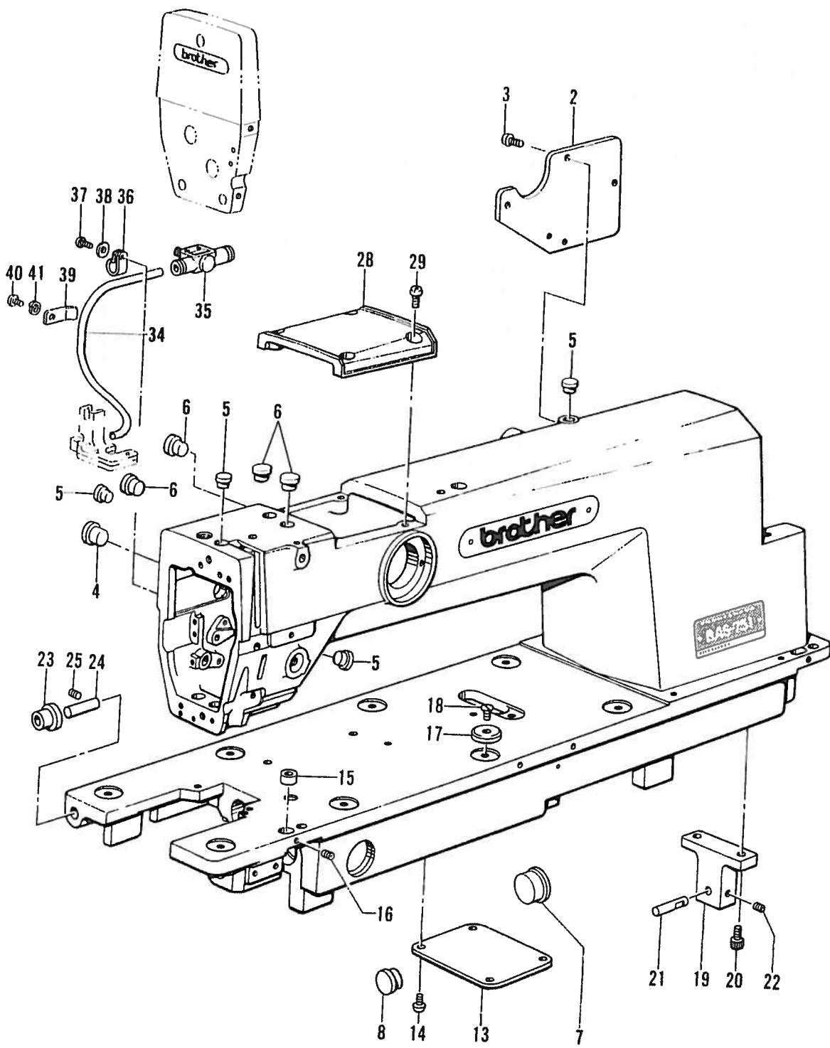
A. 主体関係/Machine body/Maschinengehäuse/
