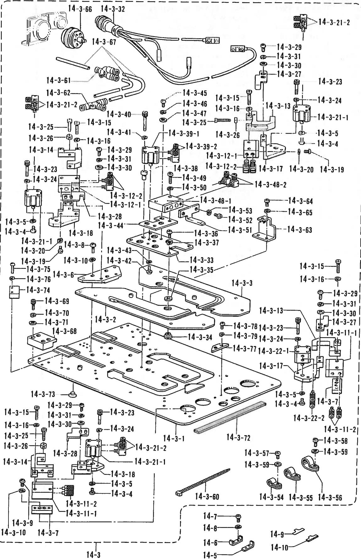
S. 折曲ヶ関係 (特別注文部品)/Folding margin mechanism (Option parts)/Faltungsvorrichtung (Sonderzubehör)/
