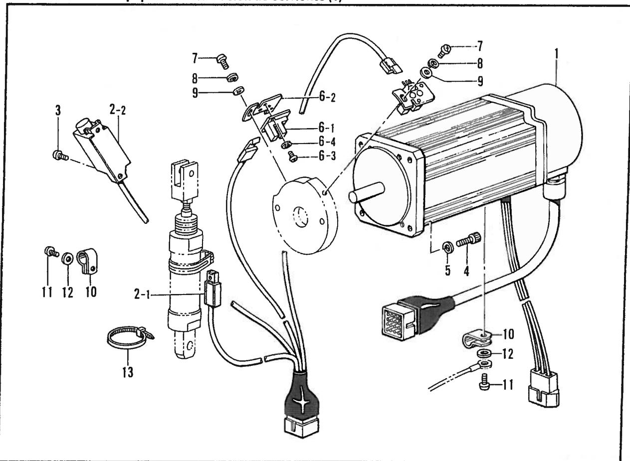
K. テンションリリース機関 / Tension release mechanism / Spannungsverminderungsvorrichtung /
