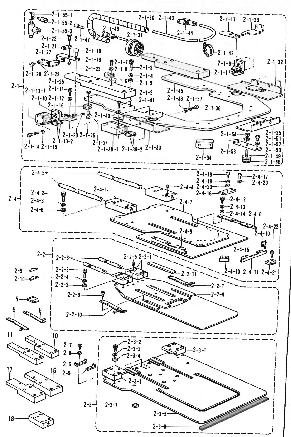
S. 折曲ゲル関係 (特別注文部品)/Folding margin mechanism (Option parts)/Faltungsvorrichtung (Sonderzubehör)/
