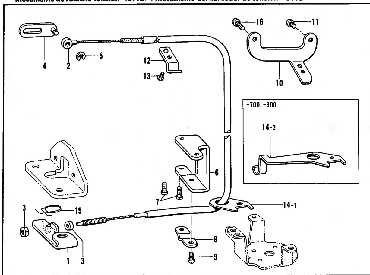
Q. 糸拭イ関係 <B772> / Thread wiper mechanism <B772> / Fadenwischvorrichtung <B772> /
