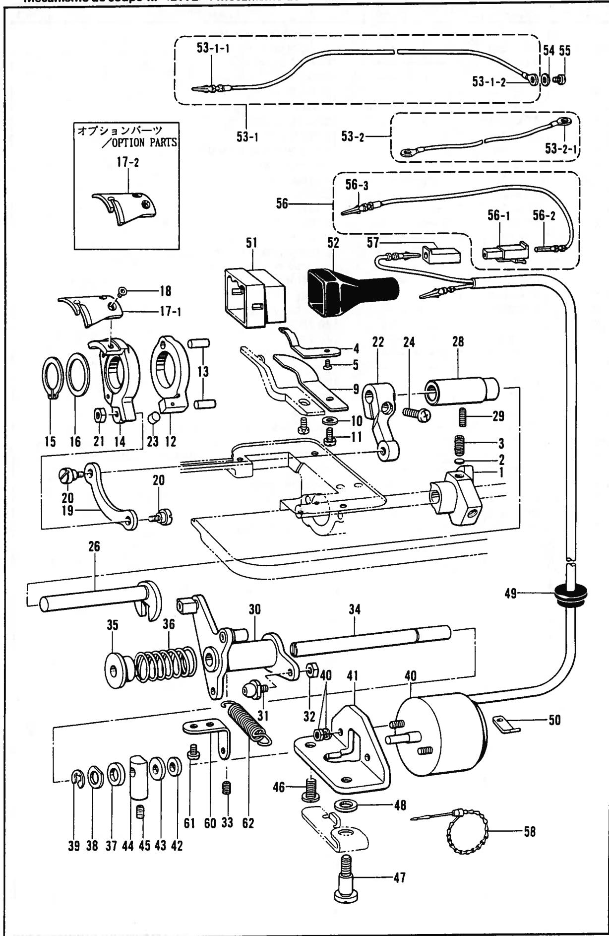
N. 糸切り関係 <B772> / Thread trimmer mechanism <B772> / Fadenabschneidevorrichtung <B772> /
