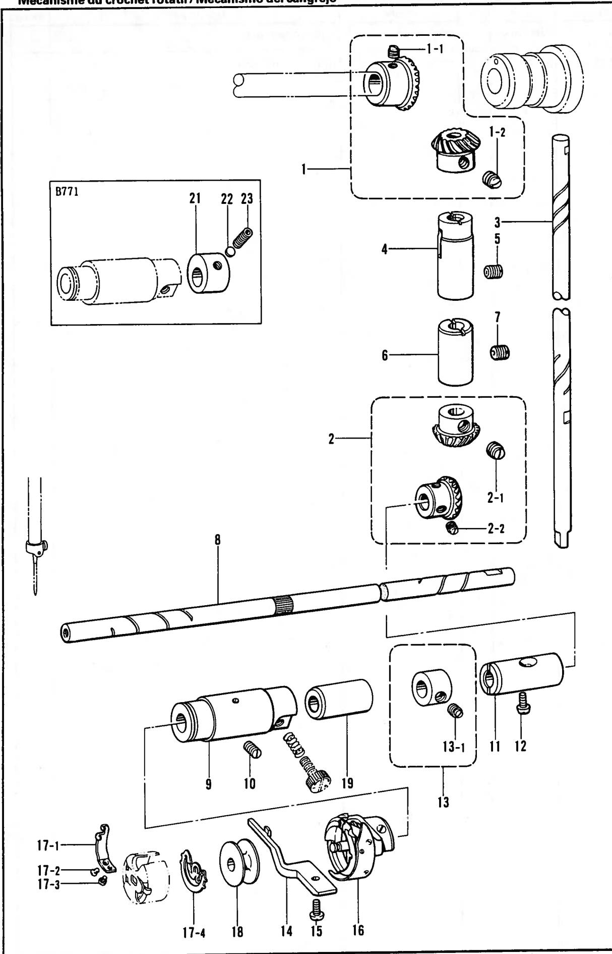
J. カマ関係 / Rotary hook mechanism / Greifervorrichtung /
