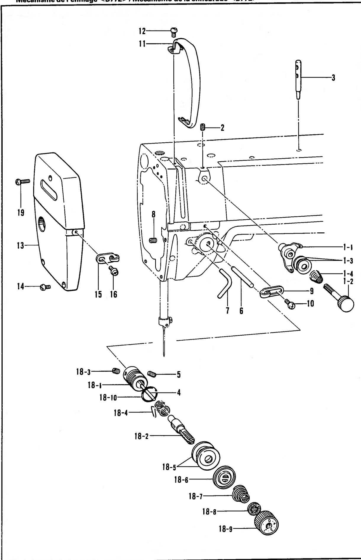
L1. 糸通シ関係 <B772> / Threading mechanism <B772> / Fadenführungs vorrichtung <B772> /
