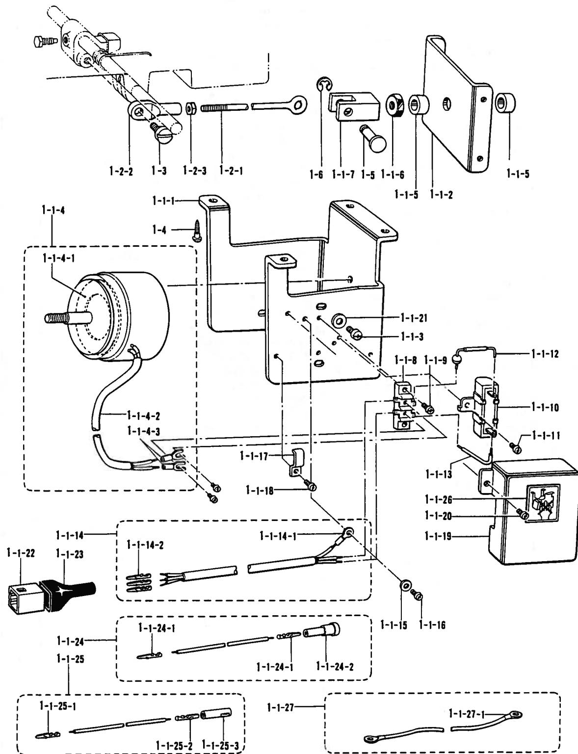
W1. 電磁押工上げ関係 / Presser foot lifting solenoid set / Solenoidsatz für die Anhebung des Stoffdrückerfußes /
