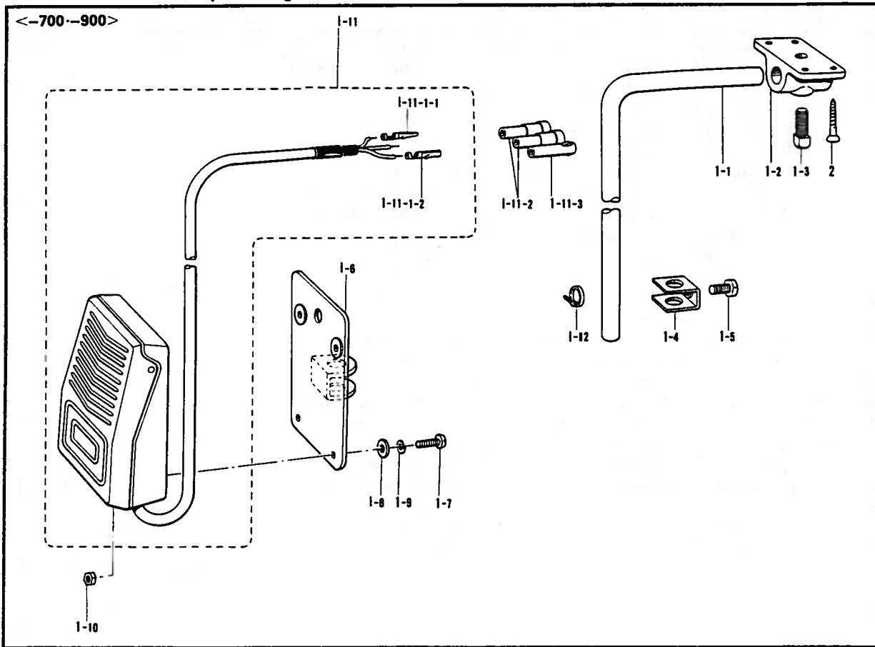
U. 逆転スイッチ関係 <B772> / Quick reverse switch mechanism <B772> / Umkehrschalter <B772>/
