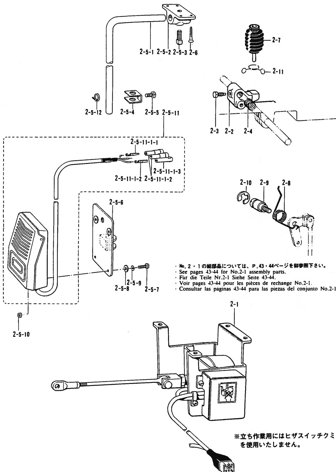
W2. 電磁押工上げ関係 / Presser foot lifting solenoid set / Solenoidsatz für die Anhebung des Stoffdrückerfußes /
