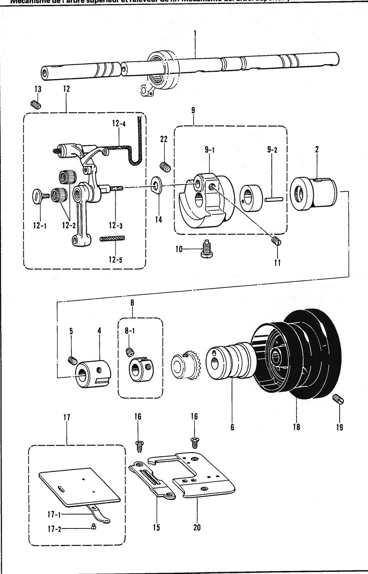
C. 上軸天ビン関係 / Upper shaft and thread take-up mechanism / Obere Welle und Fadenabnahmeverrichtung /
