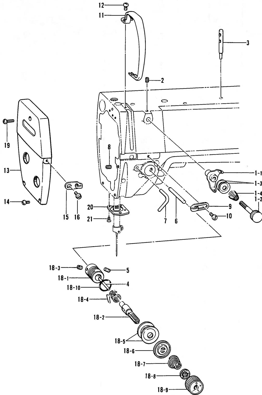
K. 糸通シ関係/Threading mechanism/Fadenführungs vorrichtung/
