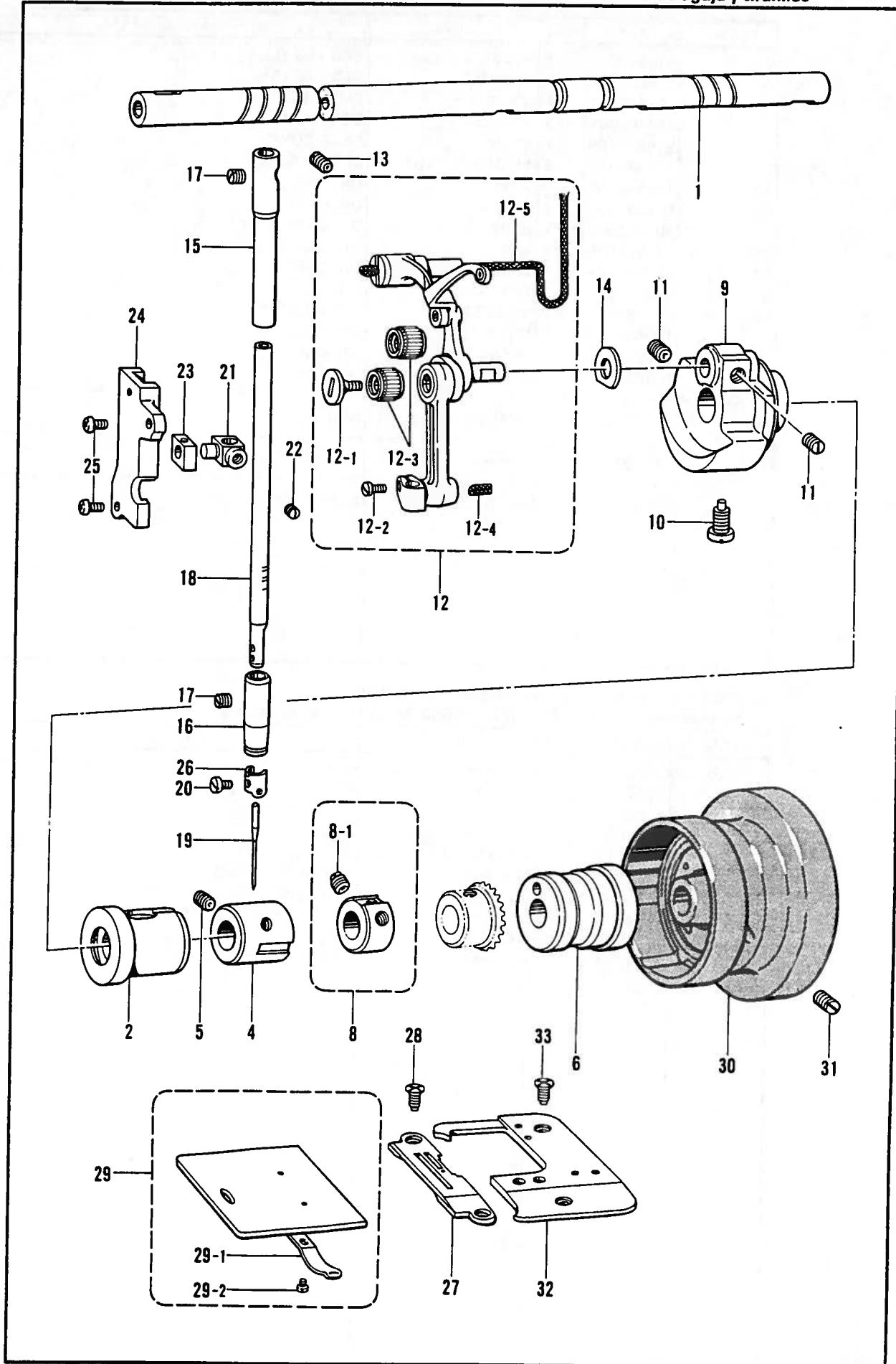
C. 針棒天ビン関係 / Needle bar and thread take-up mechanism / Nadelstange und Fadenabnahmeverrichtung /
