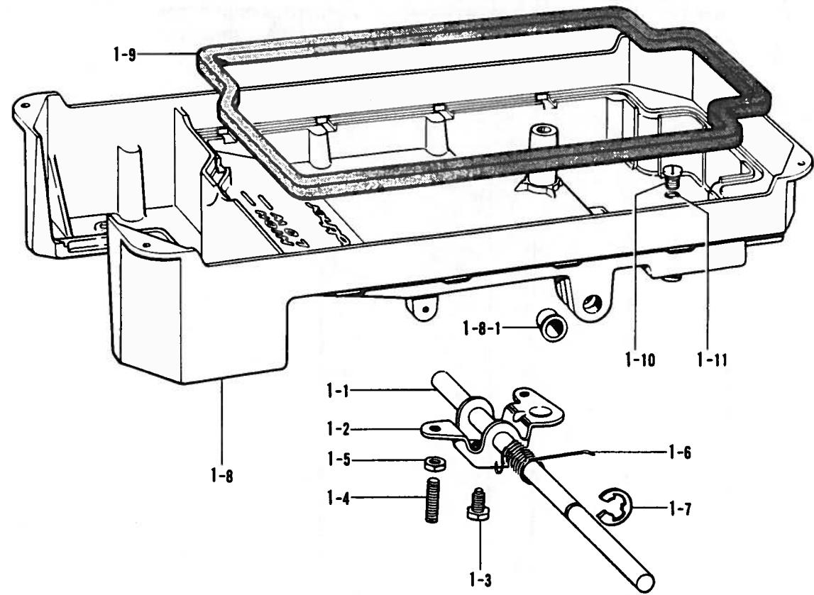
U. 逆転スイッチ関係/Quick reverse switch mechanism/Umrkehrschaalter/
