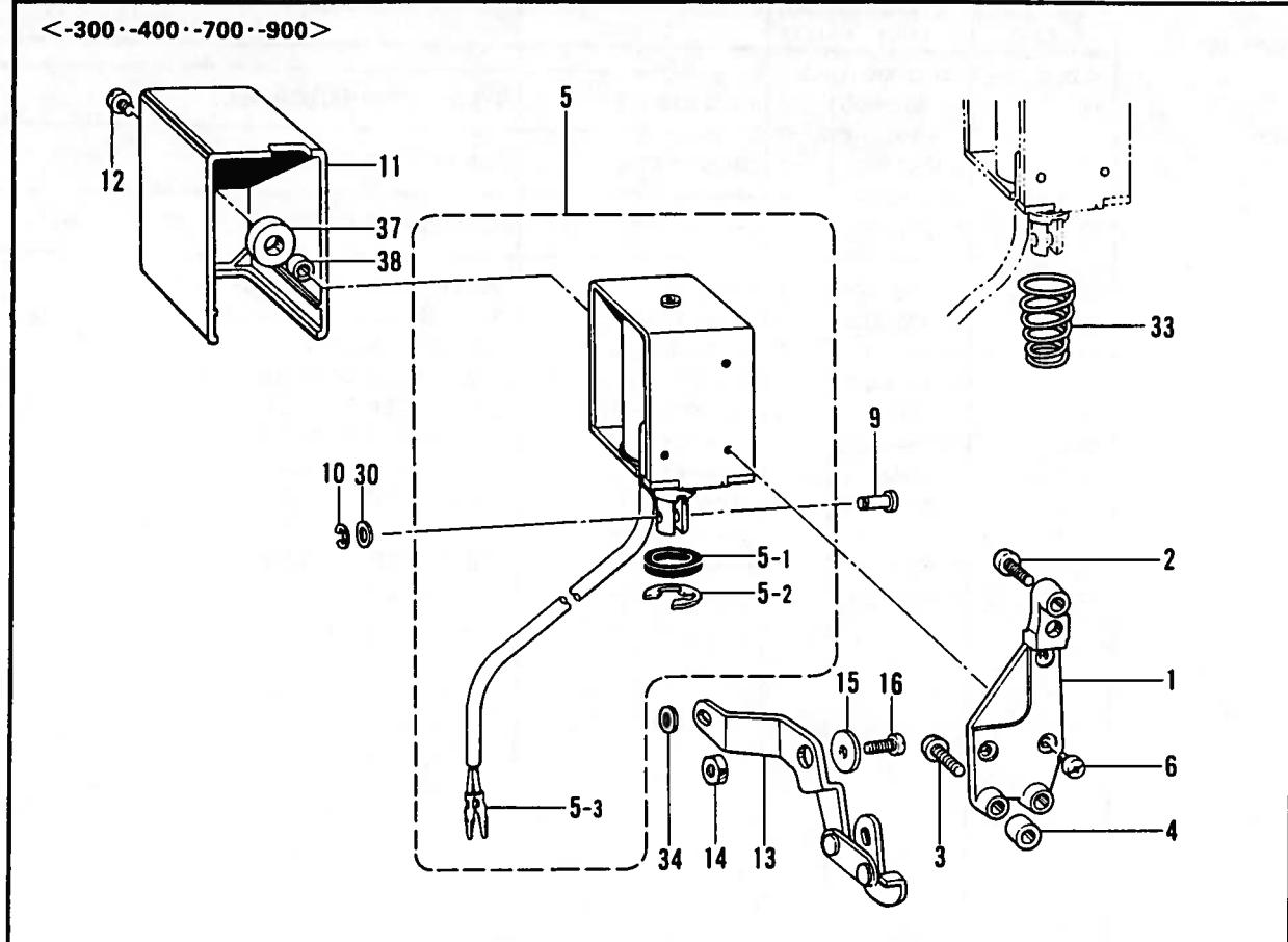
N. 糸ユルメ関係/Tension release mechanism/Spannungsverminderungsvorrichtung/
