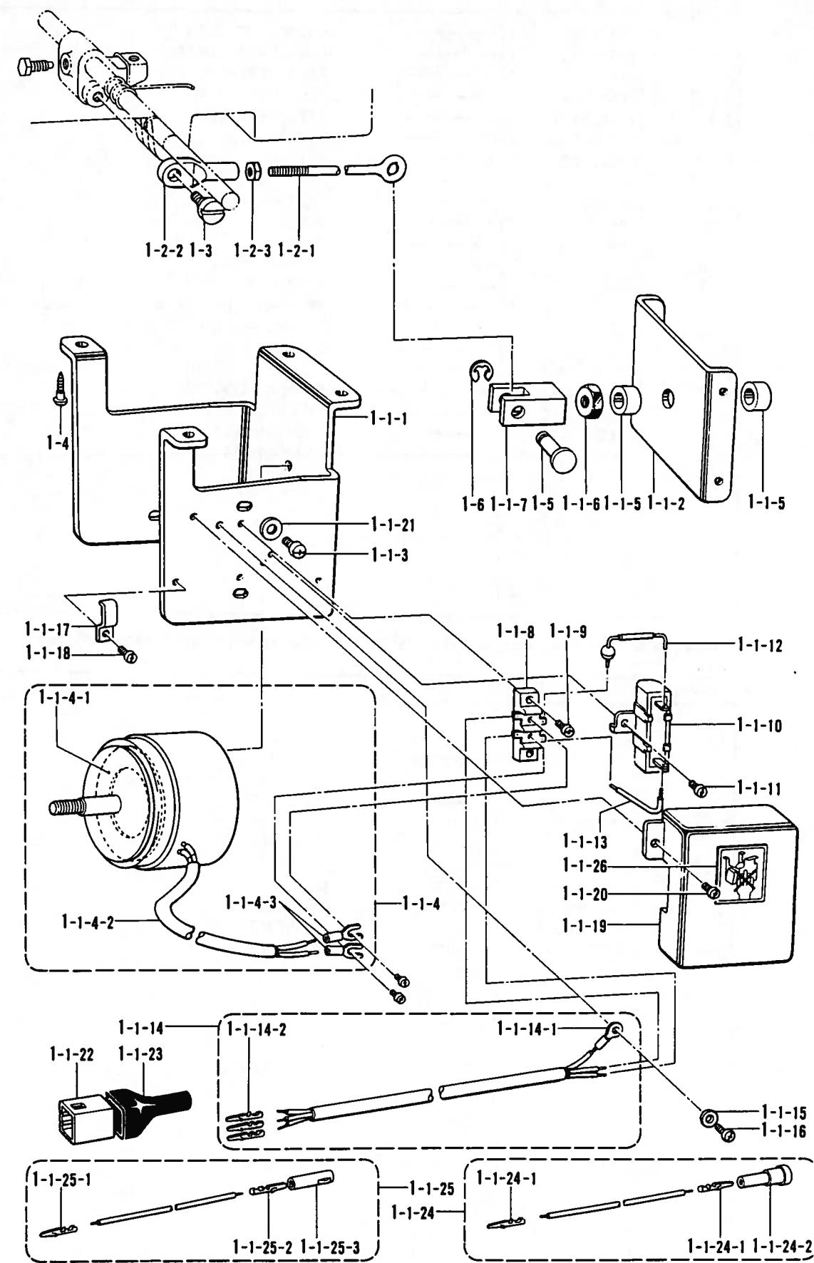
W1. 電磁押エ上ヶ関係/Presser foot lifting solenoid set/Solenoidsatz für die Anhebung des Stoffdrückerfußes/
