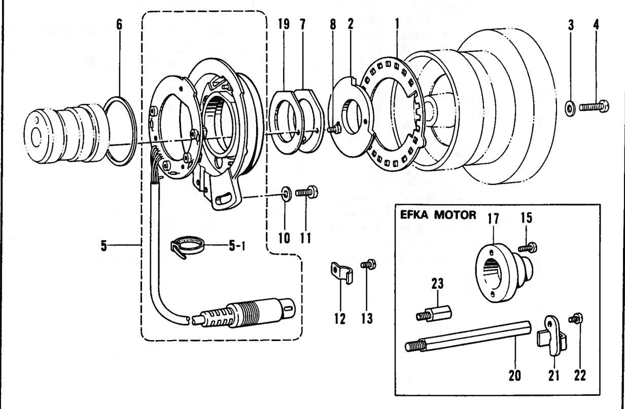
P. 糸拭イ関係/Thread wiper mechanism/Fadenwischvorrichtung/
