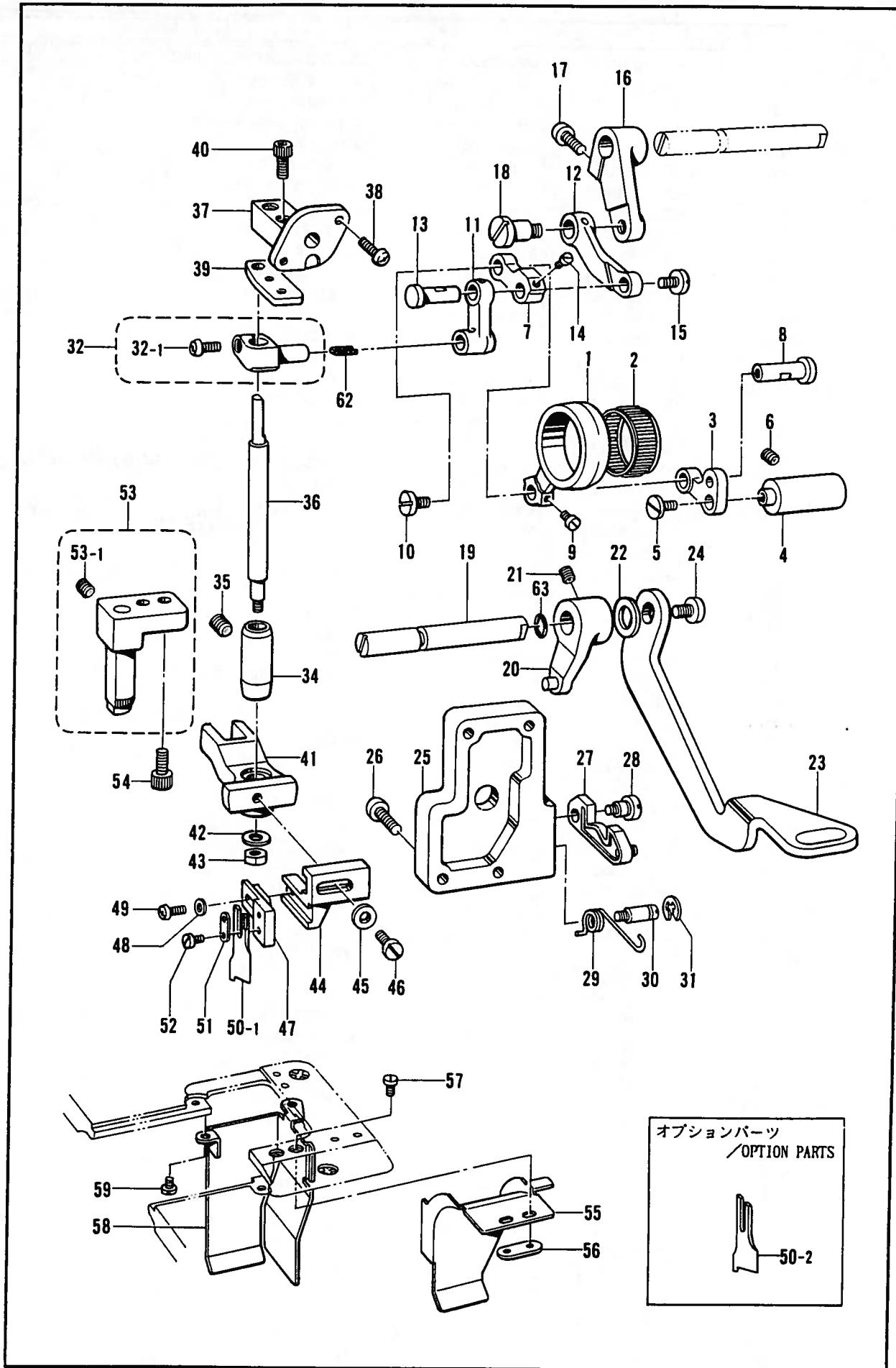
G. メス関係 /Knife mechanism /Messer /Mécanisme du couteau /Mecanismo del cuchilla
