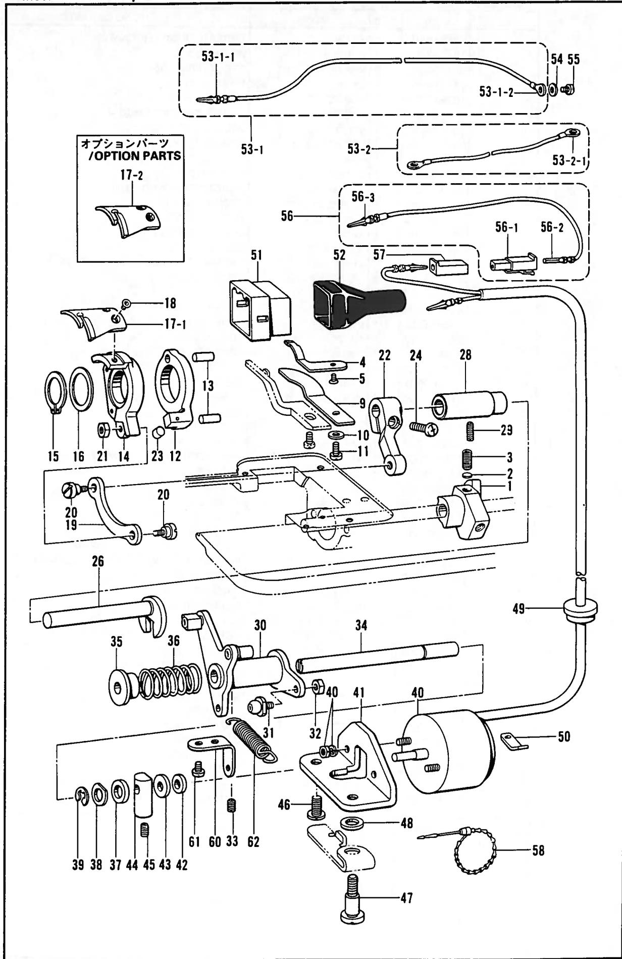
L. 糸切り関係/Thread trimmer mechanism/Fadenabschneidevorrichtung/
