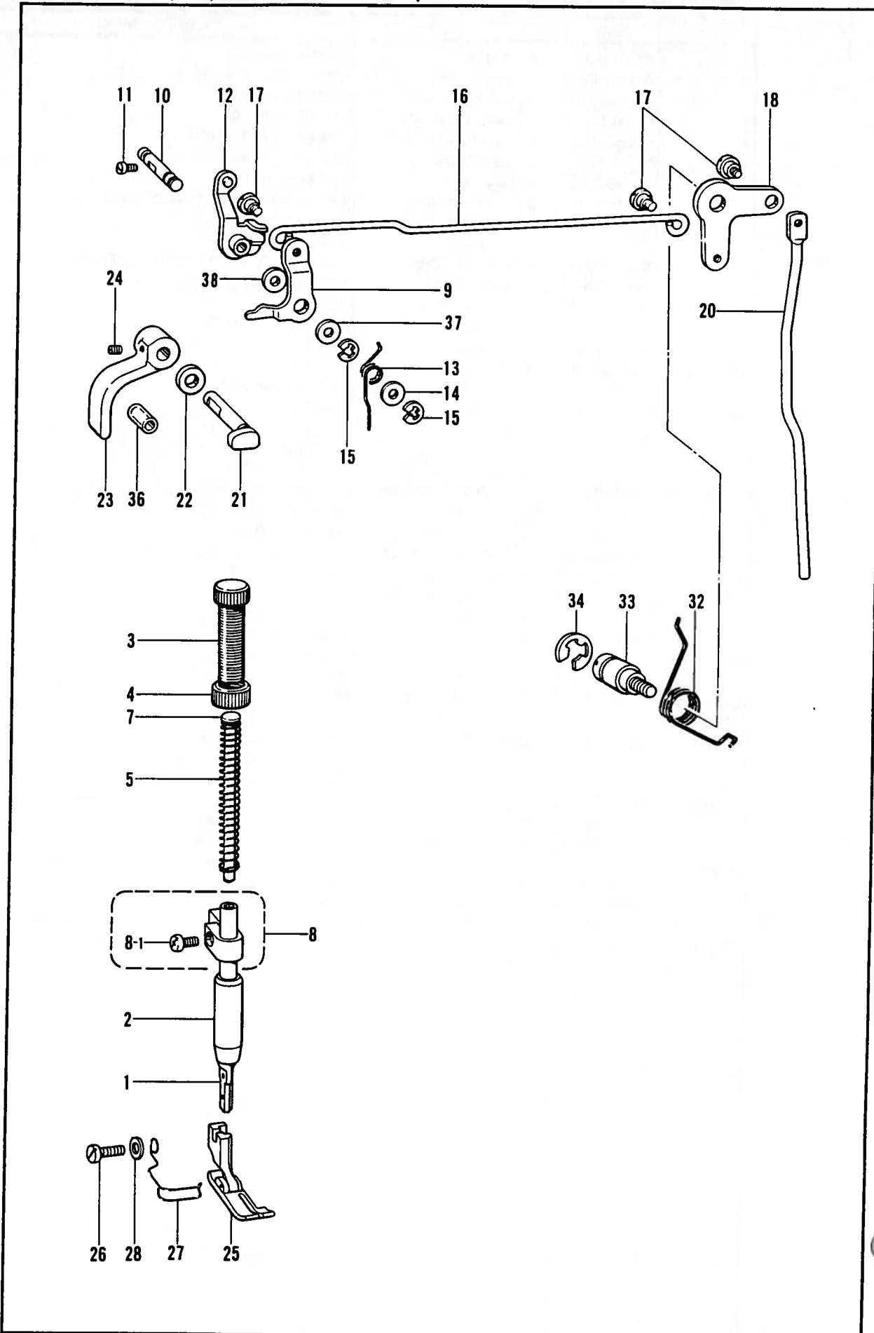
D. 押工関係/Presser foot mechanism/Stoffdrückerfuß/
