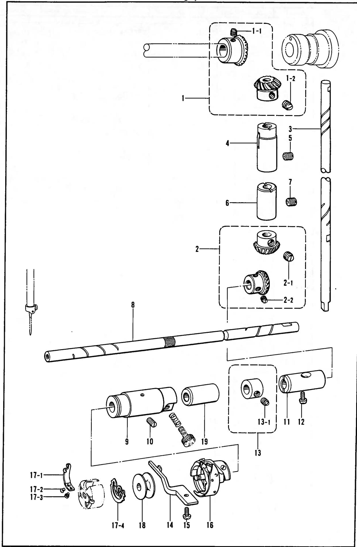
H. カマ関係 / Rotary hook mechanism / Greifervorrichtung /
