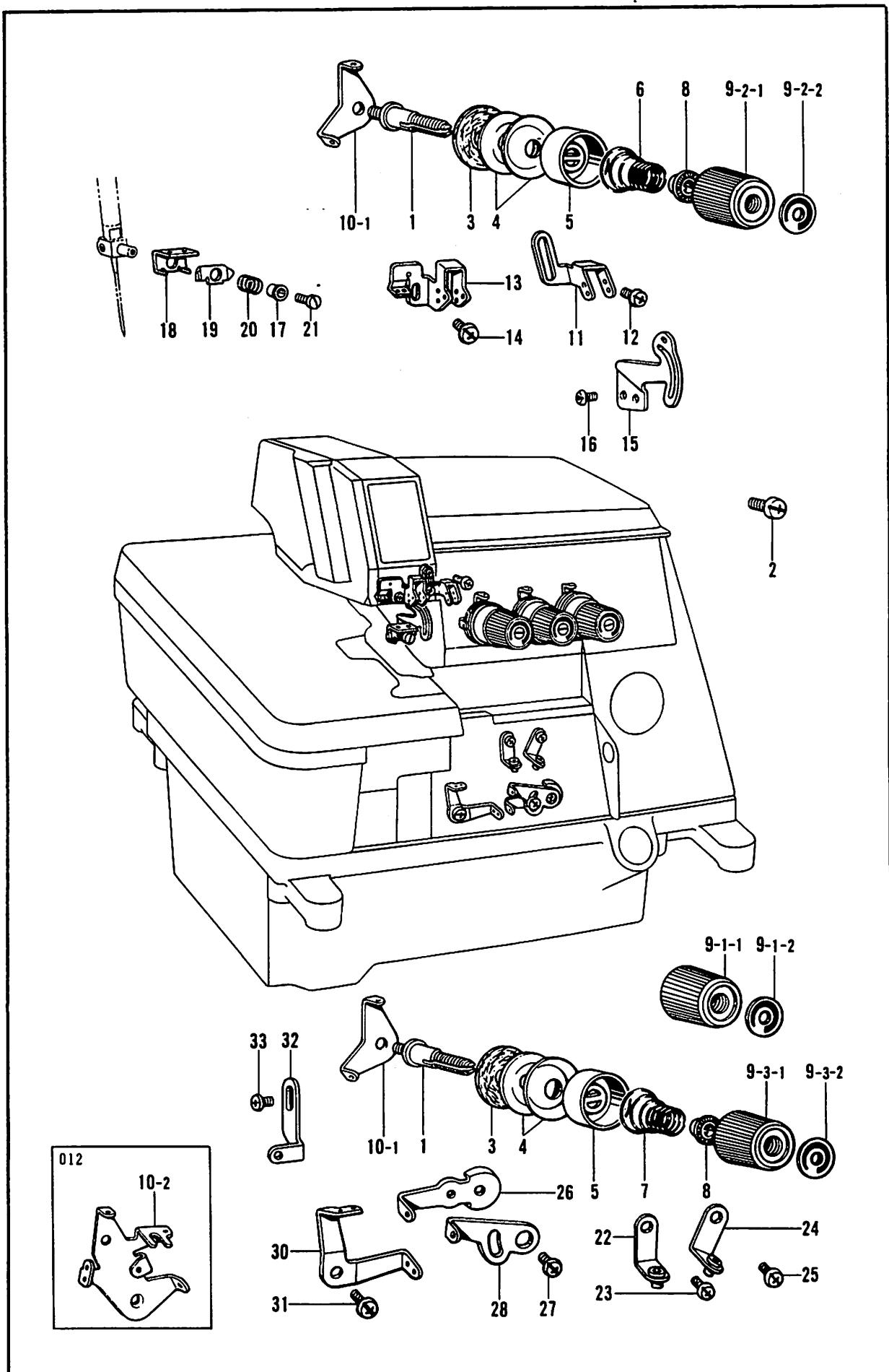
Q. 糸調子関係/Thread tension/Faderspannung/Tension du fil/Tensión del hilo
