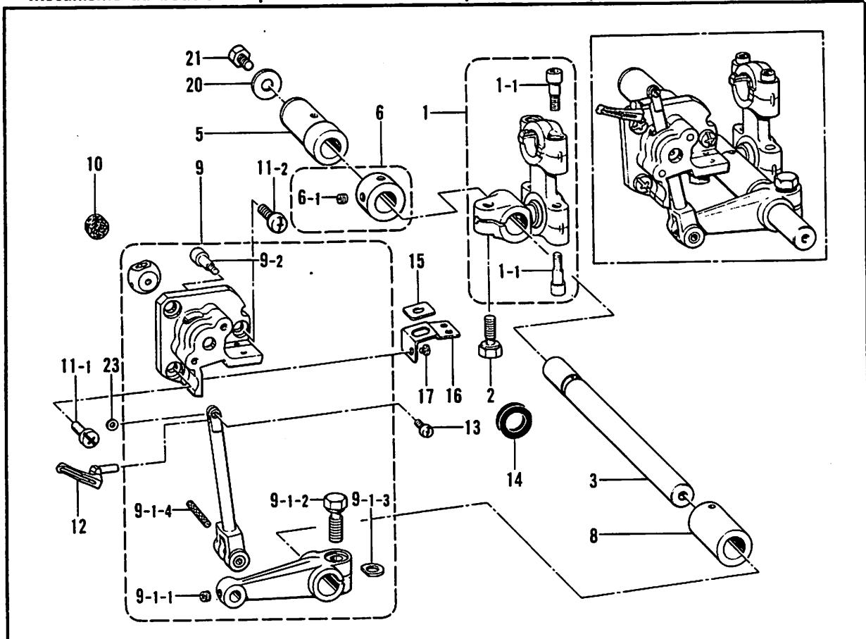
N. 下ルーパ関係 / Under looper mechanism / Unterer Greifer /
