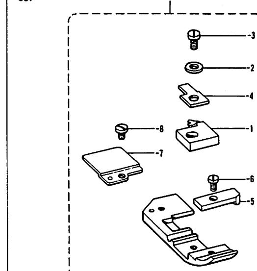
E. 押工関係/Presser foot mechanism/Stoffdrückerfuß/
