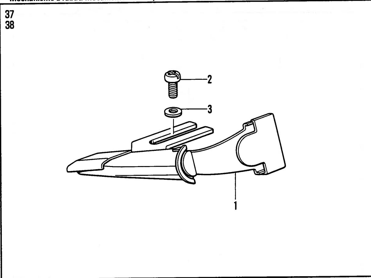
N. テープワインダー関係 / Tape winder mechanism / Bandaufwickelvorrichtung /
