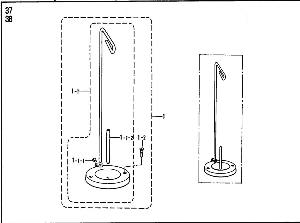
L: 針冷却装置/Needle cooler/Nadelkühlungsvorrichtung/
