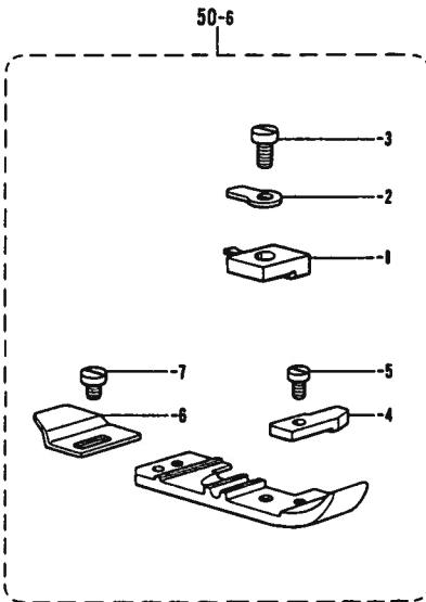
D. 押工関係 /Presser foot mechanism/Stoffdrückerfuß/
