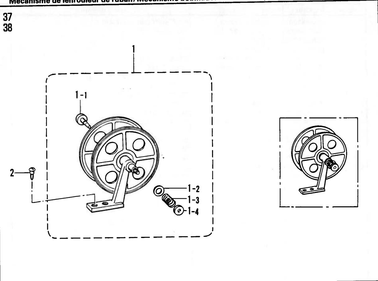
P. ラッパー関係 / Lapper mechanism / Falz-Mechanismus /
