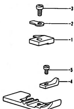
D. 押工関係 /Presser foot mechanism/Stoffdrückerfuß/
