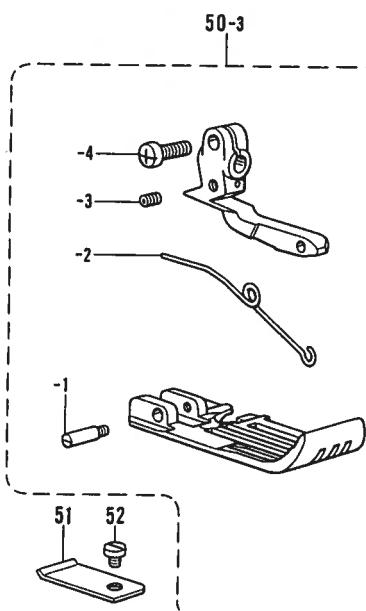
D. 押工関係 / Presser foot mechanism / Stoffdrückerfuß /
