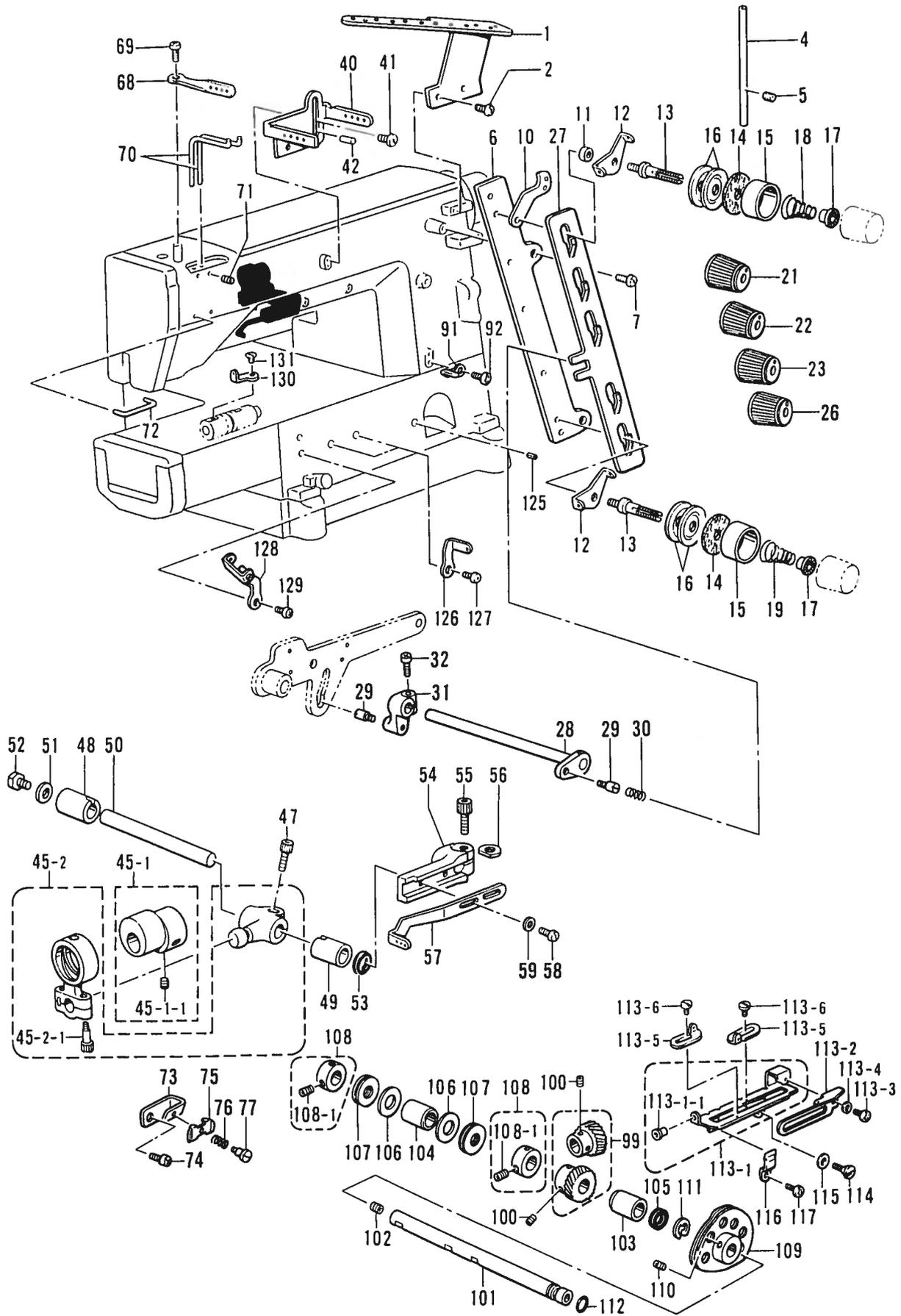
K1. 糸調子関係 / Thread tension / Faderspannung
