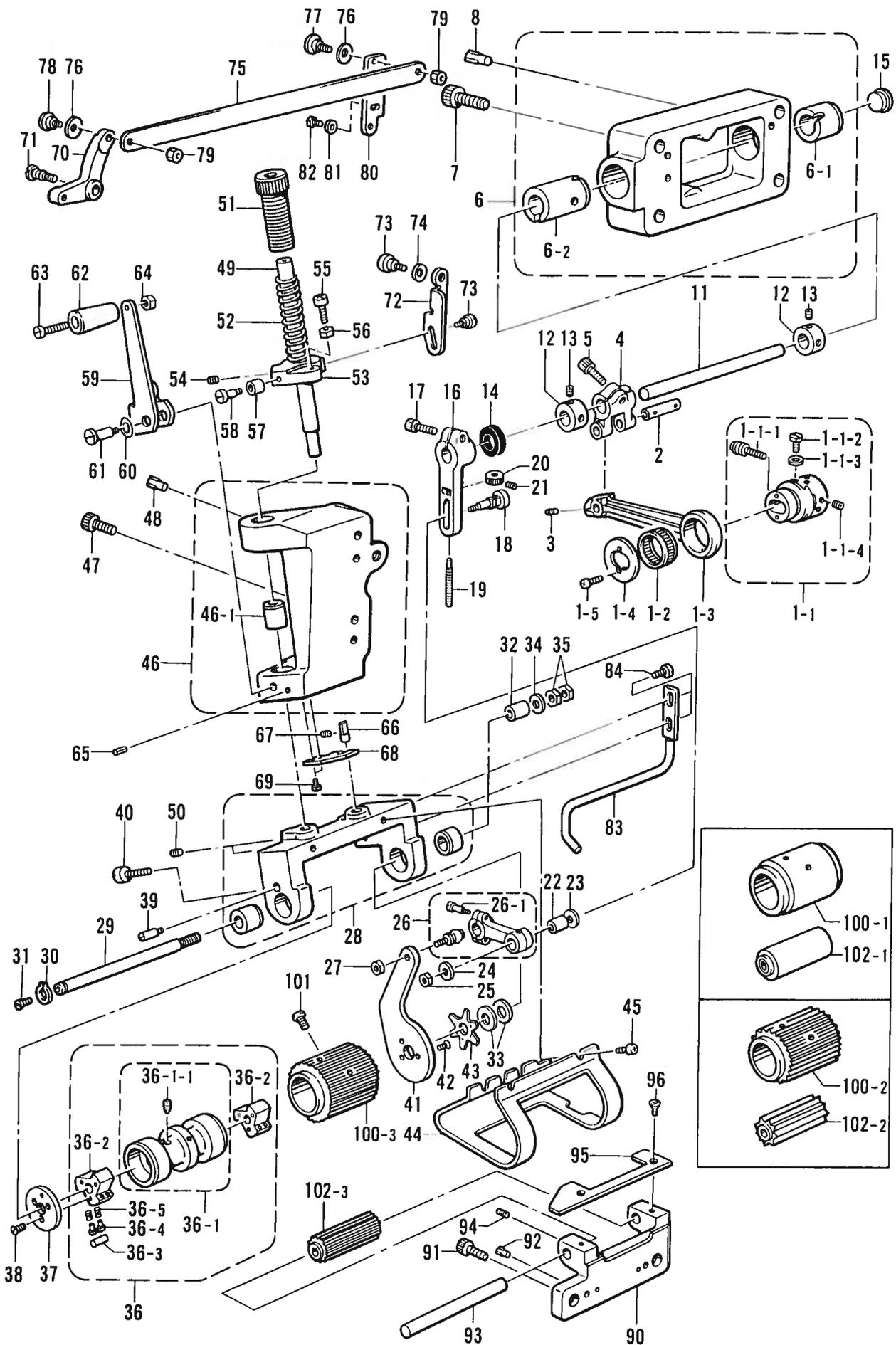
L. プーラー装置関係 / Puller device mechanism / Ziehvorrichtung
