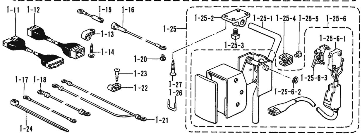
P2. パルスモータ式上ゴム送り関係 / Pulse motor drive top metering mechanism /
