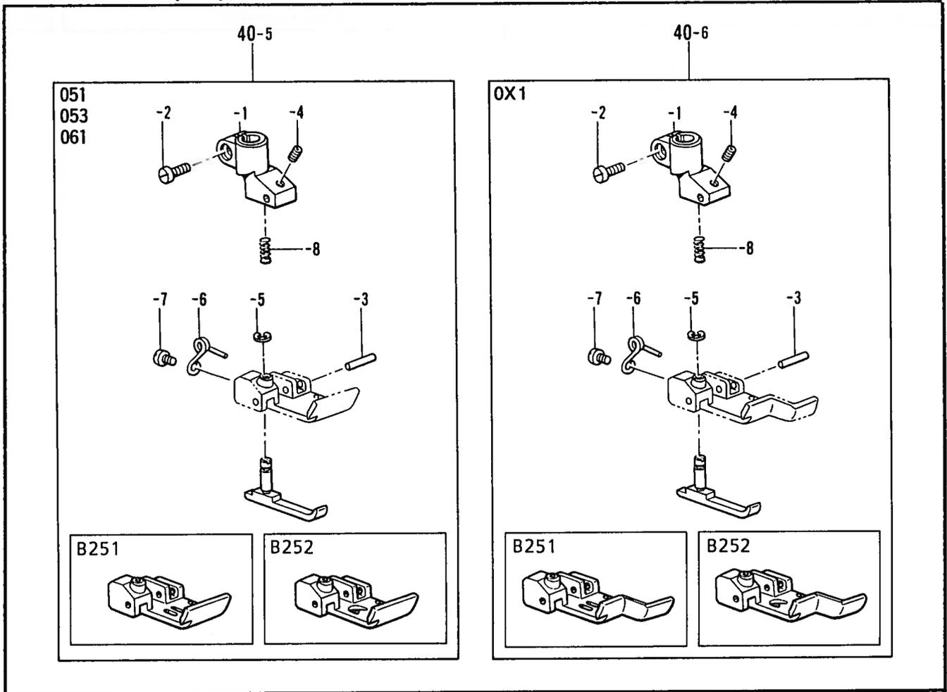
D. 針冷却装置/Needle cooler/Nadelkühlungsvorrichtung/
