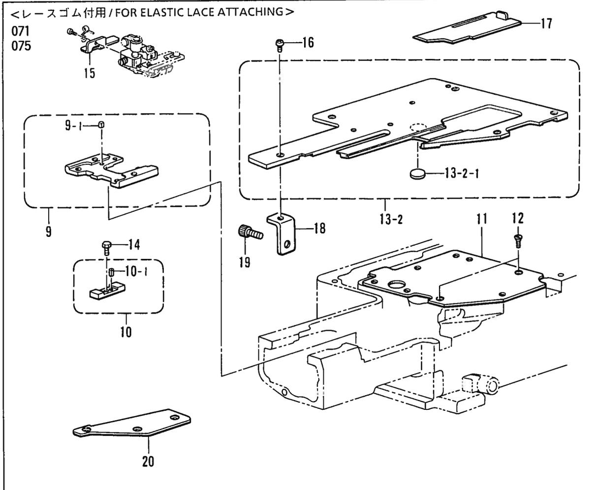
Q4. テープカッター装置関係 / Tape cutter mechanism / Bandabschneidesolenoid /
