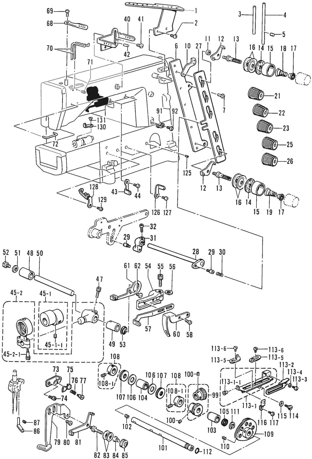
K2. 糸調子関係 / Thread tension / Faderspannung
