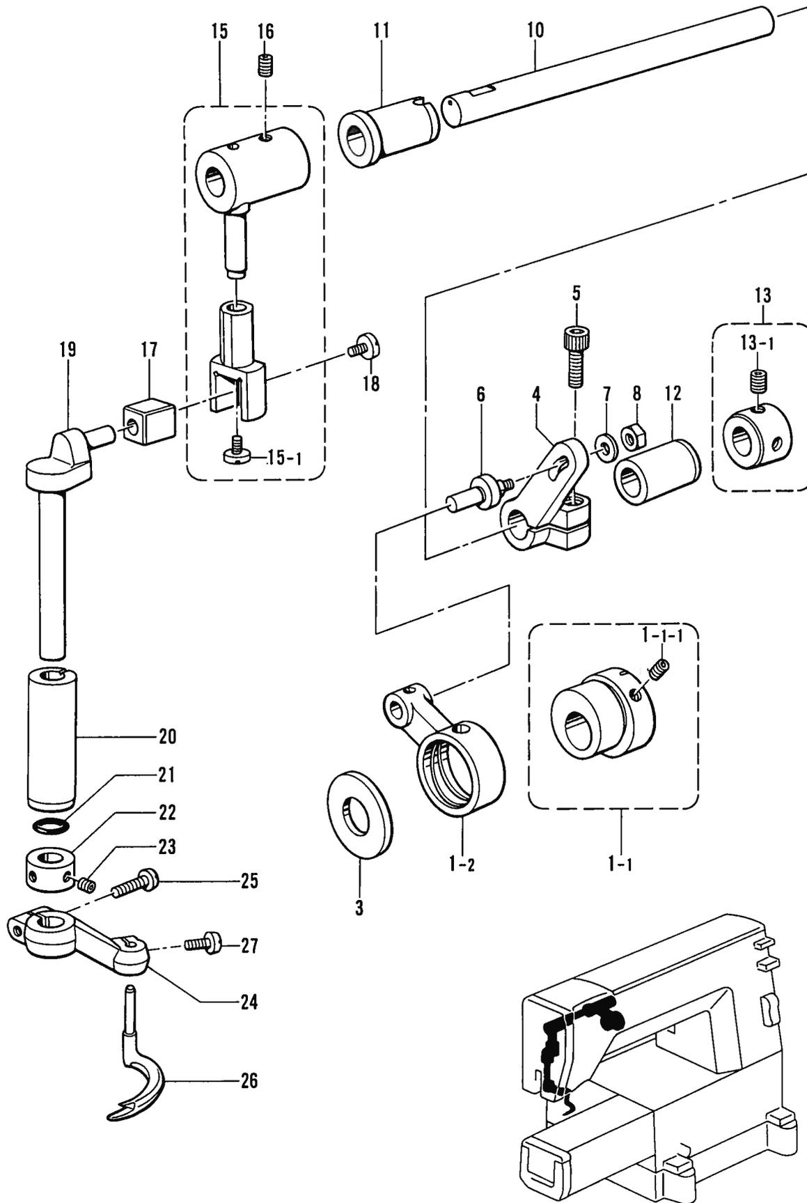
J. スプレダー関係 / Spreader mechanism / Spreizvorrichtung
