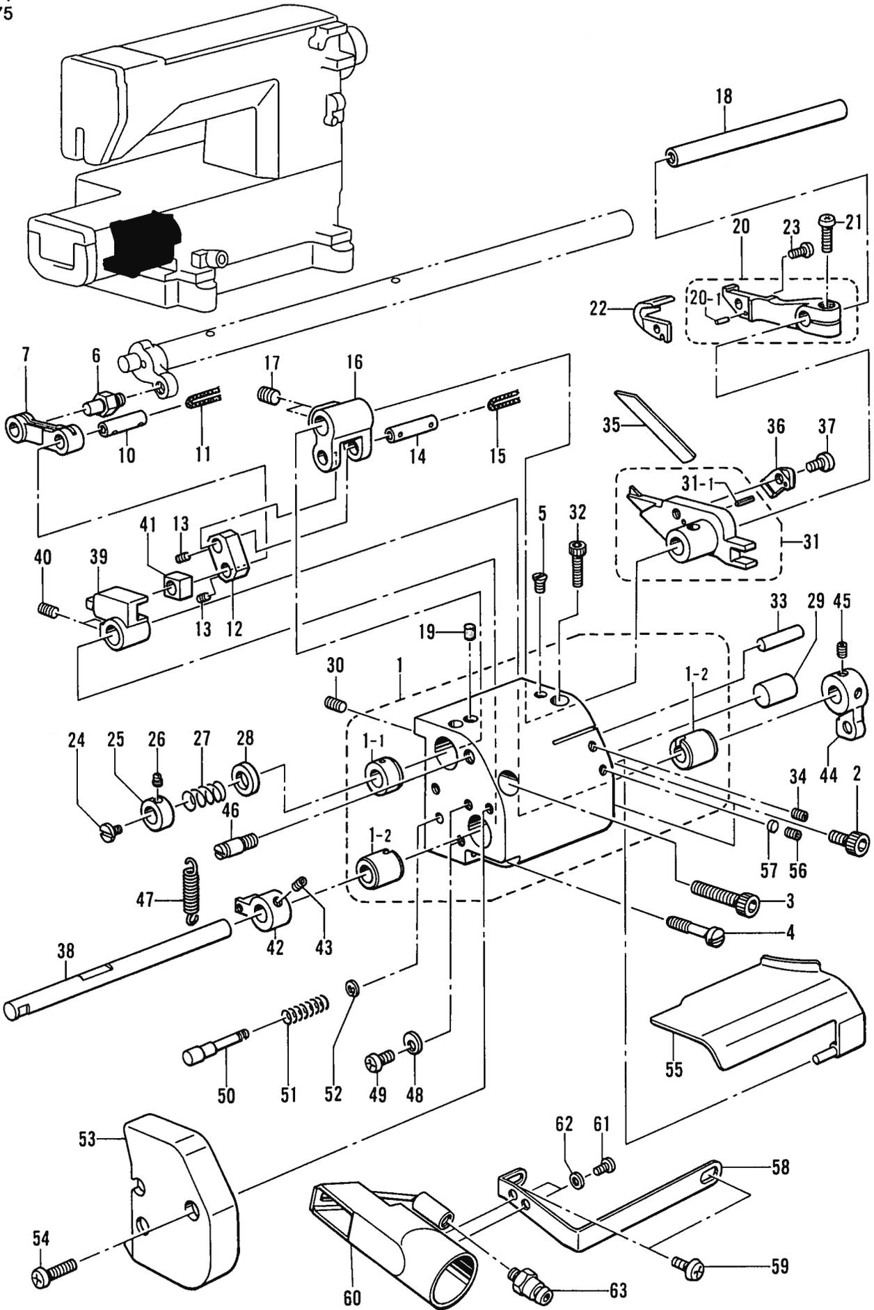
M1. トリミングメス関係 /Trimming knife mechanism/Fadenabschneidemesseinheit
