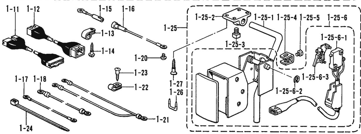
P2. パルスモータ式上ゴム送り関係 / Pulse motor drive top metering mechanism/
