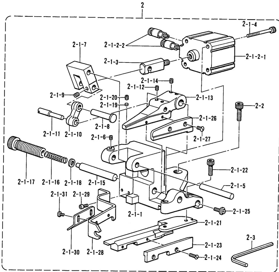
Q3. エアー式テープカッター装置関係 / Air type tape cutter r mechanism/
