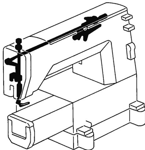
C1. 押工関係 / Presser foot mechanism / Stoffdrückerfuß /
