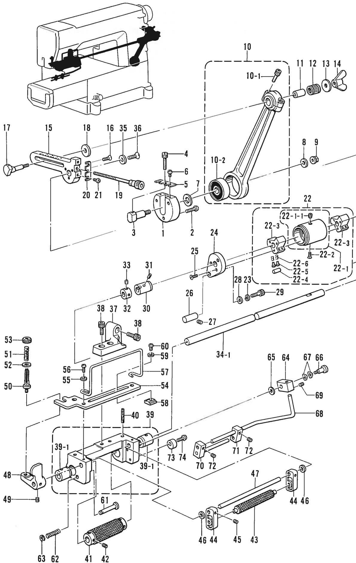
N. 上ゴム送り関係 / Upper rubber feed mechanism / Obere Gummibandtransporteinheit /
