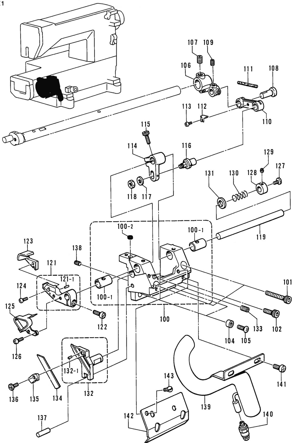
M2. トリミングメス関係 /Trimming knife mechanism/Fadenabschneidemesseinheit
