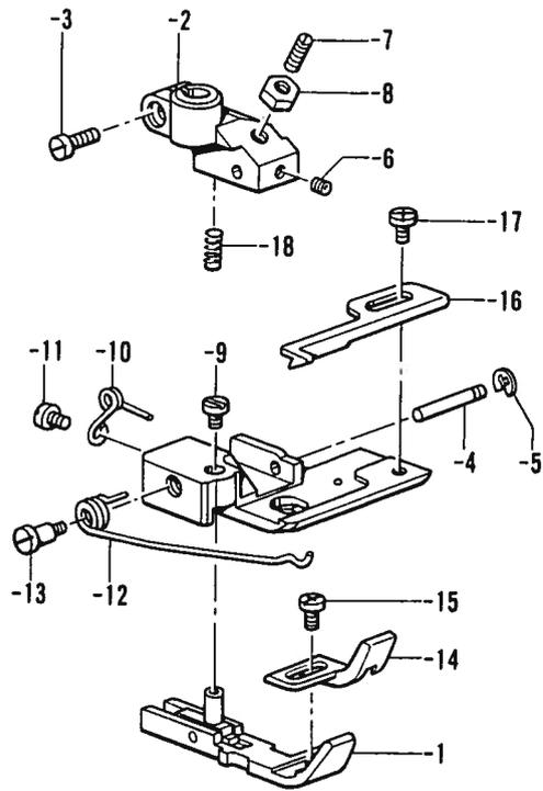
C2. 押工関係/Presser foot mechanism/Stoffdrückerfuß/
