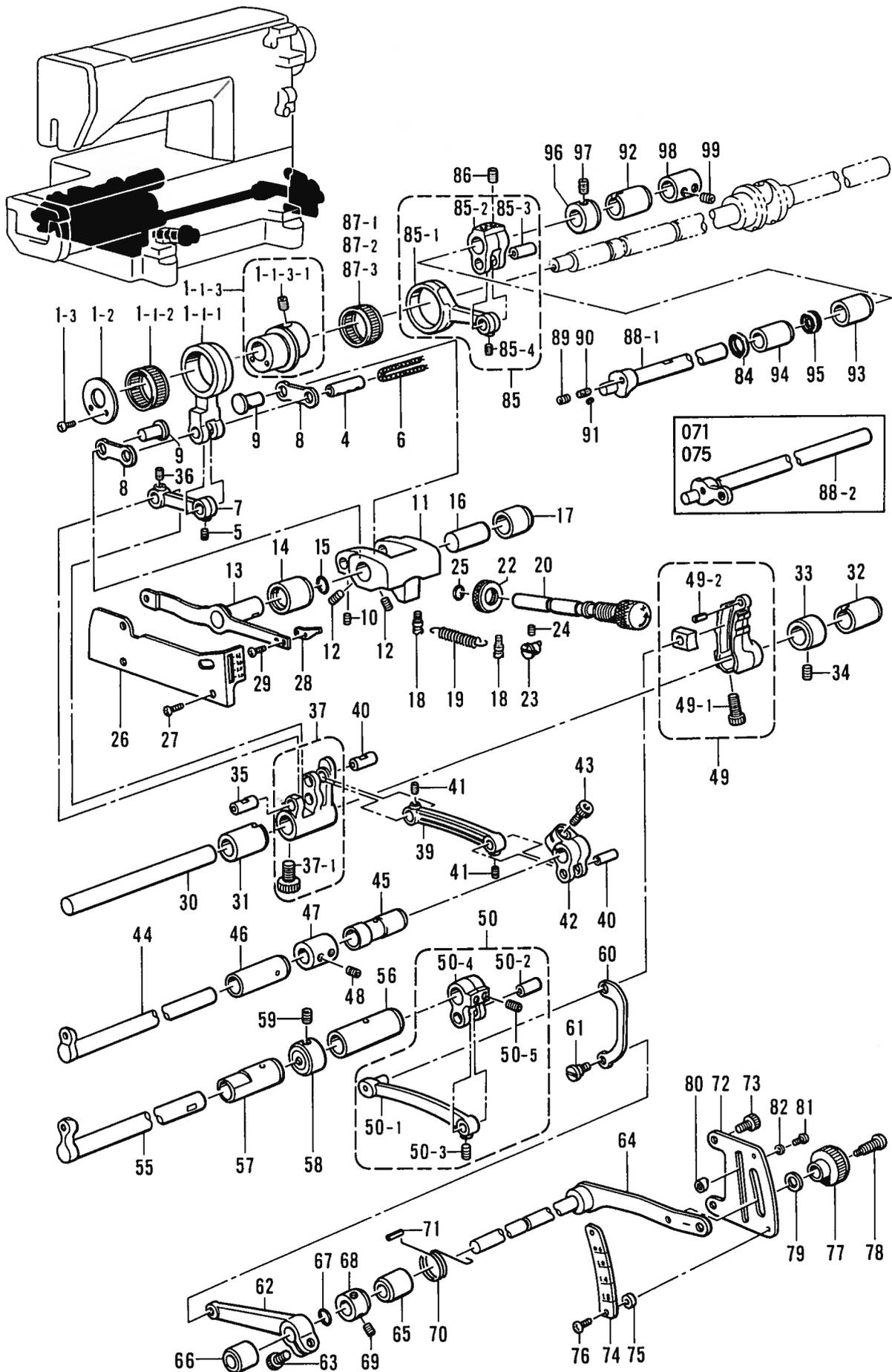
E1. 送り関係 / Feed mechanism / Transportvorrichtung /
