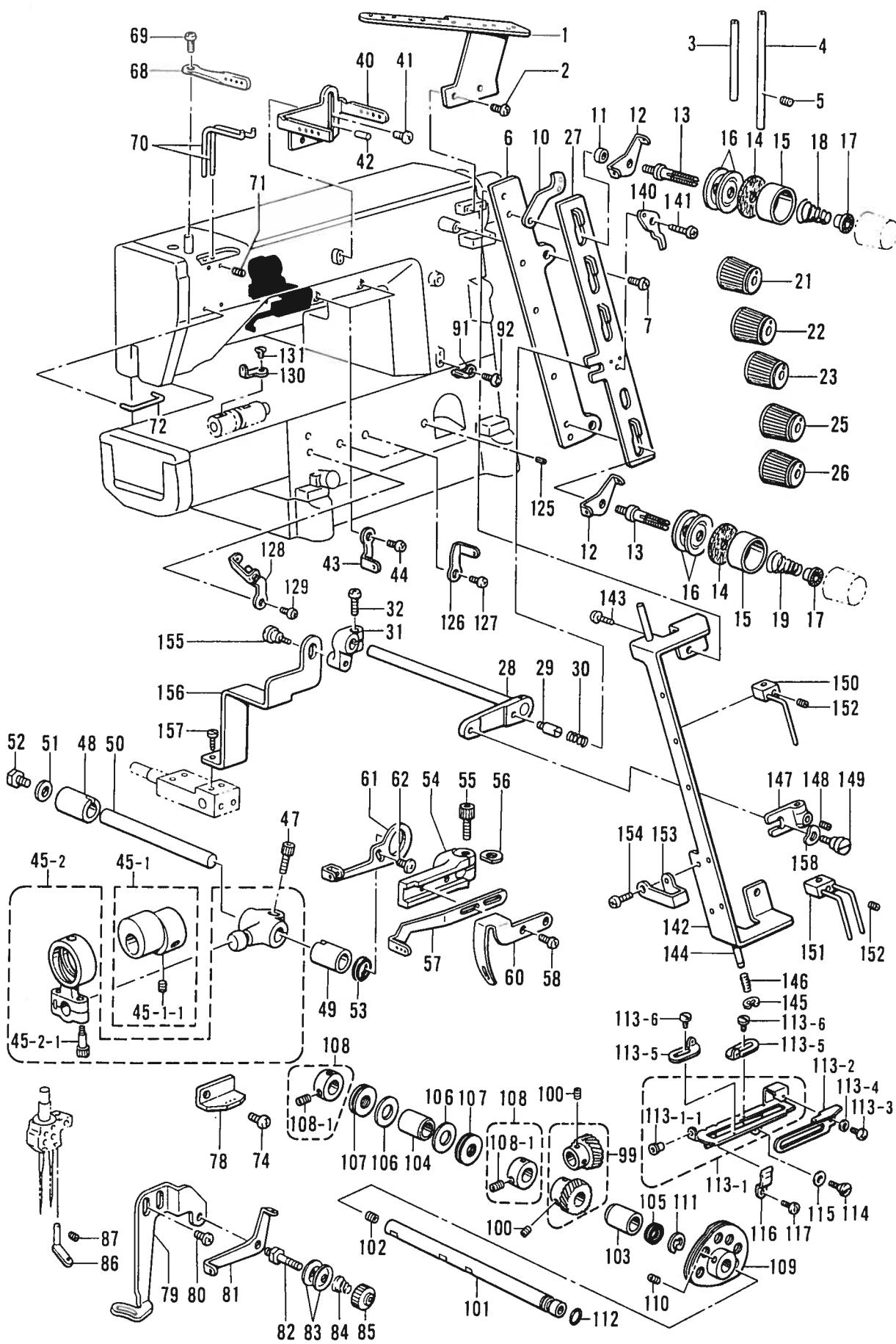
K2. 糸調子関係(B257)/Thread tension/Faderspannung/
