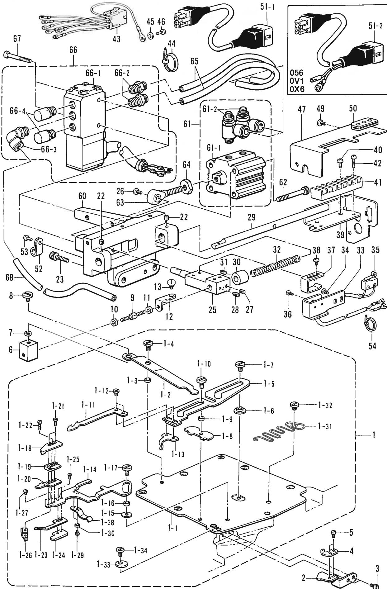
S2. 下飾り糸切り関係 / Lower thread trimmer mechanism / Unterfadenabschneider /
