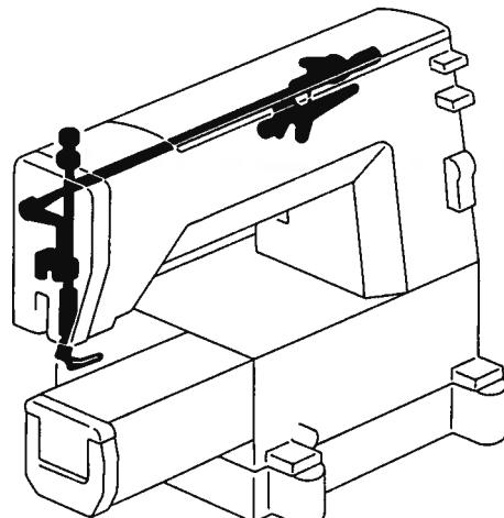
C1. 押工関係/Presser foot mechanism/Stoffdrückerfuß/
