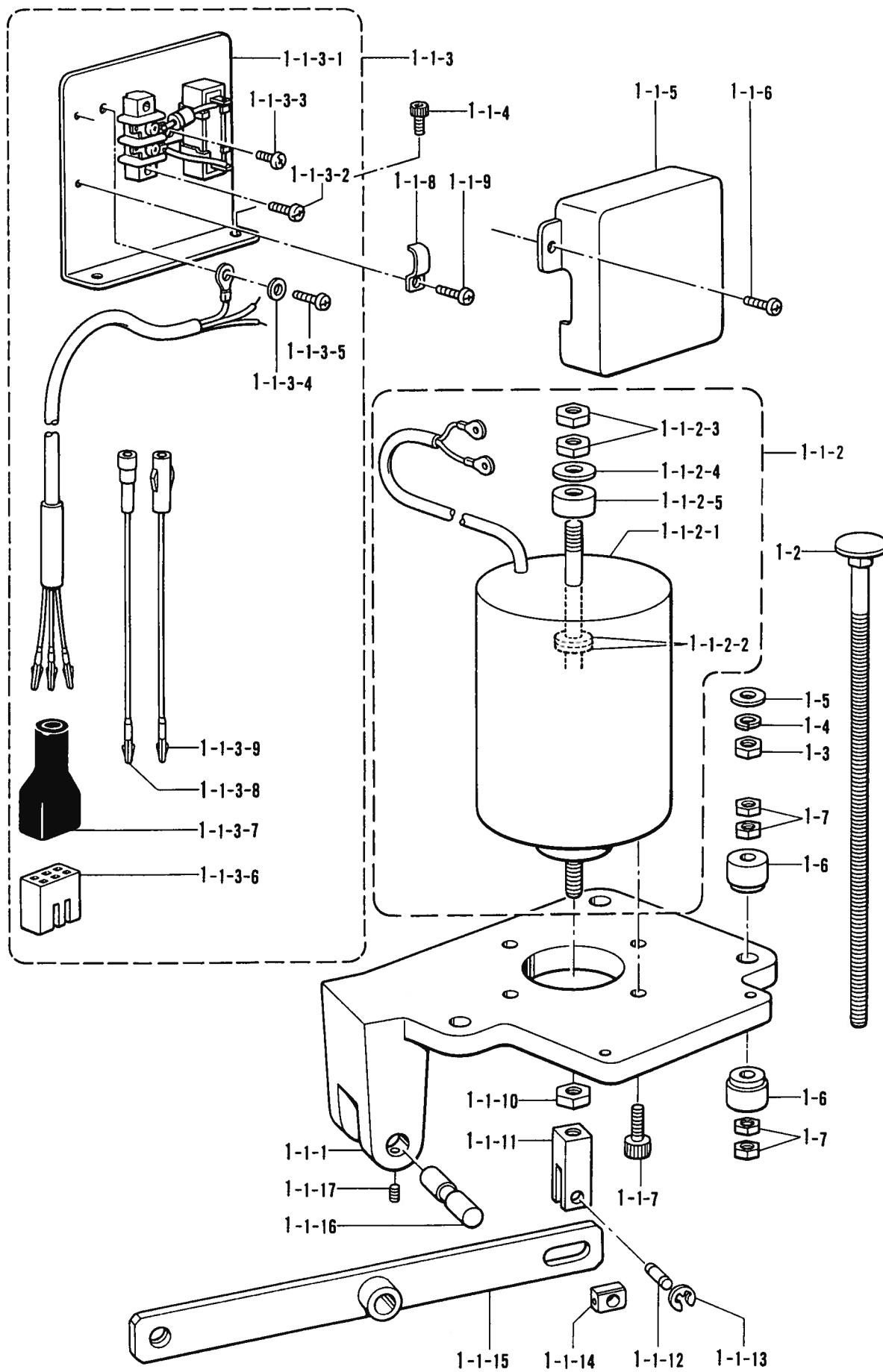
U. 電源押工上ヶ関係 / Presser foot lifting solenoide set / Solenoidsatz für die anhebung des stoffdrücker fußes /
