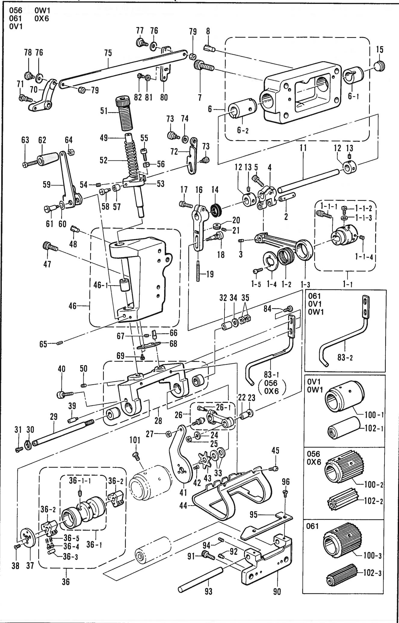
M. プーラー装置関係 / Puller device mechanism / Ziehvorrichtung /
