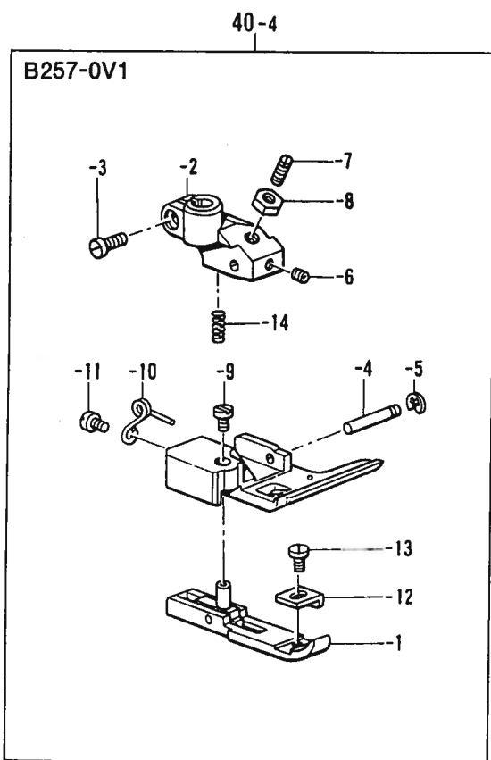
C2. 押工関係/Presser foot mechanism/Stoffdrückerfuß/
