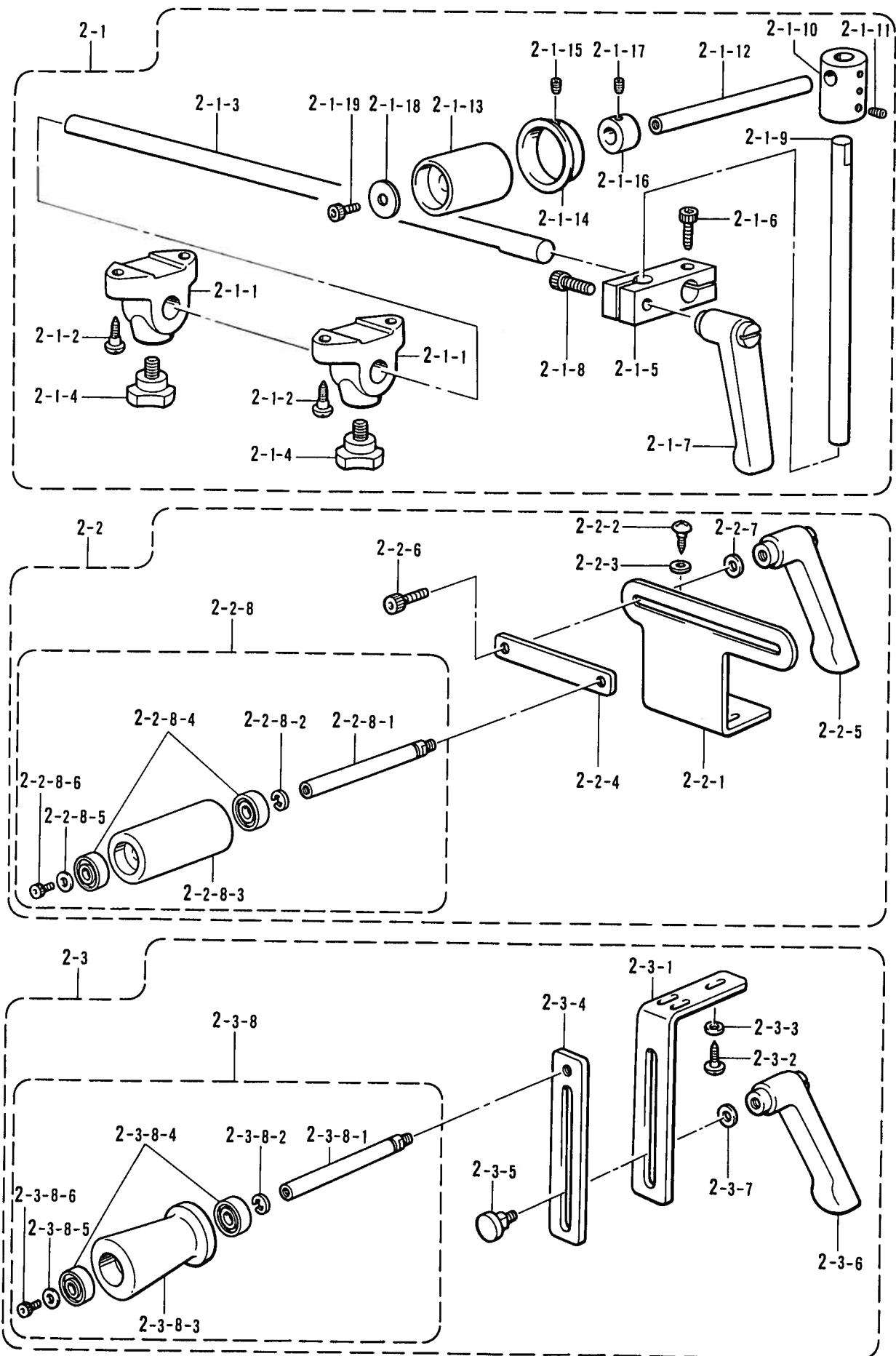
**W2. 布張ローラ装置関係 / Fabric tension roller device set/Stoffspannrollervorrichtung /
