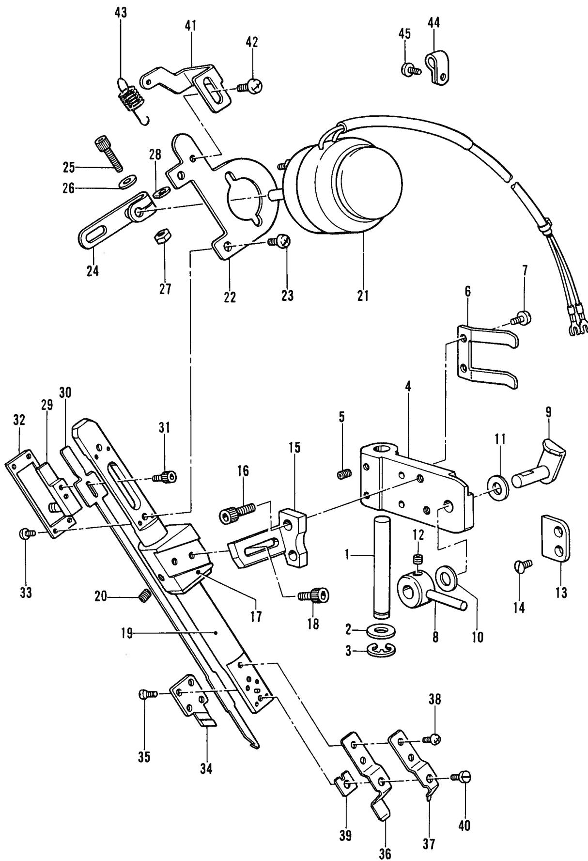
T. 上飾り糸切り関係 /Upper thread trimmer mechanism/Oberfadenabschneider/
