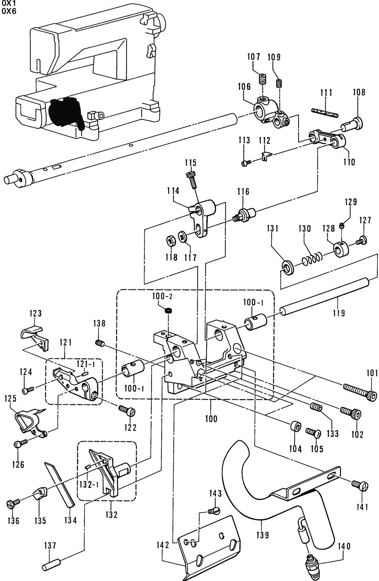
N2. トリミングメス関係 / Trimming knife mechanism / Fadenabschneidemessereinheit /
