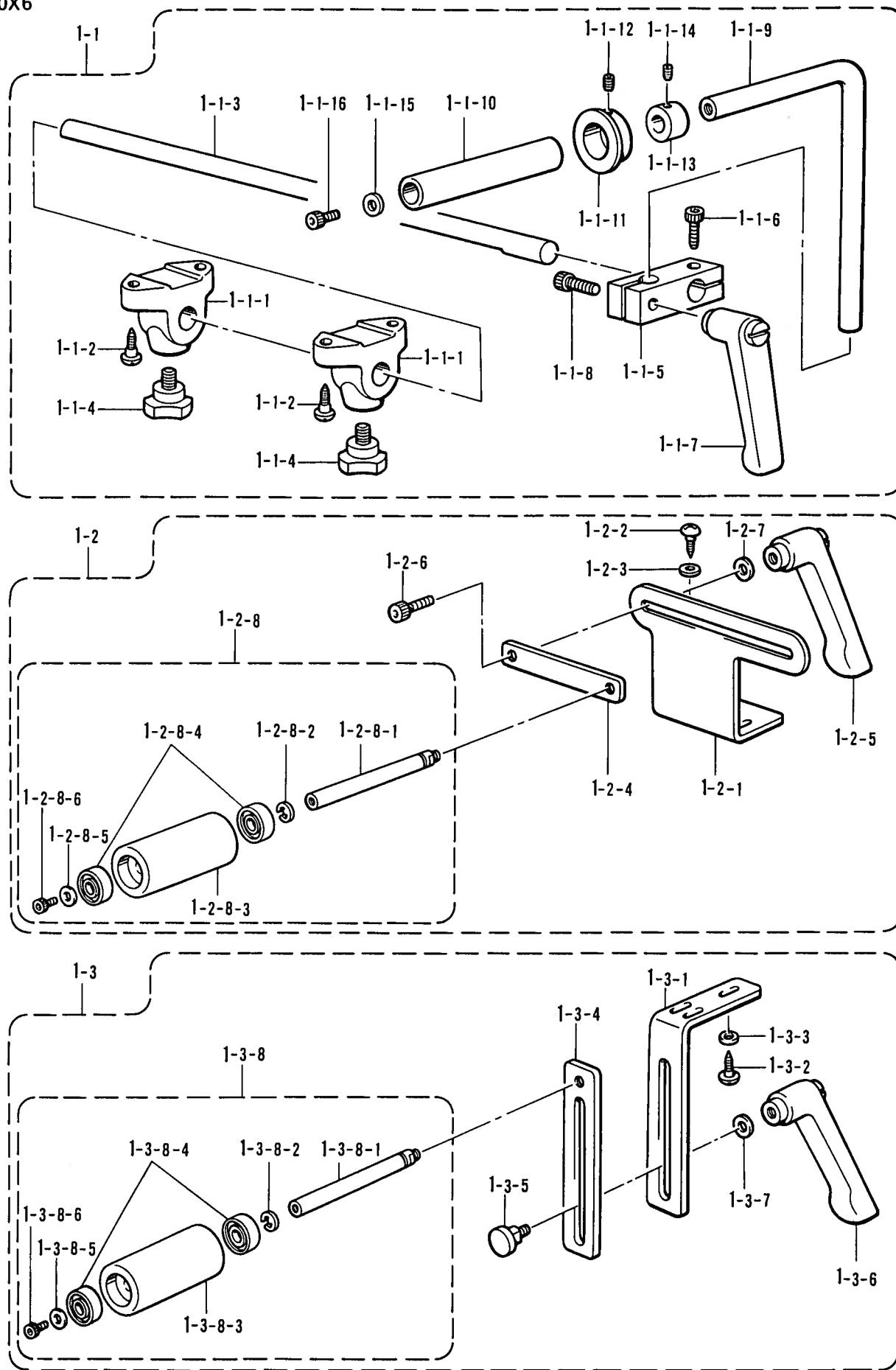
**W1. 布張ローラ装置関係 /Fabric tension roller device set/Stoffspannrollervorrichtung/
