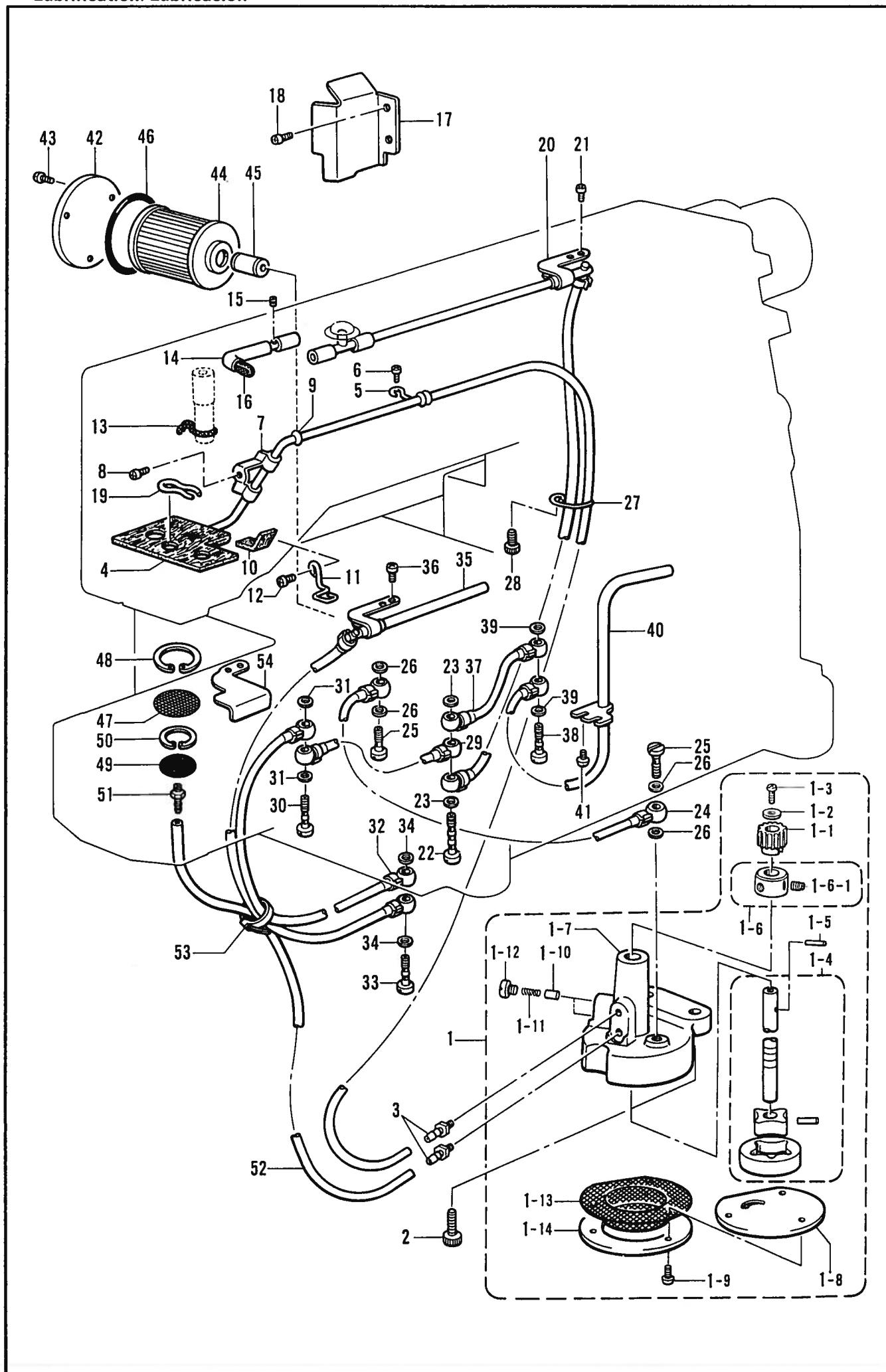
H. 給油潤滑関係 / Lubrication / Schmierung /
