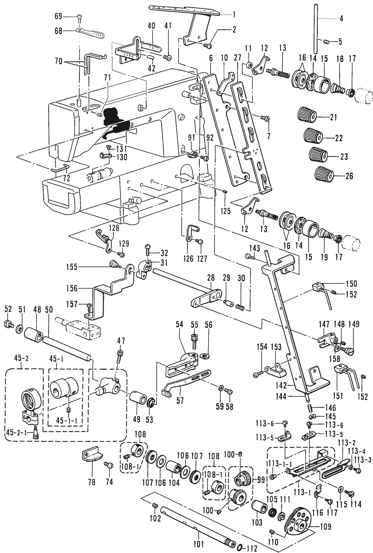
K1. 糸調子関係 (B256) / Thread tension / Faderspannung /
