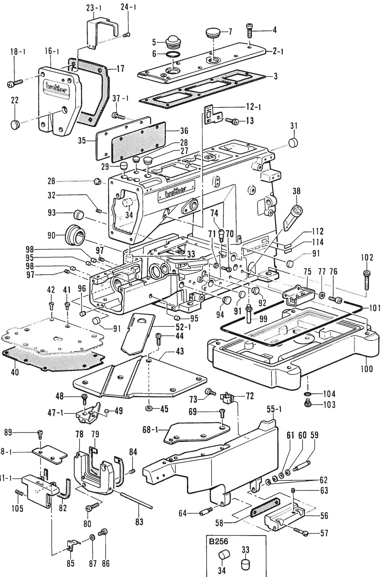
A1. 主体関係/Machine body/Maschinengehäuse/
