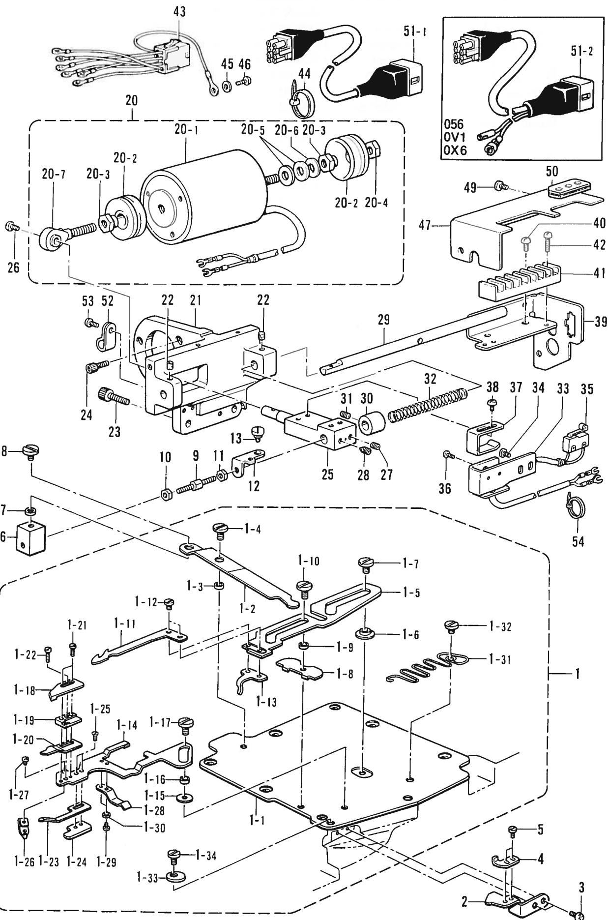
S1. 下飾り糸切り関係 /Lower thread trimmer mechanism/Unterfadenabschneider/
