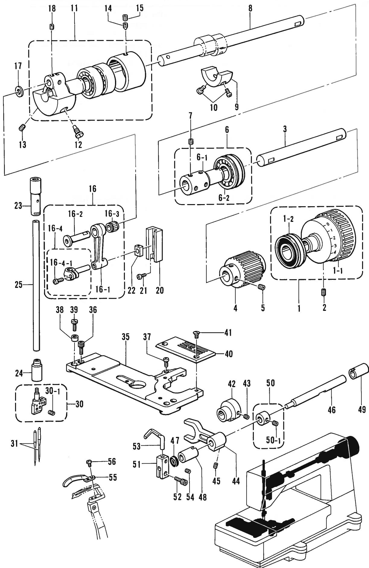
C. 上軸・針棒関係 / Upper shaft and needle bar mechanism / Obere Welle und Nadelstangenvorrichtung / Mécanisme de arbre supérieur et barra à aiguille / Mecanismo del eje superior y la barra de aguja
