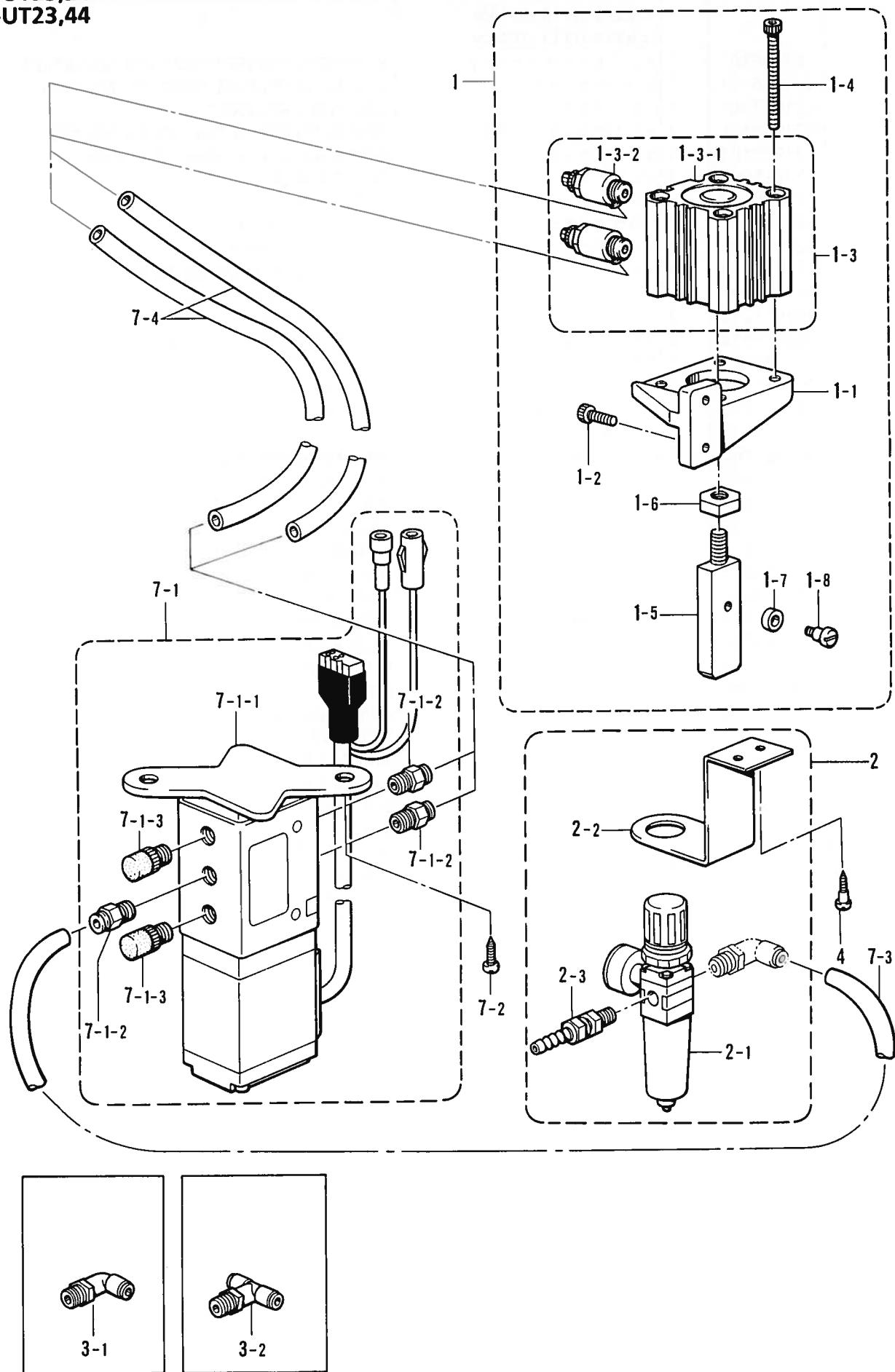
R . エアー押工上ヶ関係 / Pneumatic presser foot lifting mechanism /
