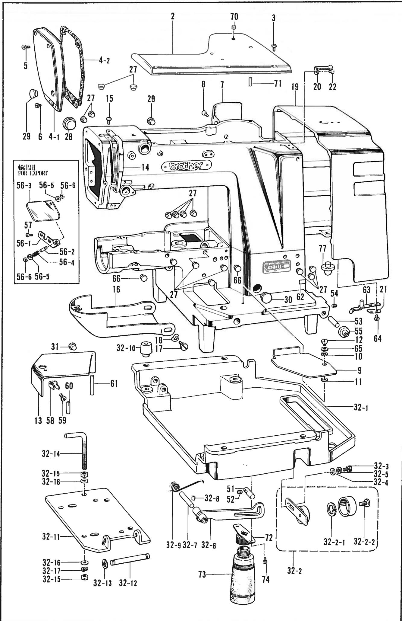
A. 主体関係 / Machine body / Maschinengehäuse / Corps de la machine / Cuerpo de la máquina
