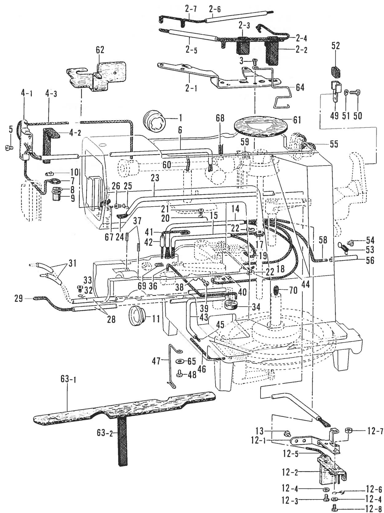
J. 給油潤滑関係 / Lubrication / Schmierung / Lubrification / Lubricación
