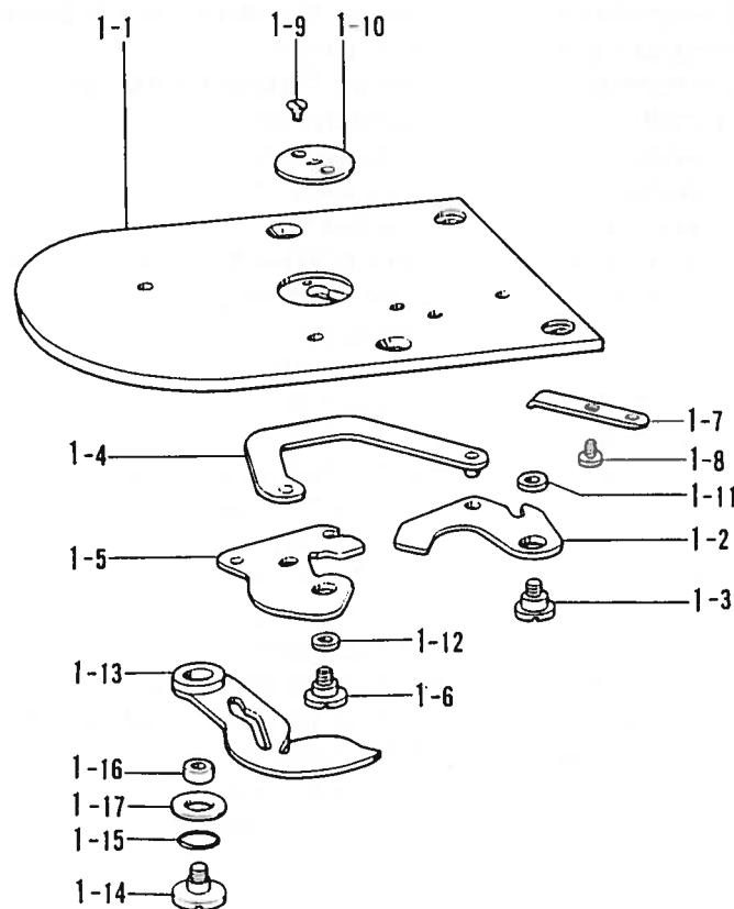
P. 動車・遊車関係 / Drive pulley and idler pulley mechanism / Antriebsriemenscheibe und Riemenscheibe / Mécanisme de poulie d'entraînement et poulie folle / Mecanismo de polea impulsora y polea tensora
