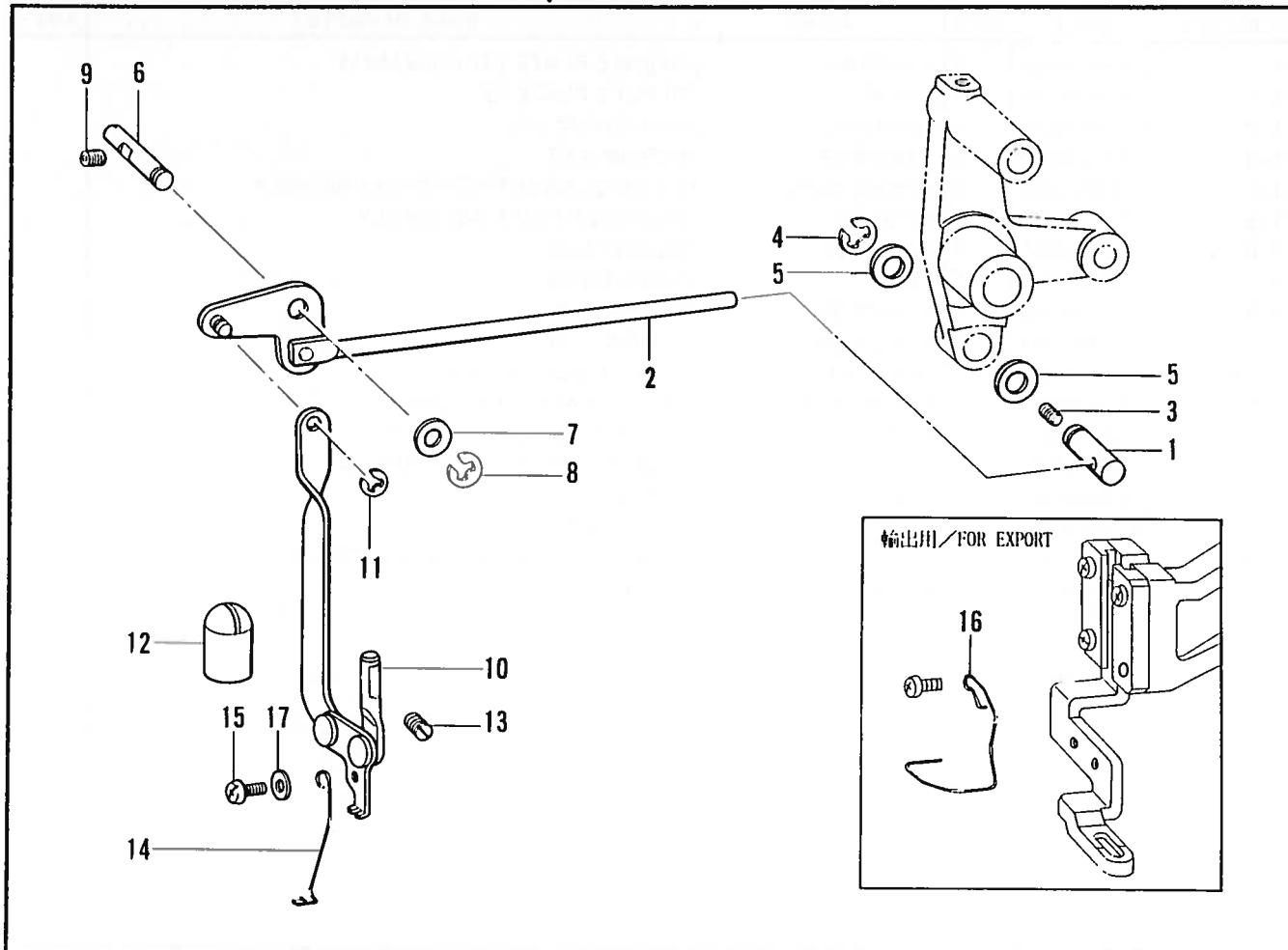
R. 糸締め関係 / Thread nipper mechanism / Fadenspannvorrichtung /
