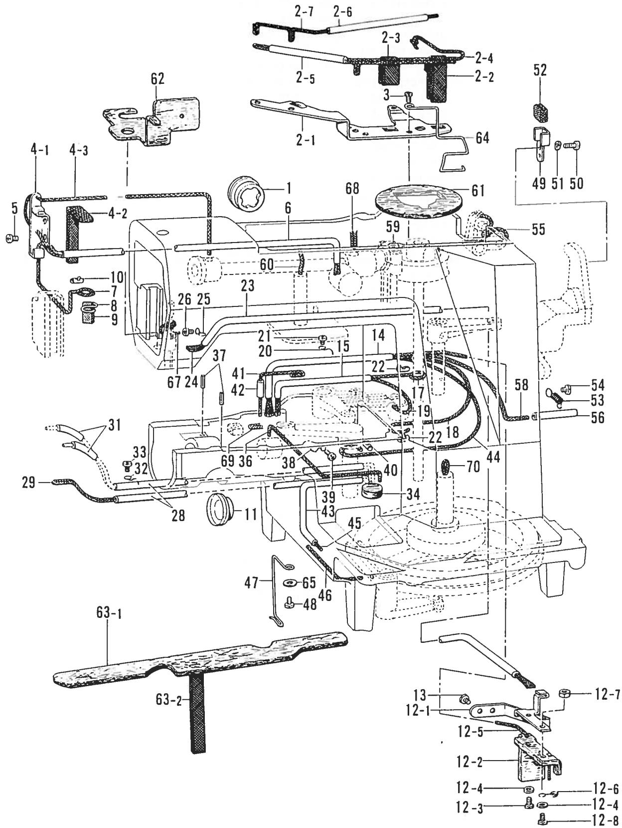
J. 給油潤滑関係 / Lubrication/Schmierung/Lubrification/Lubricación
