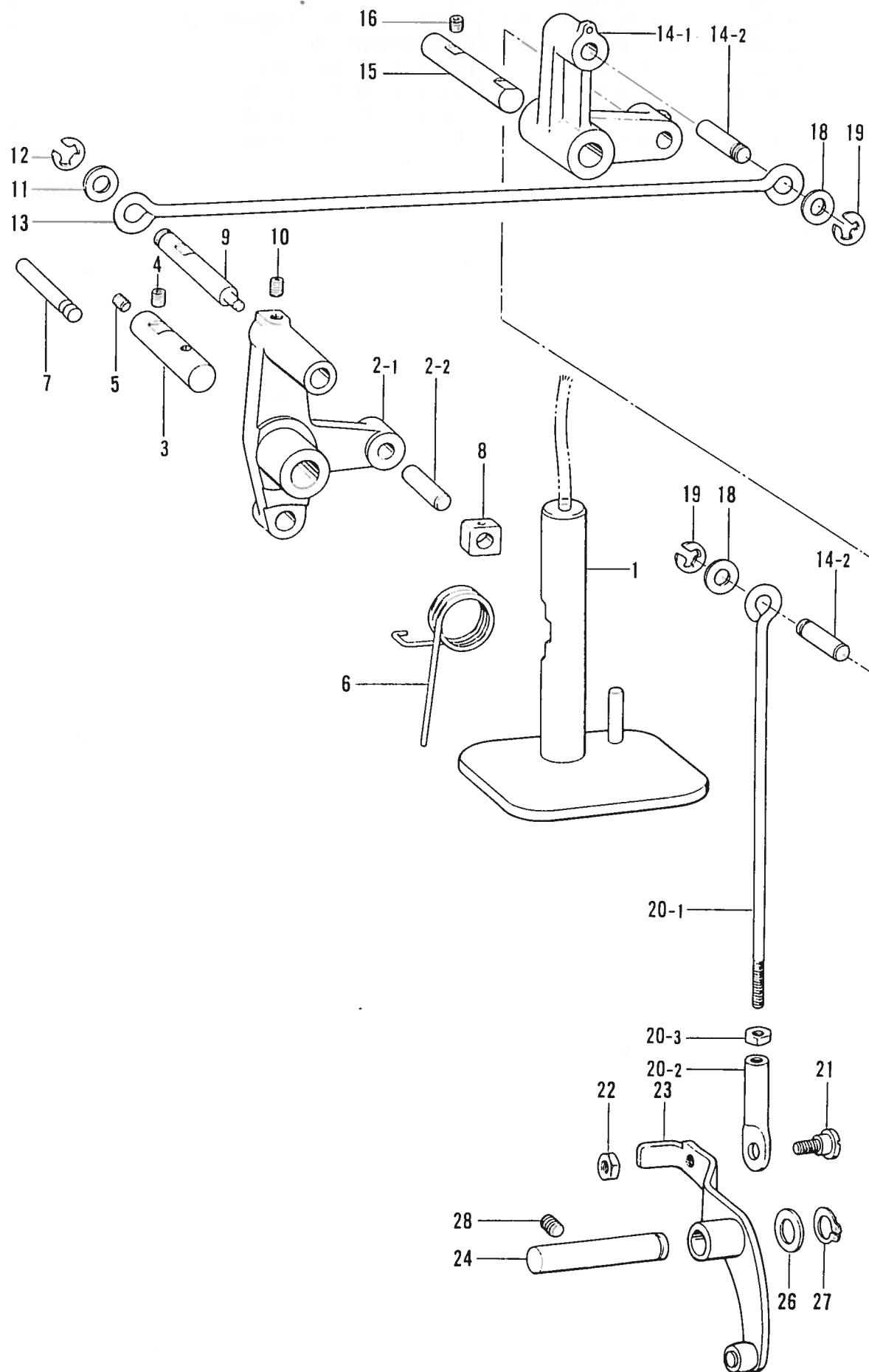
**E. 押工上ヶ関係 / Work clamp lifter mechanism/Stoffhalterhebervorrichtung /
