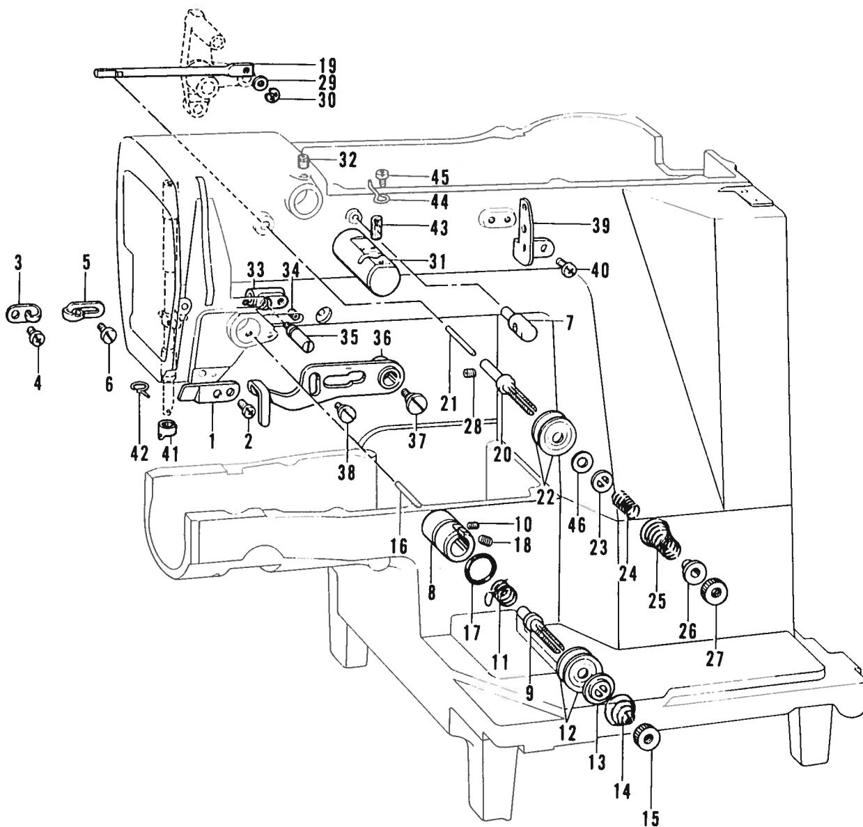
K. 糸通シ関係 / Threading mechanism / Fadenführungs vorrichtung /
