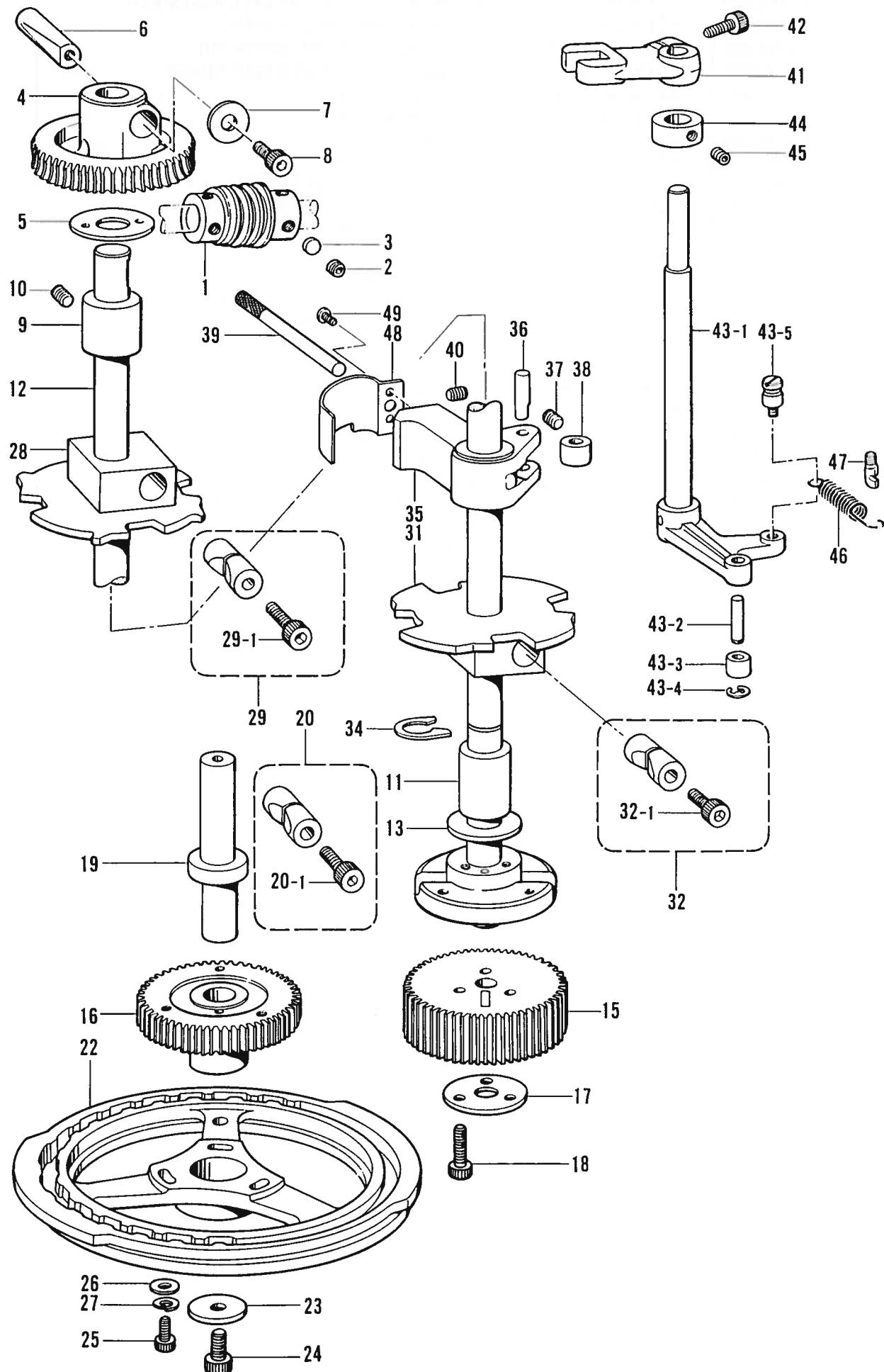
F. カム伝導関係 / Vertical shaft mechanism / Vertikale Welle /
