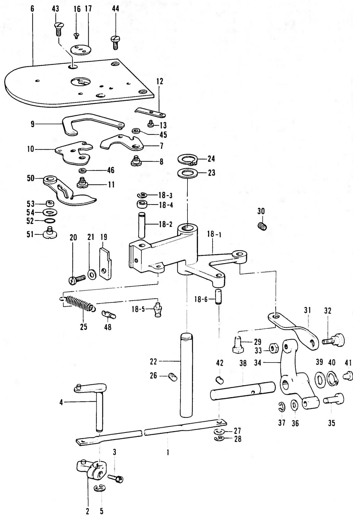
N. 糸切り関係 / Thread trimmer mechanism / Fadenabschneidevorrichtung /
