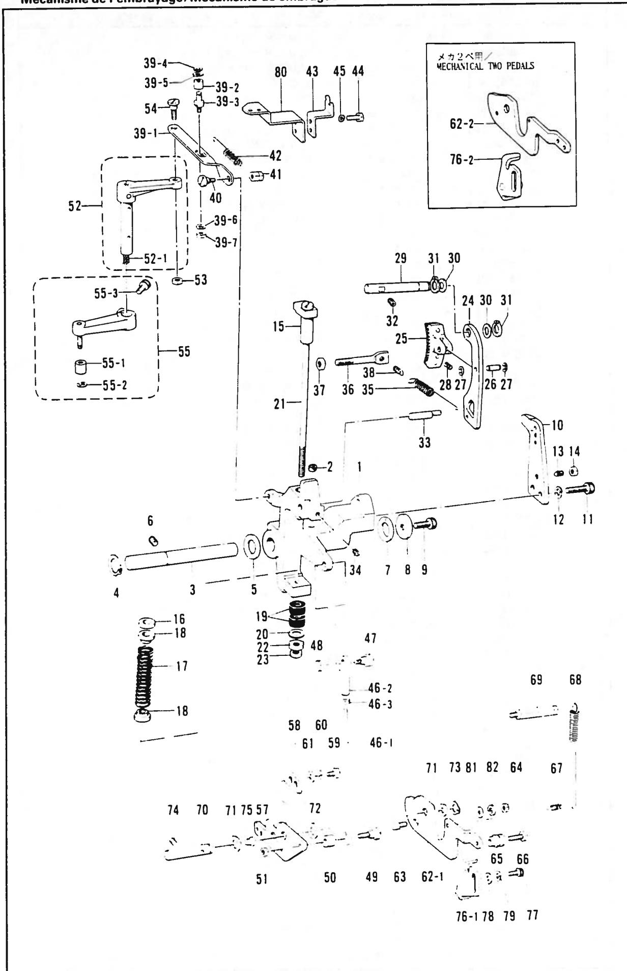
B. クラッチ関係/Clutch mechanism/Kupplungsvorrichtung/
