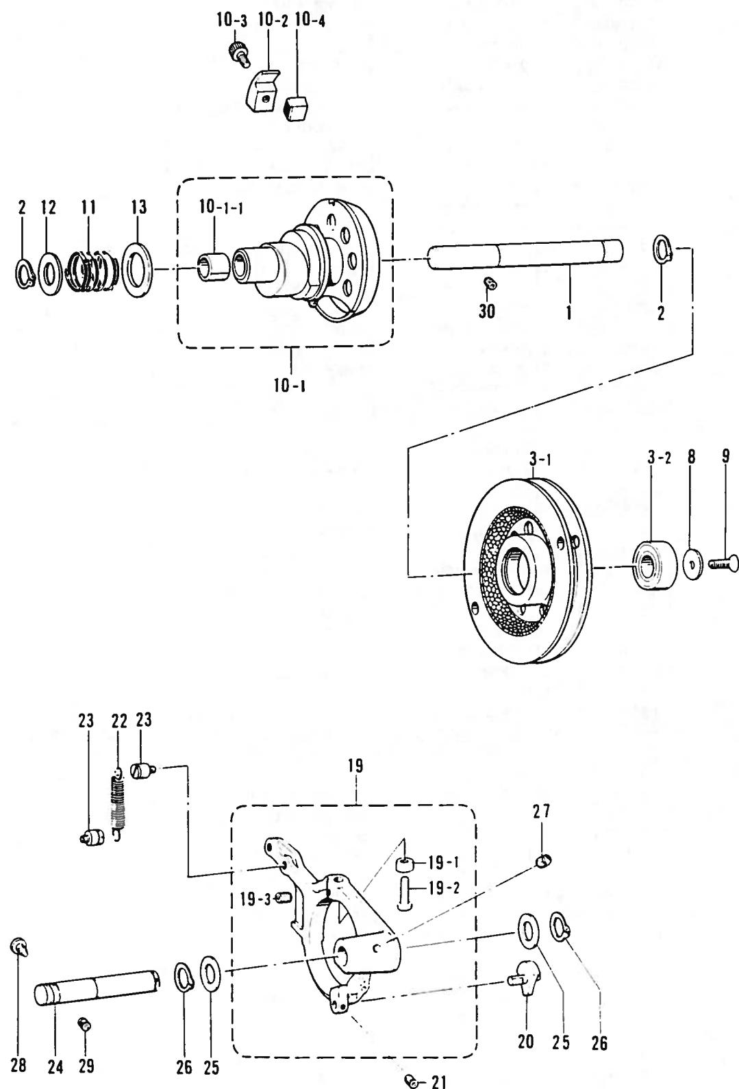
H. パワー押工関係 /Power shaft mechanism/Heberbetätigungs vorrichtung/
