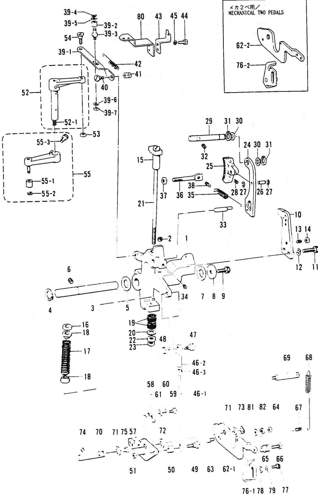
B. クラッチ関係/Clutch mechanism/Kupplungsvorrichtung/
