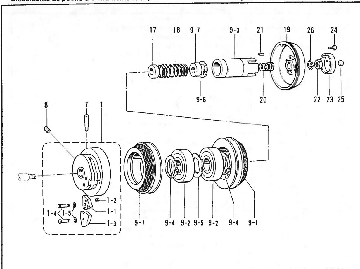
D. 動車遊車関係 / Drive pulley and idler pulley mechanism / Antriebsriemenscheibe und Riemscheibe /
