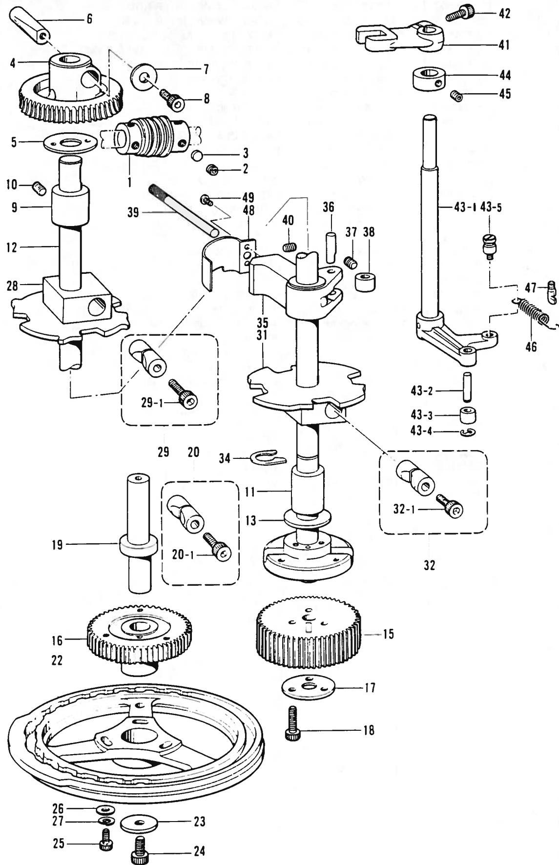
G. カム伝導関係 / Vertical shaft mechanism / Vertikale Welle /
