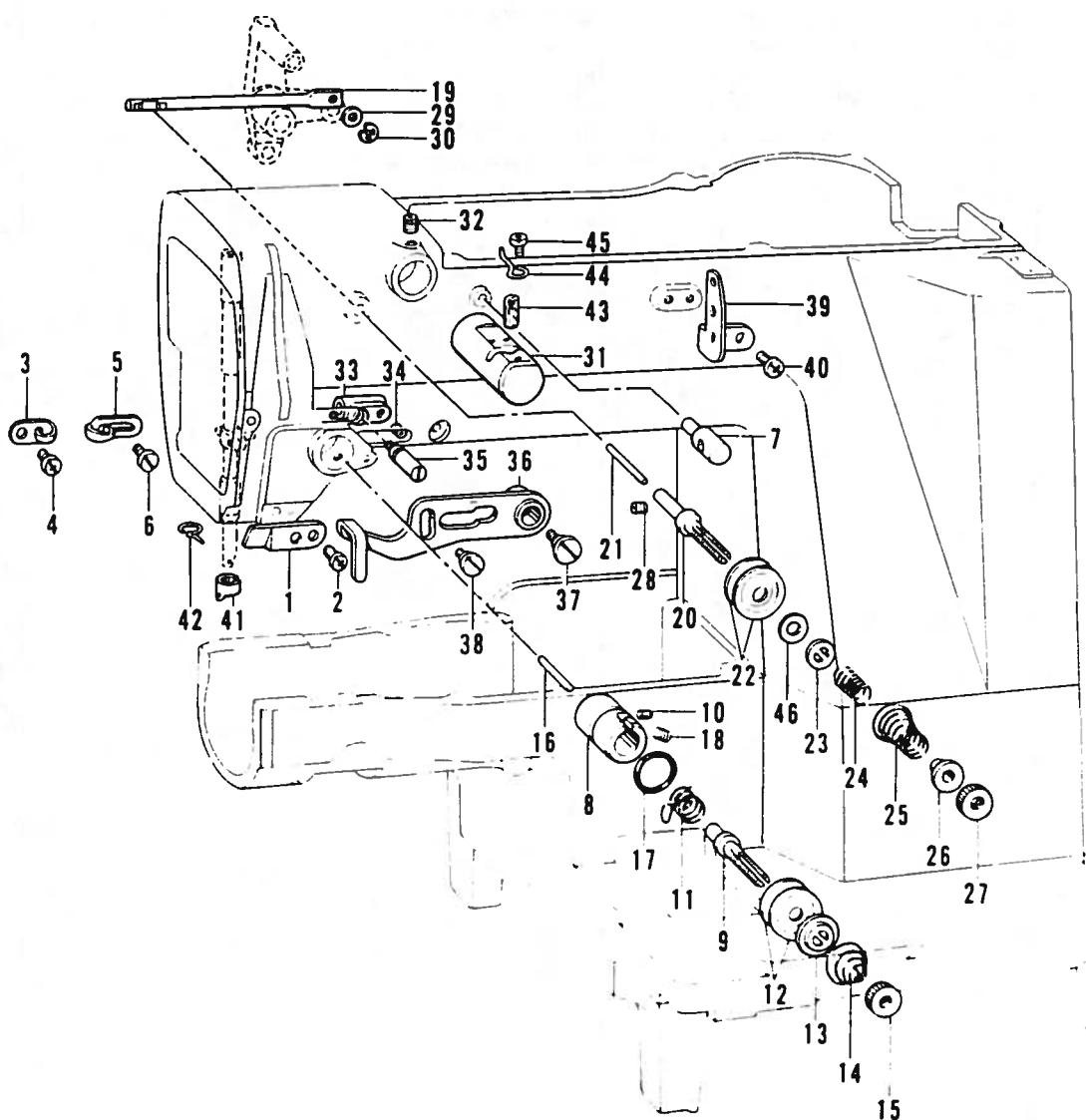
L. 糸通シ関係/Threading mechanism/Fadenführungs vorrichtung/
