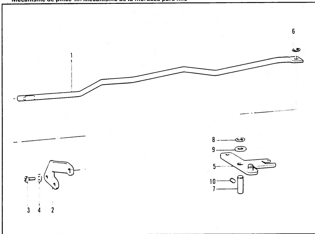
P. 糸扱い関係 / Thread wiper mechanism / Fadenwischvorrichtung /
