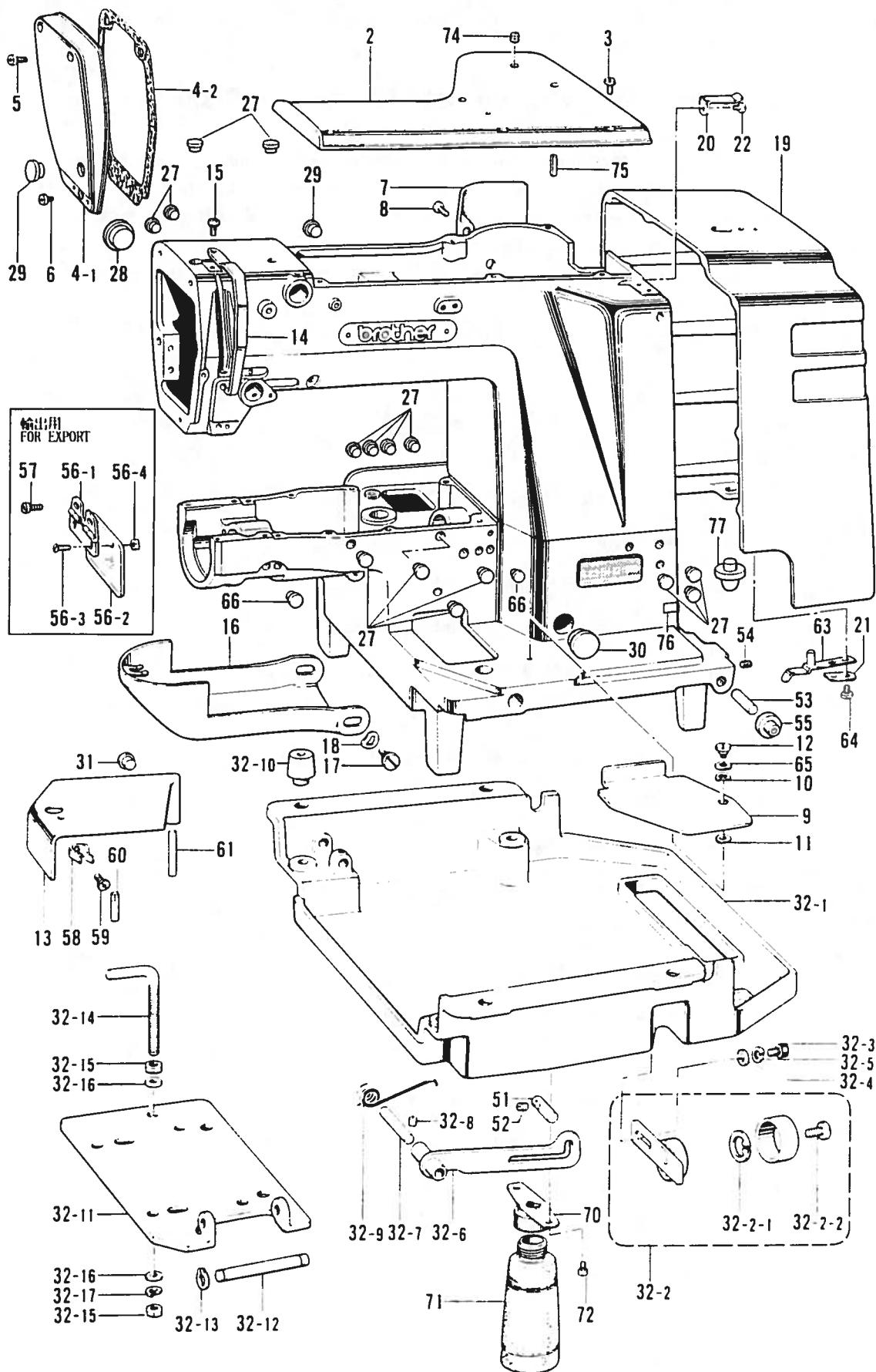
A. 主体関係 /Machine body/Maschinengehäuse/
