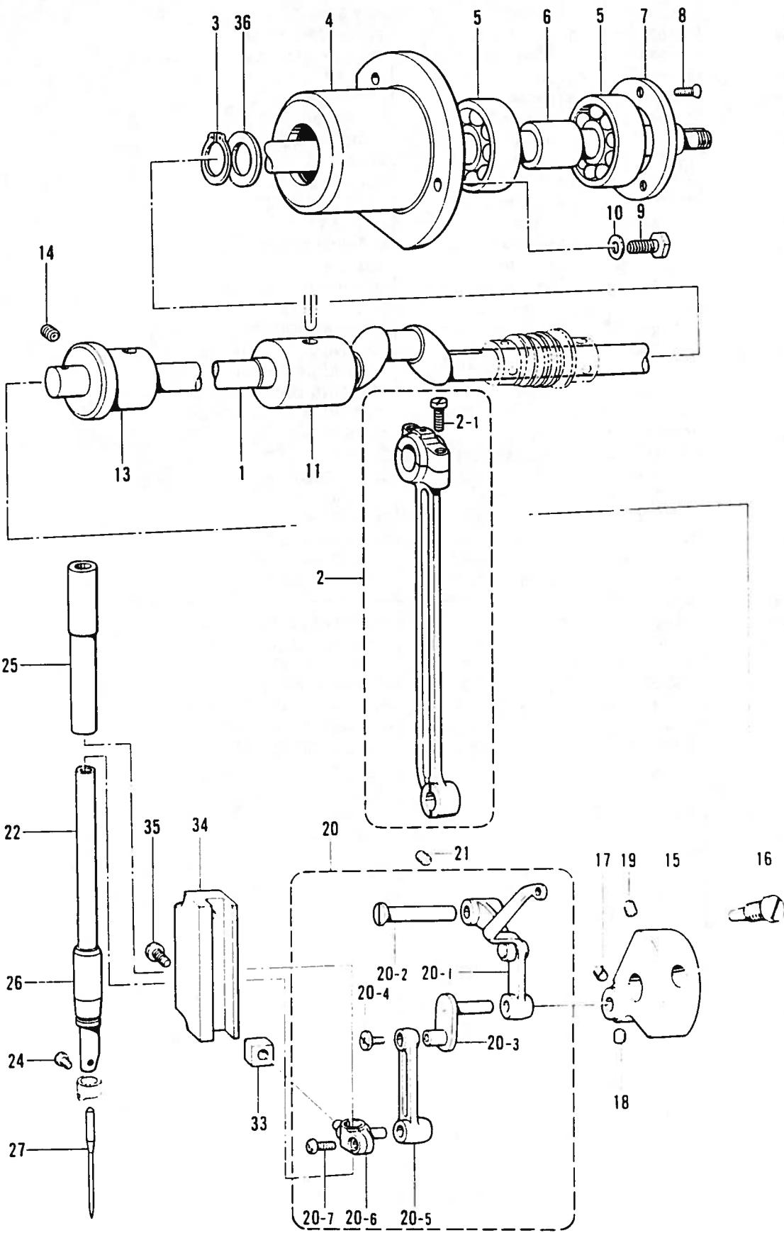
C. 上軸・針棒関係 /Upper shaft and needle bar mechanism /Obere Welle und Nadelstangenvorrichtung /
