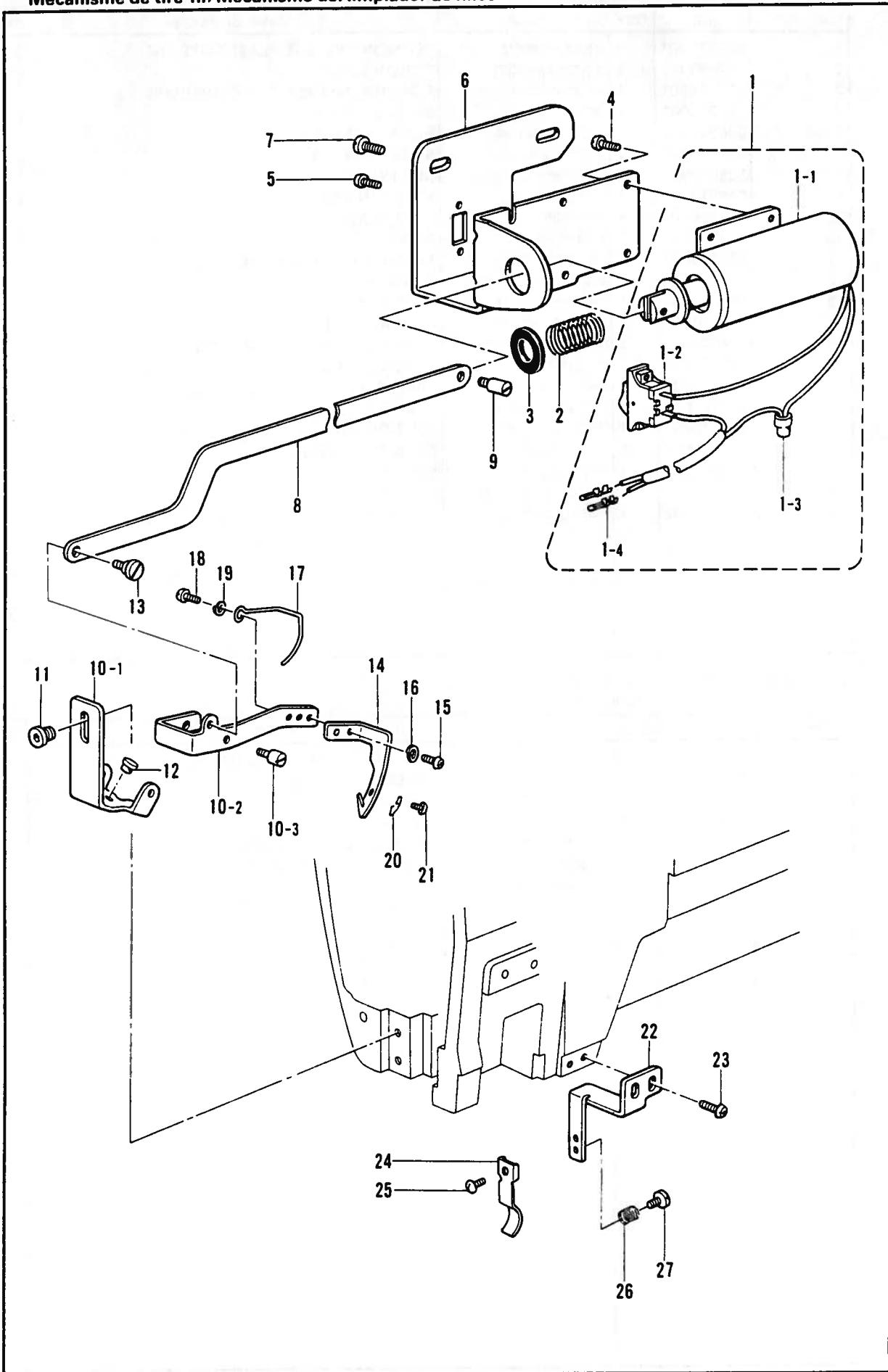
P. 糸拭イ関係/Thread wiper mechanism/Fadenwischvorrichtung/
