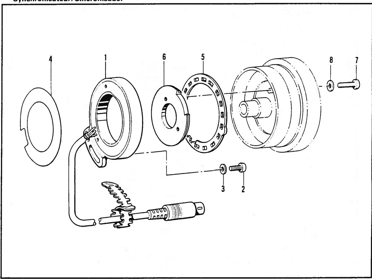
M. テンションリリース関係 / Tension release mechanism / Spannungsverminderungsvorrichtung /
