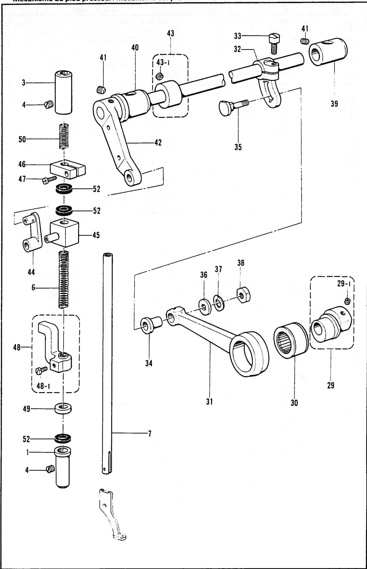
D. 押工関係/Presser foot mechanism/Stoffdrückerfuß/
