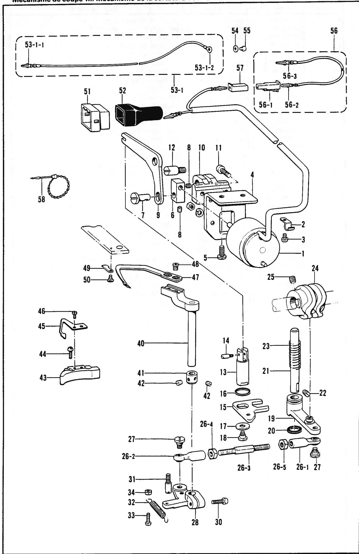
L. 糸切り関係 / Thread trimmer mechanism / Fadenabschneidevorrichtung /
