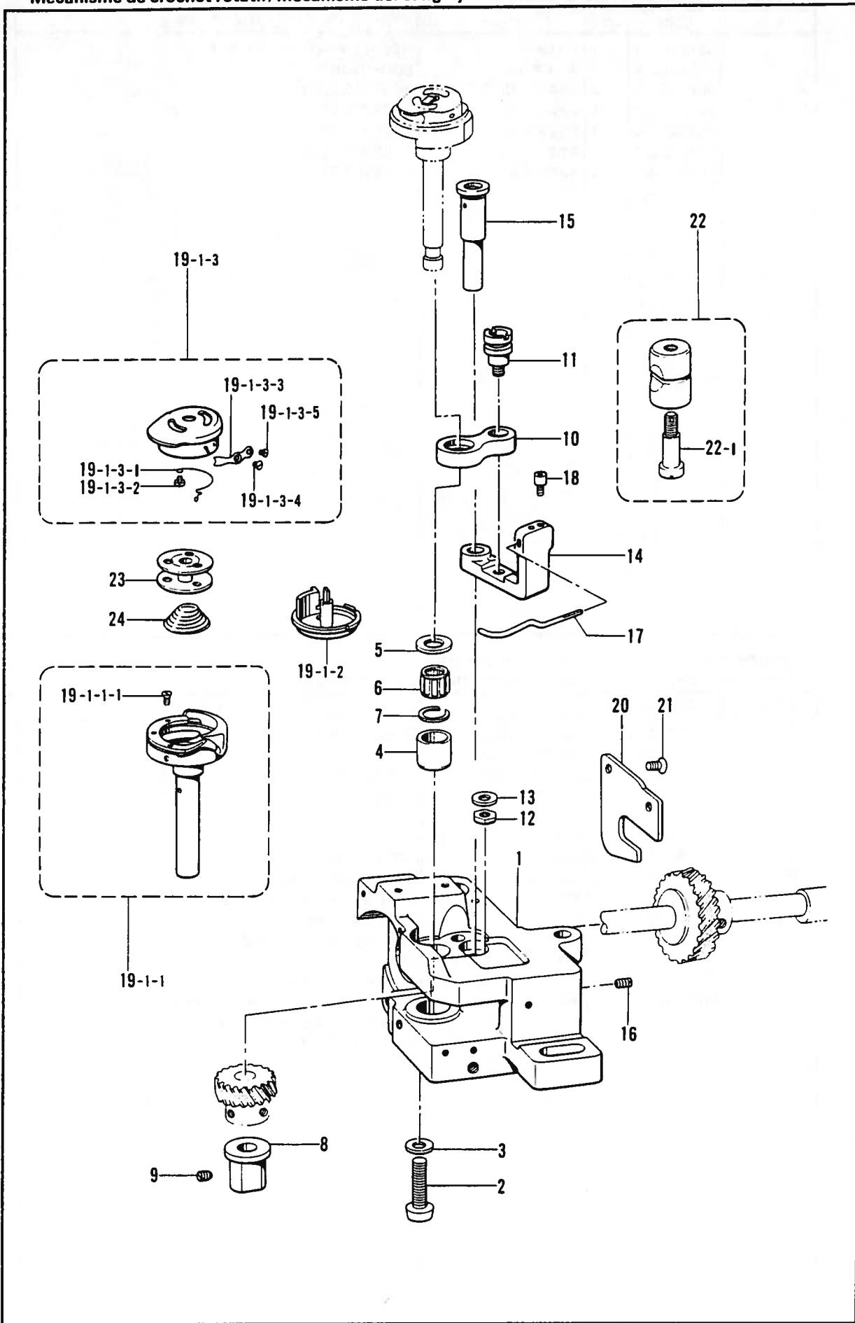
G. カマ関係 / Rotary hook mechanism / Greifervorrichtung /
