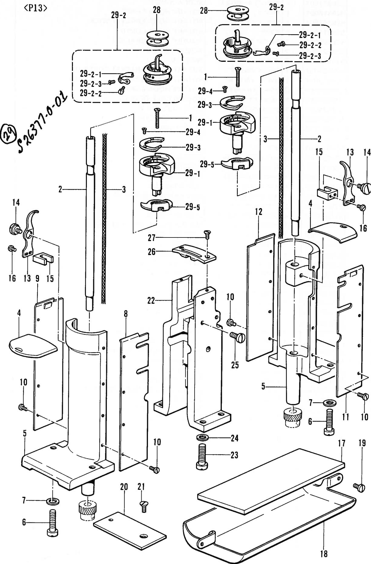
J2. カマ関係 /Rotary hook mechanism/Greifervorrichtung/
