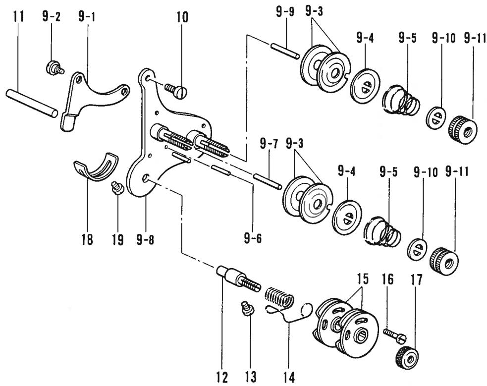
H2. 糸調子関係 / Thread tension/Faderspannung/
