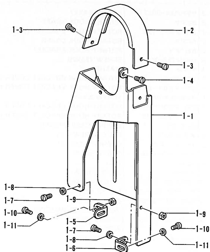
K. ベルトカバー関係（オプションパーツ）/Belt cover mechanism (Option parts)/Gurtabdeckung (Sonderzubehör)/
