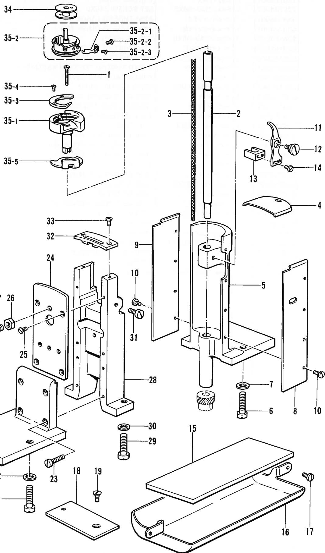
J1. カマ関係 /Rotary hook mechanism/Greifervorrichtung/
