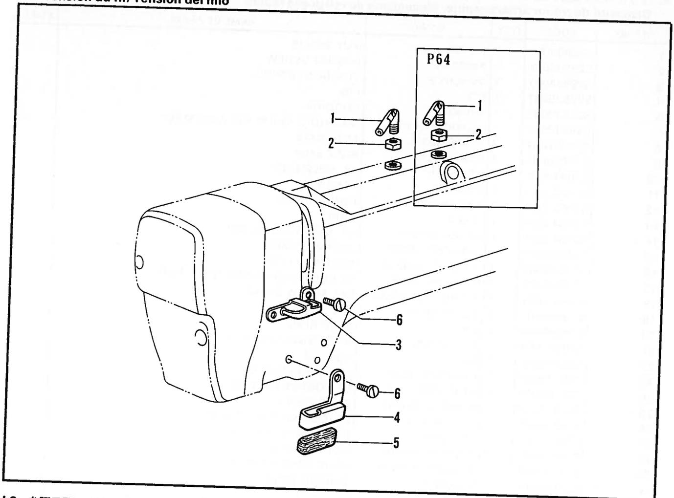
L2. 糸調子関係 / Thread tension / Faderspannung /
