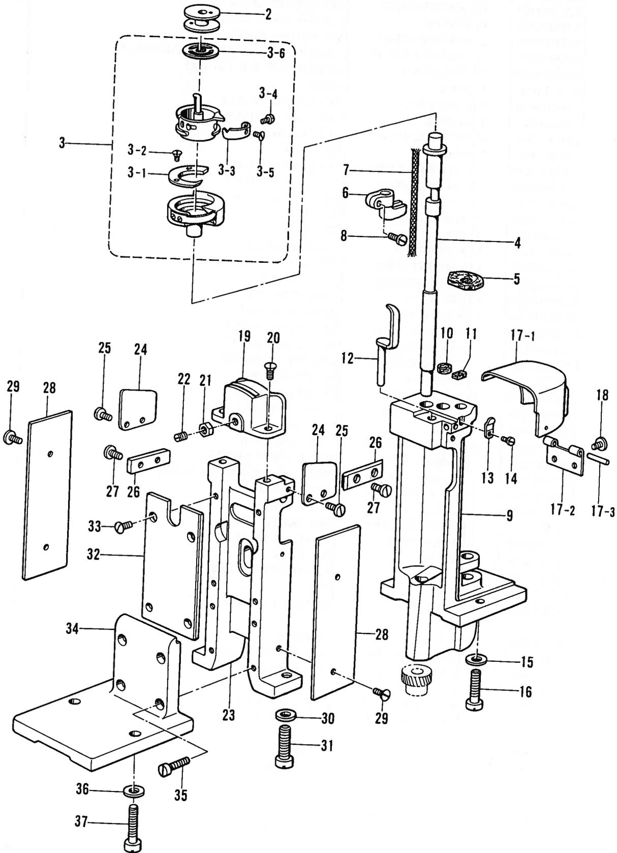
J1. カマ関係/Rotary hook mechanism/Greifervorrichtung/
