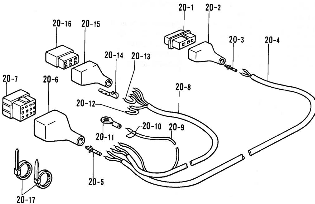
N. 糸切り・タッチバック関係 / Thread trimmer and quick back mechanism / Fadenabschneider und Schnellumkehrvorrichtung / Mécanisme de coupe-fil et retour arrière rapide / Mecanismo de la cortadura de hilos y retroceso rápido
