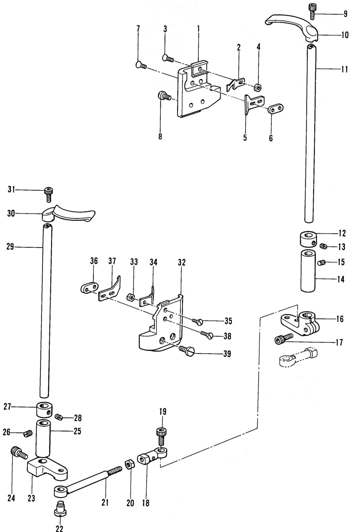
M1. 糸切り関係/Thread trimmer mechanism/Fadenabschneidevorrichtung/
