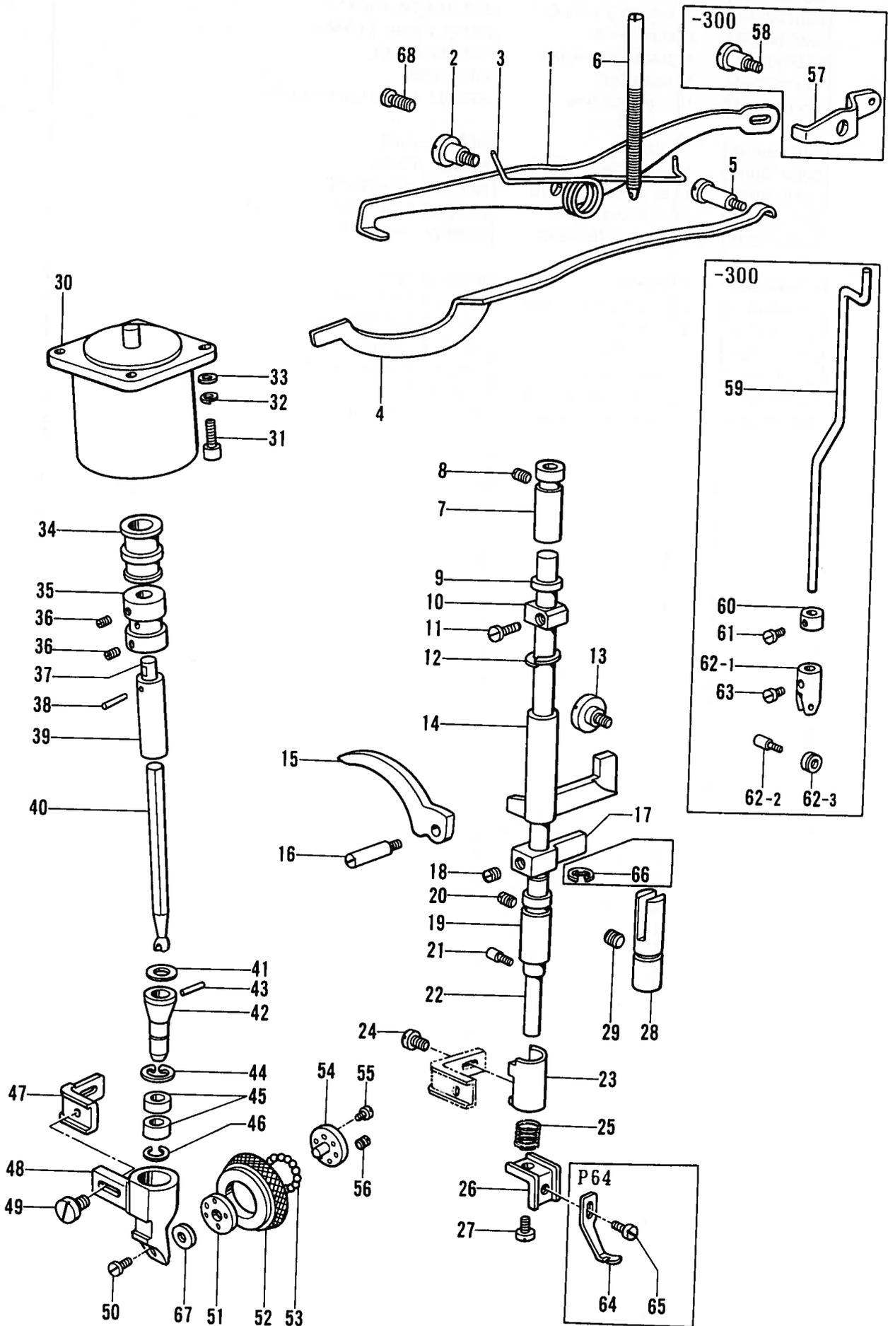
D. 押工関係/Presser foot mechanism/Stoffdrückerfuß/
