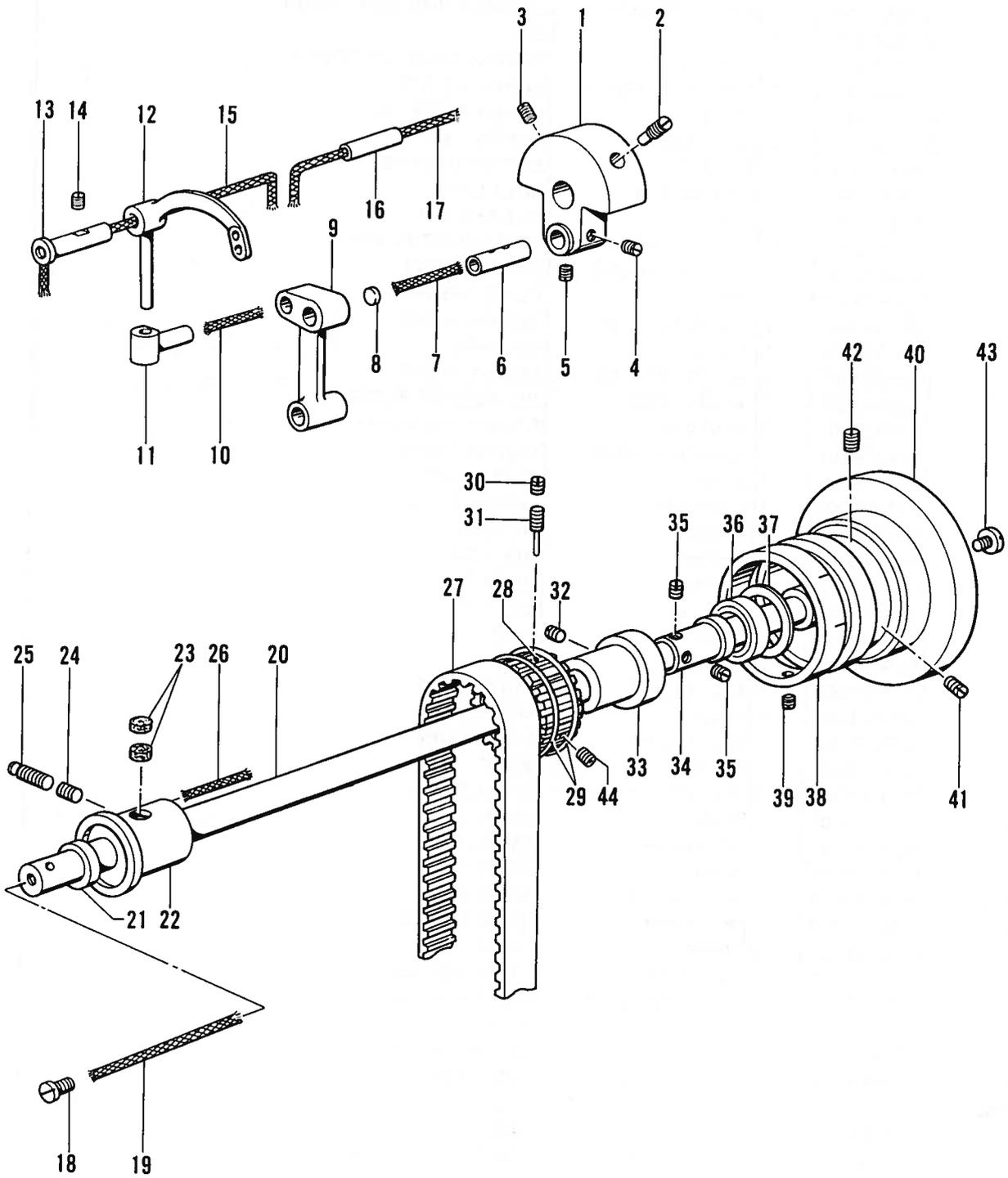
B. 上軸天ビン関係 / Upper shaft and thread take-up mechanism / Obere Welle und Fodenabnahmevorrichtung /
