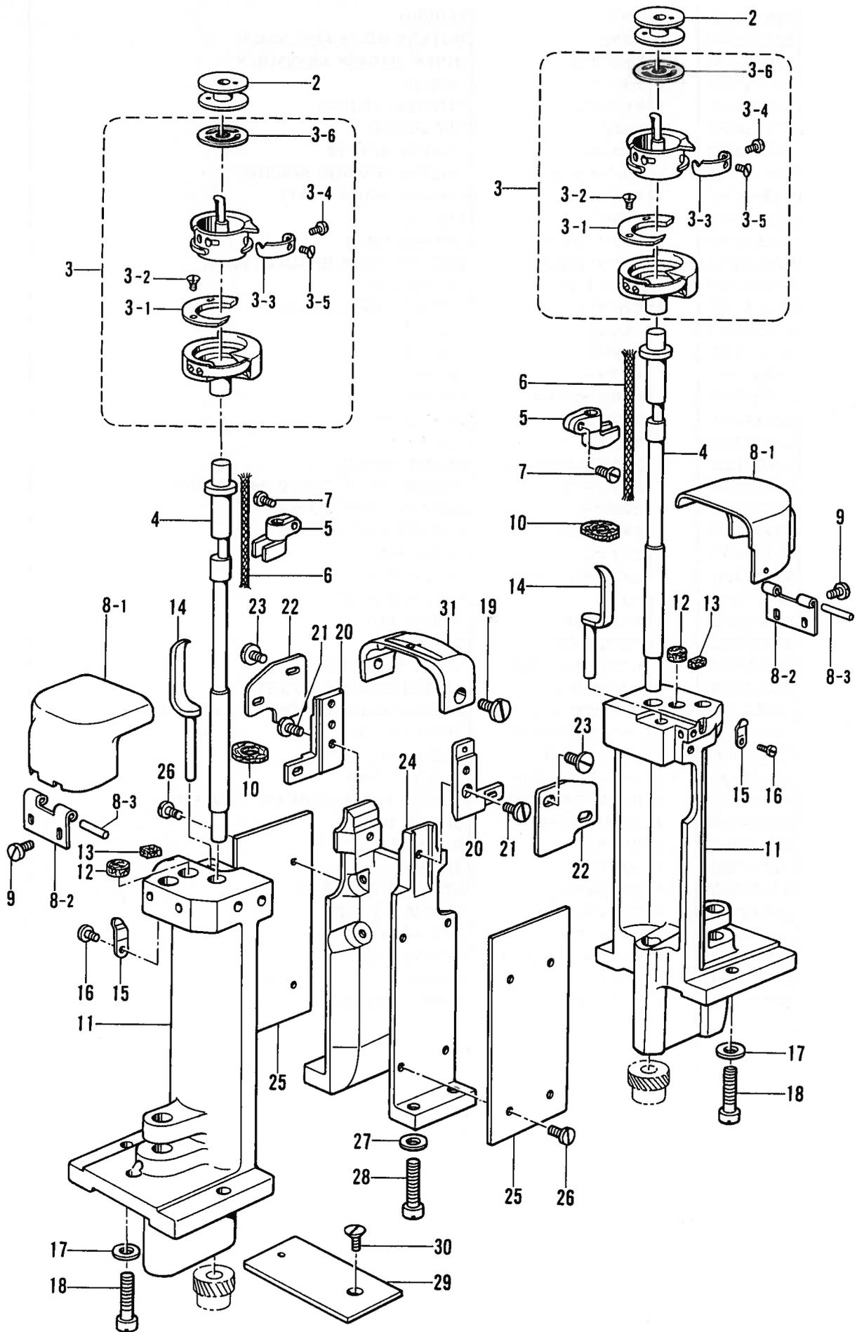
J2. カマ関係/Rotary hook mechanism/Greifervorrichtung/
