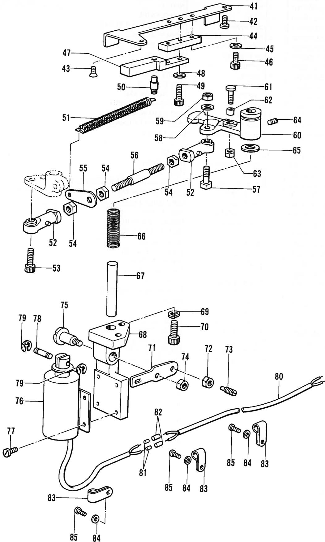
M2. 糸切り関係/Thread trimmer mechanism/Fadenabschneidevorrichtung/
