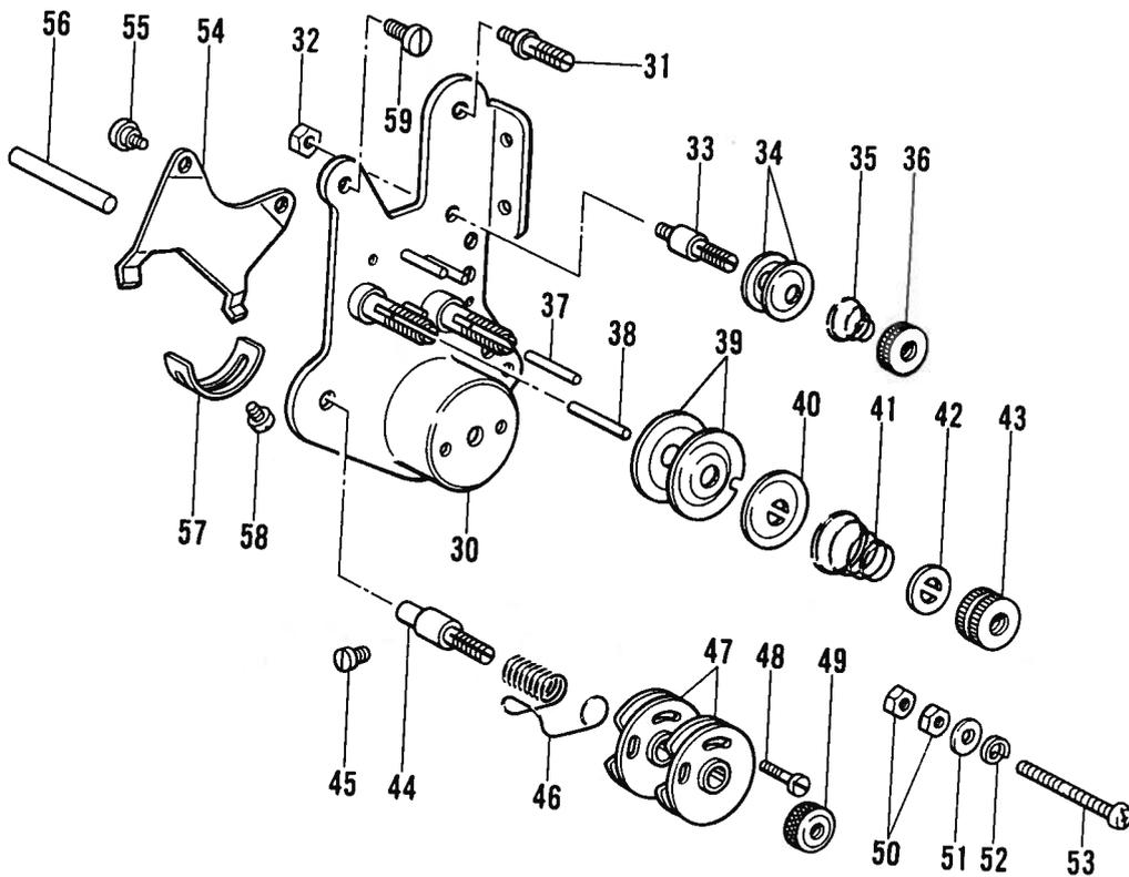
L3. 糸調子関係/Thread tension/Faderspannung/
