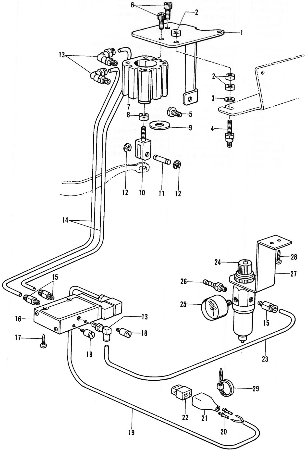
E. 押工上ゲ関係/Work clamp lifter mechanism/Stoffhalterhebevorrichtung/
