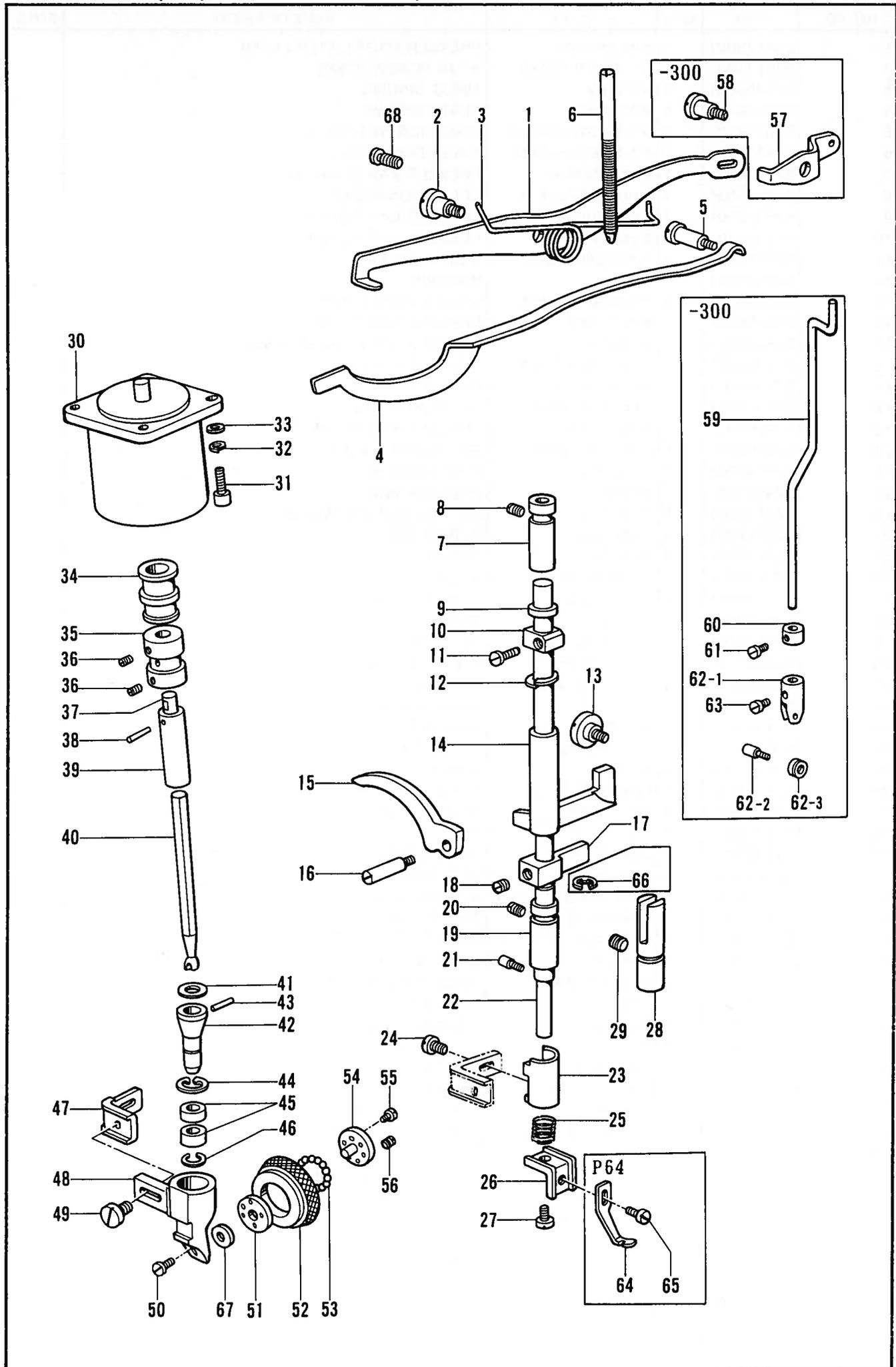
D. 押工関係/Presser foot mechanism/Stoffdrückerfuß/
