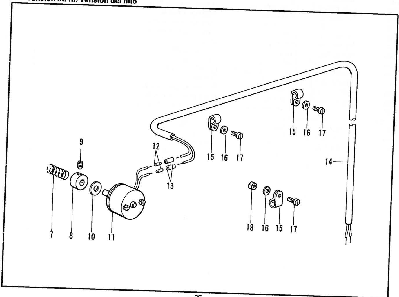
L1. 糸調子関係 / Thread tension / Faderspannung /
