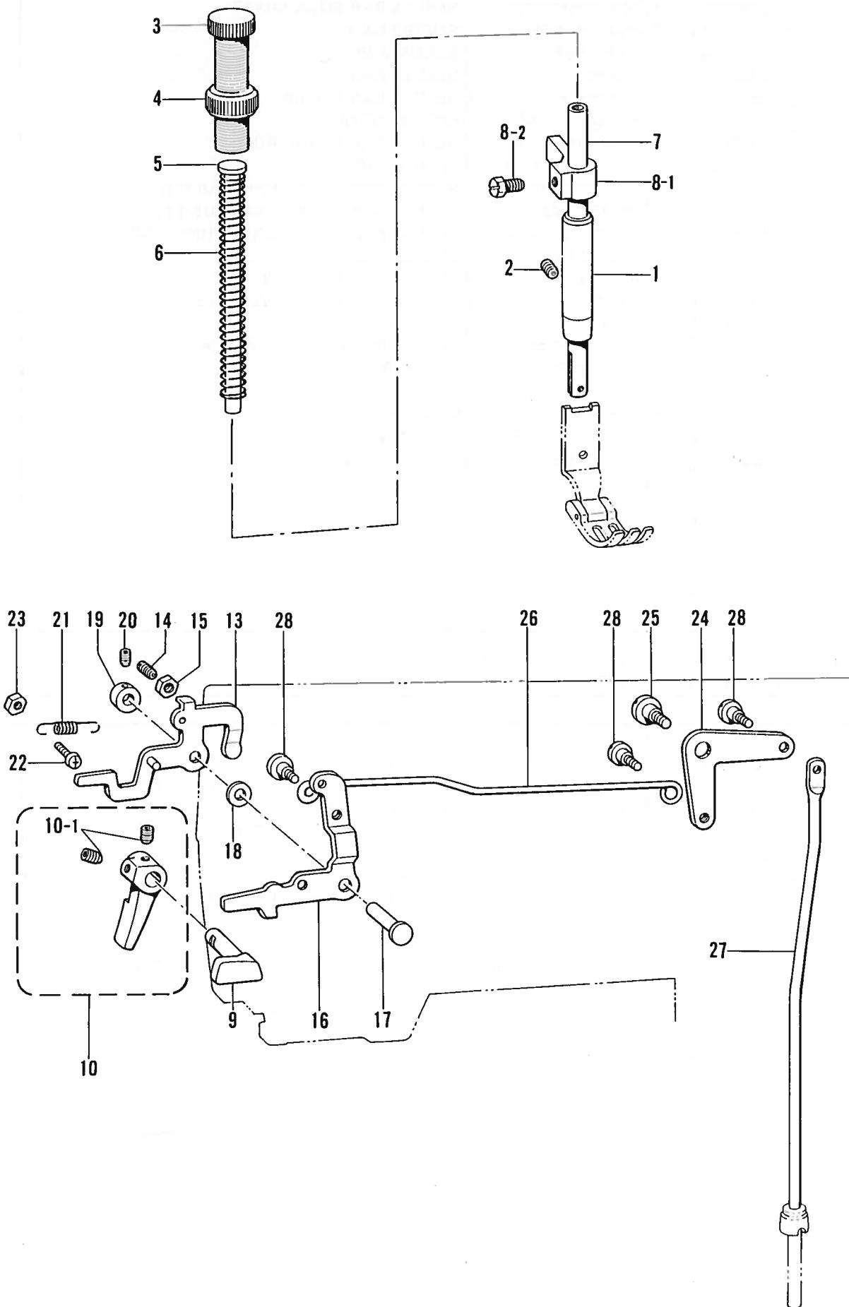
E. 押工関係/Presser foot mechanism/Stoffdrückerfuß/
