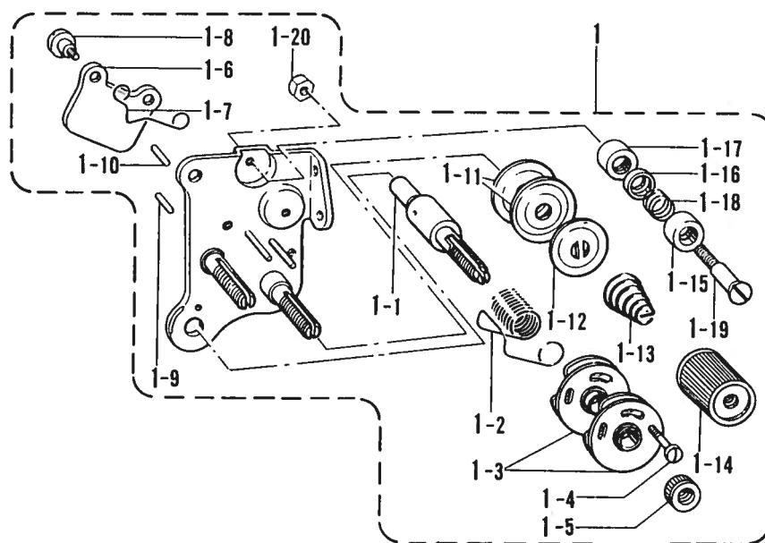
M. 糸通シ関係/Threading mechanism/Fadenführungs vorrichtung/
