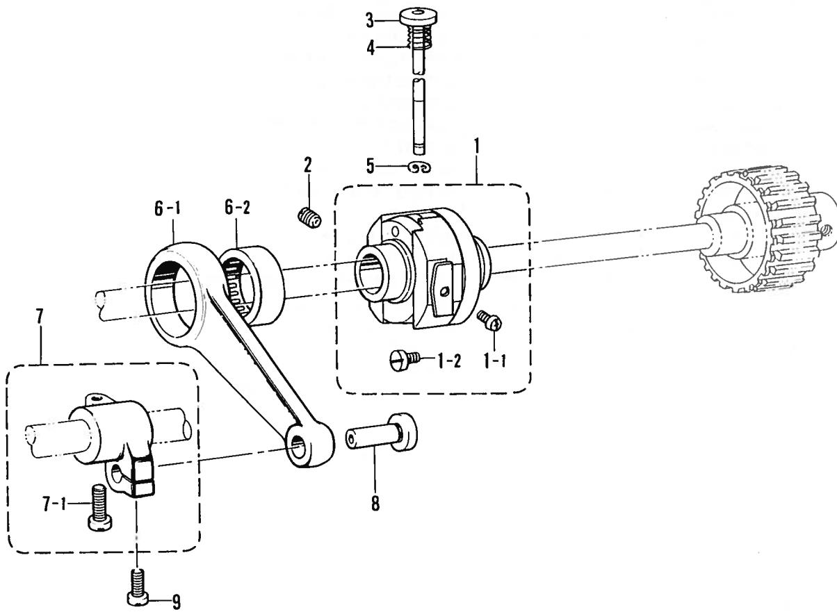
C. 針棒振動関係 /Needle bar rocking mechanism /Nadelstangenbetägigung /
