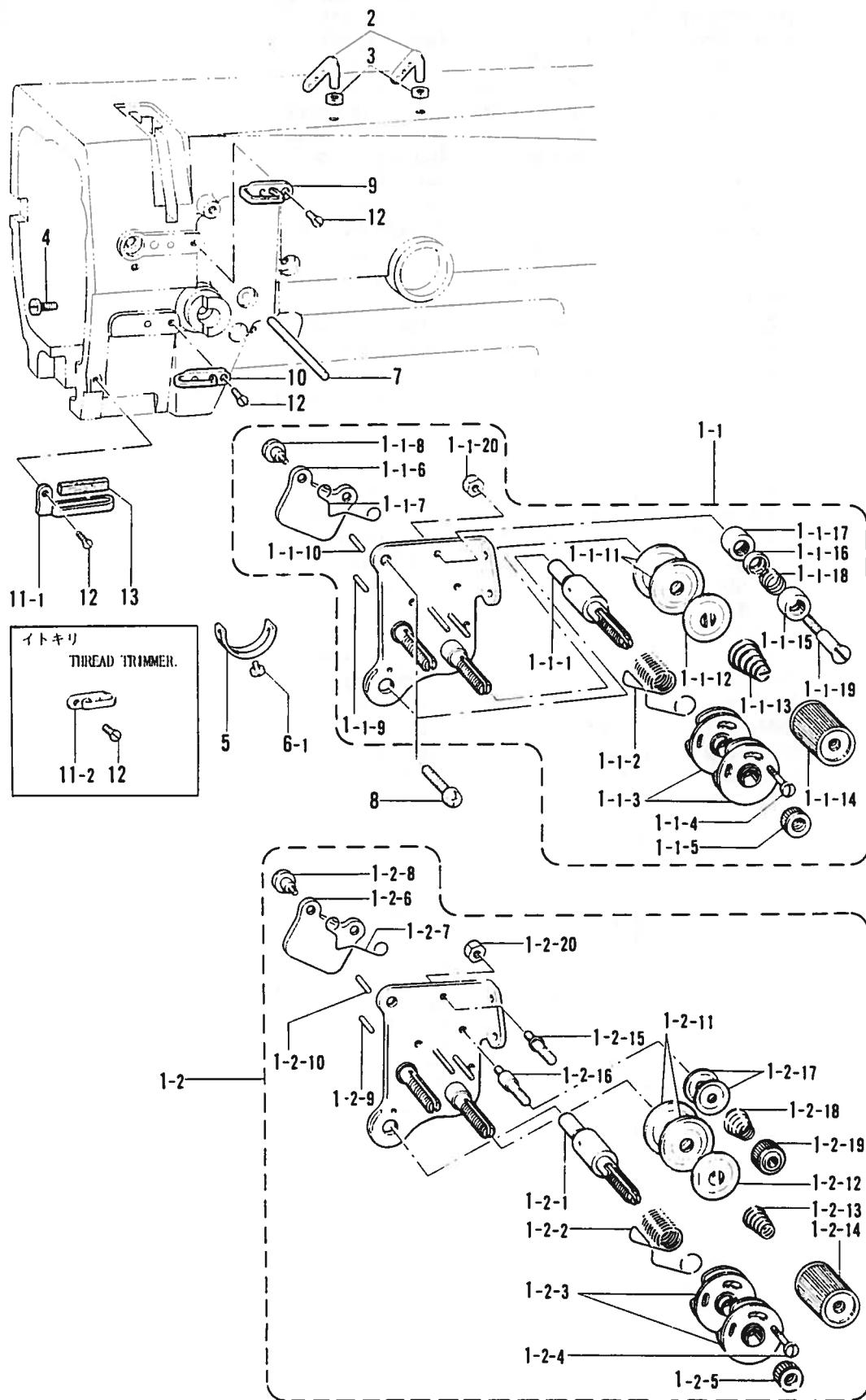
M. 糸通し関係 / Threading mechanism / Fadenführungs vorrichtung /
