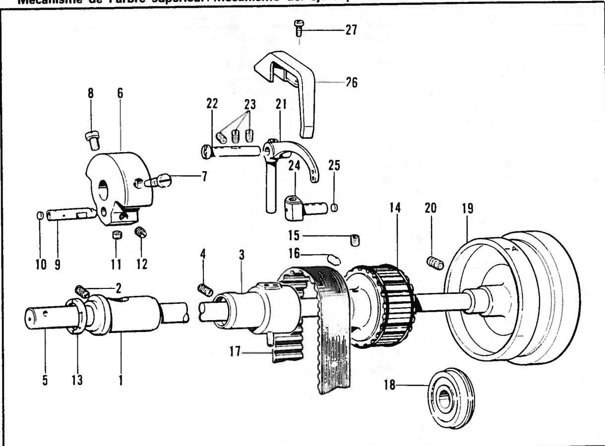
C. 針棒振動関係 / Needle bar rocking mechanism / Nadelstangenbetätigung /
