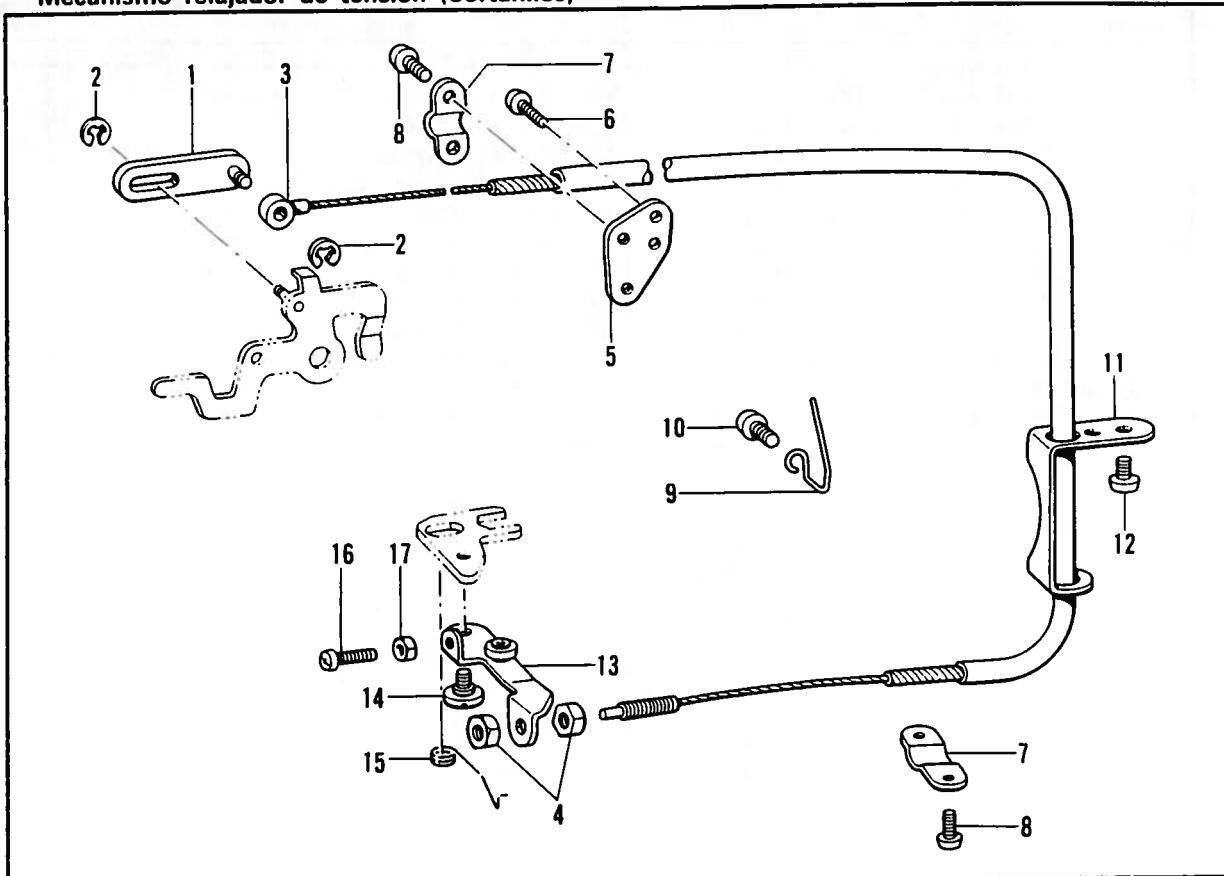
Q. 針位置検出器関係 (糸切り) / Synchronizer (Thread Trimmer) / Synchronisator (Fadenabschneider) /
