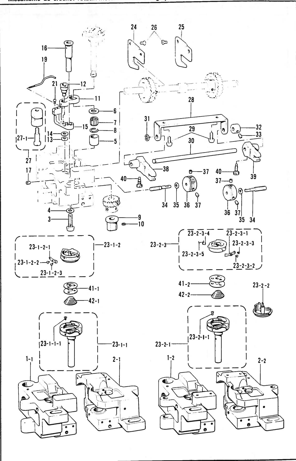
K. カマ関係 / Rotary hook mechanism / Greifervorrichtung /
