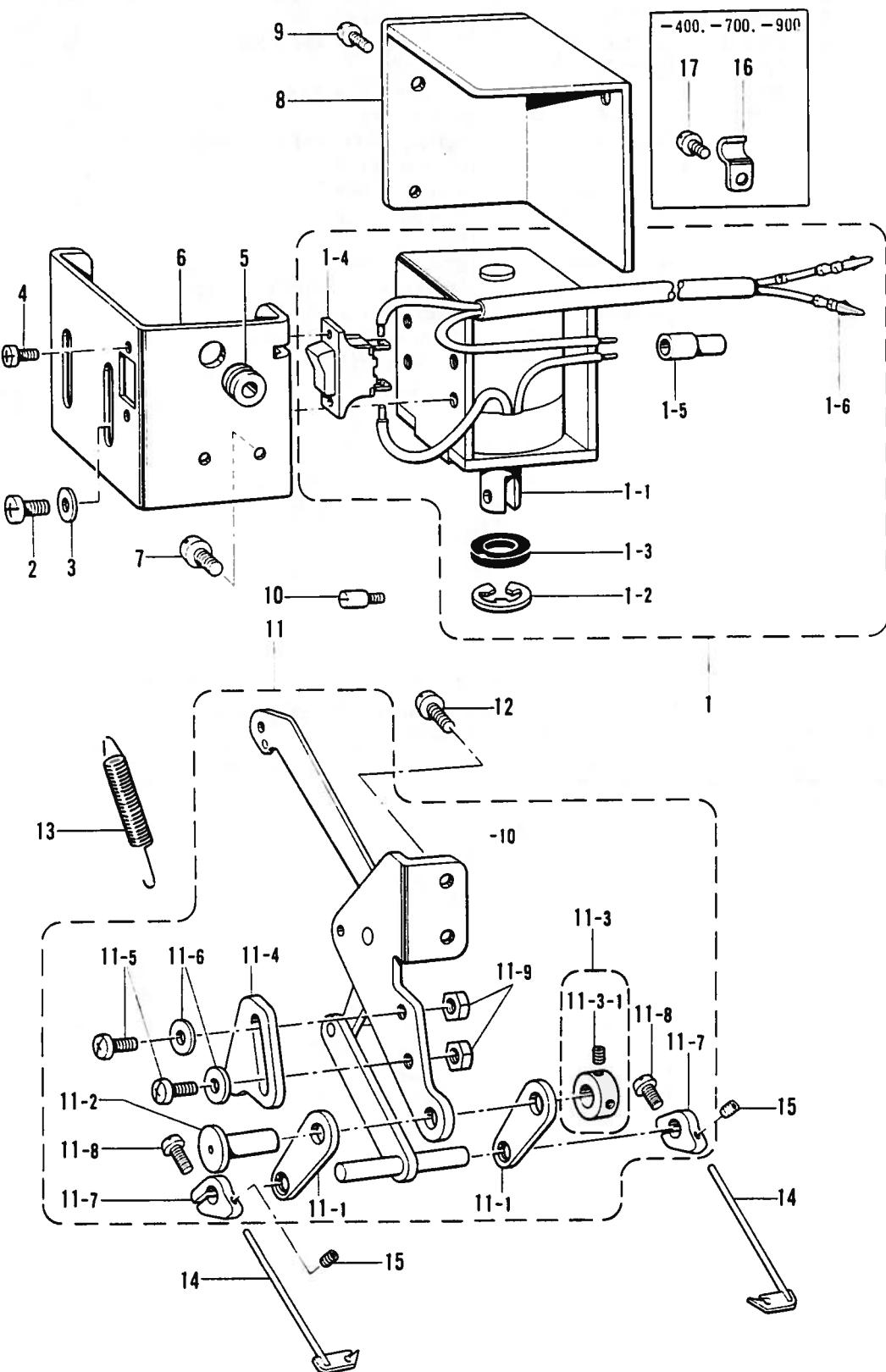
R. 糸扱イ関係 (糸切り) / Thread wiper mechanism (Thread Trimmer) / Fadenwischvorrichtung (Fadenabschneider)
