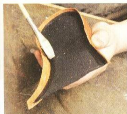
21 反折部分的皮革上面也要塗抹THREEDYNE接著劑，然後等THREEDYNE接著劑乾燥。
