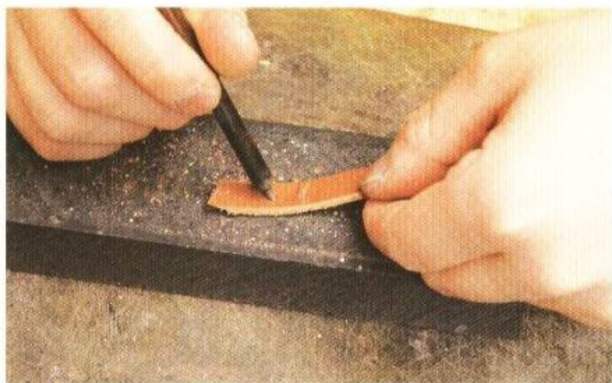
12 用打孔棒鑽孔。打孔棒的直徑可以選擇配合使用的縫線粗細。
