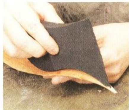
20 將捲皮與傾斜板貼合起來。請注意輕薄的尖端不要歪掉，謹慎地進行貼合工作。
