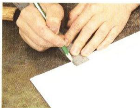
19 剝掉護條並貼在肯特紙上，畫出要反折起來的5mm寬的部分。這個部分要和輪廓線平行。畫好之後，再將配件裁切下來。這個是要當作鞋跟捲皮的紙型的。接著用正式的皮革裁切下來之後，再削薄成0.8~1.0mm厚。如果無法進行削薄工作的話，也可以選擇使用輕薄的皮革，或者是也可以選擇不製作捲皮。
