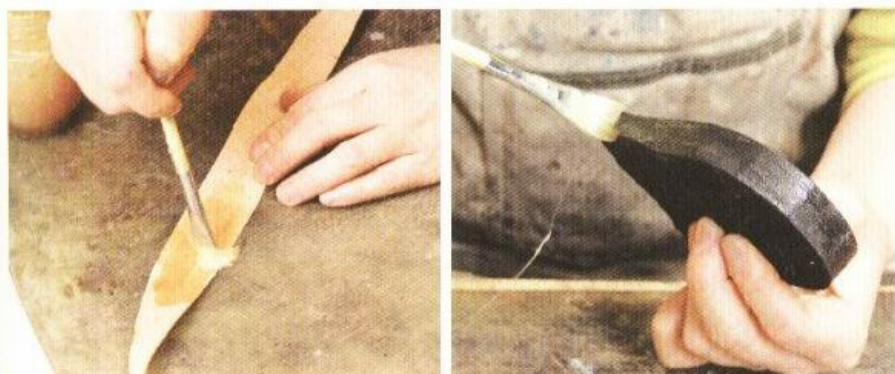
19 在傾斜板的側面貼上皮革，然後在捲皮與傾斜板的側面都塗上THREEDYNE接著劑之後，等THREEDYNE接著劑乾燥。
