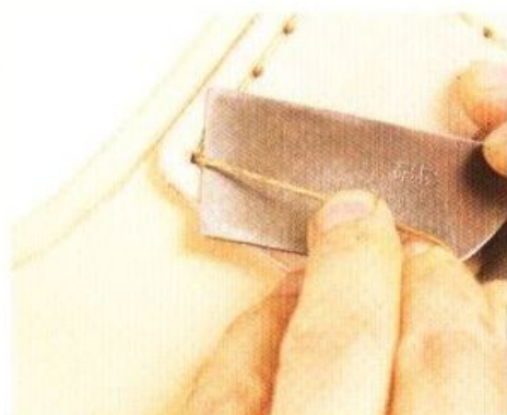
25 用皮革裁刀切掉從粗糙面與光滑面出來的縫線。因為是塗了瀝青的縫線不容易滑，所以不用接合劑來固定也可以。
