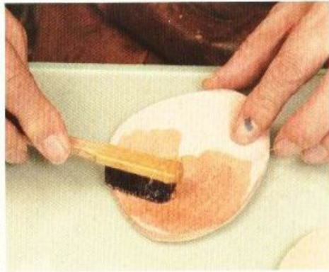
5 在橡膠本底的背面與本牛皮本底的粗糙面（背面）都塗上NOTAPE 8550接著劑，放置約20~30分鐘讓接著劑乾燥。請小心注意不要弄錯左右兩側的貼合面。
