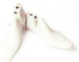
鞋楦 (二手) 以這個形狀為基準來製作鞋 子的工具
