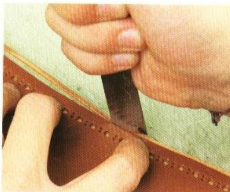
9 貼合後要進行尺寸的調整工作。用皮革裁刀切掉多餘的部分，然後用砂紙打磨。
