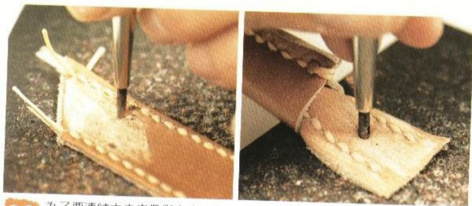
20 為了要連結中央皮帶與左右兩側的皮帶，要用1.2mm的打孔棒在適當的位置上鑽孔。中央皮帶要鑽一個孔，而左右兩側的皮帶各鑽兩個孔。
