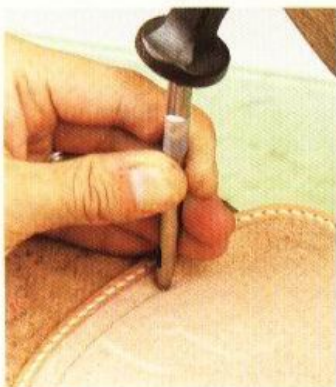
9 製作出要插入鞋帶的切口。對齊從紙型上所描繪下來的記號，用打孔棒鑽孔並切出溝槽。
