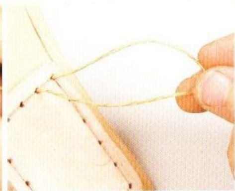
19 縫線的穿法與普通的平縫方法一樣，但是只需要將一邊的縫線插入縫線孔即可，不需要穿過全部的縫線，然後要像右邊照片一樣做出圈圈，並留下一些縫線。
