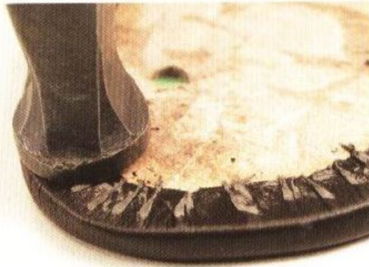
17 用皮革裁刀削掉因為拉近而凸起來的部分，然後再一次用榔頭來進行平整工作。
