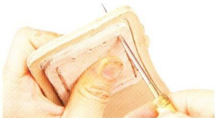
16 然後再用長錐子將孔變大。鑽出來的孔的大小會根據使用的縫線而有所改變。
