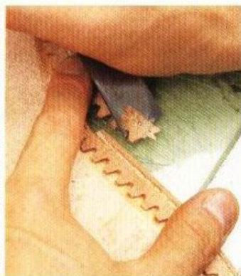
7 等四周都貼合起來之後，在終點的重疊部分做上記號，然後像和起點重疊一樣地來進行斜削薄工作。
