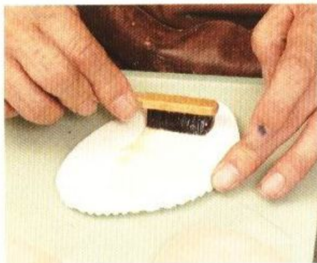
5 在橡膠本底的背面與本牛皮本底的粗糙面（背面）都塗上NOTAPE 8550接著劑，放置約20~30分鐘讓接著劑乾燥。請小心注意不要弄錯左右兩側的貼合面。
