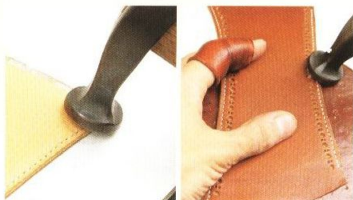
14 用榔頭從表面與背面來敲打縫線，讓針目安定下來。
