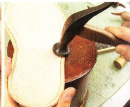
6 將削薄部分朝向表面，然後將押緣貼在鞋墊上。貼合的部分馬上要用榔頭敲打使之緊密地壓著起來。
