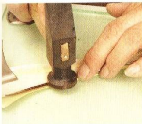
9 因為反折起來的皮革會有厚度，所以將尼龍膠帶貼在內側1mm的地方的話，反折時，紙型與尺寸就會變得恰恰好。
