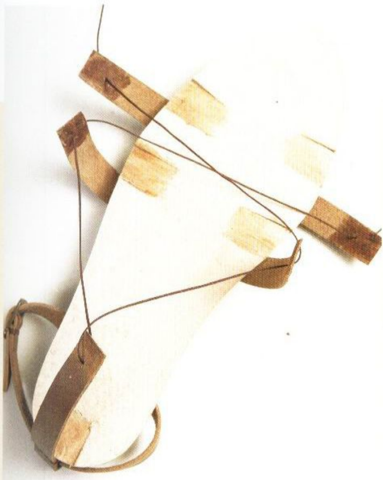
14 將縫線穿過12所鑽出來的孔。像這樣用一條縫線就可以將全部的皮帶給連結起來，而且皮帶也不容易脫落。
