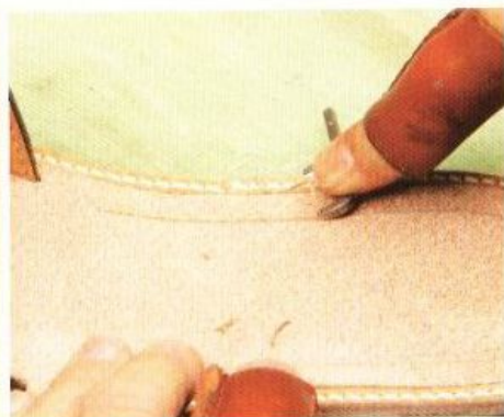
15 將銀筆間矩規設定在從邊緣到記號為止的距離，然後在記號到記號之間畫線。線畫出來之後，再用拉溝器沿著線條來挖掘出溝槽。
