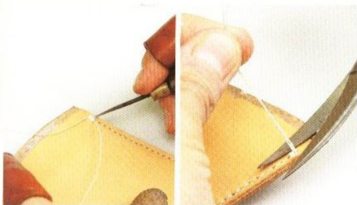
13 縫合工作結束之後，要讓縫線從背面出來之後再打結。然後用接合劑固定之後，再用剪刀剪掉縫線。
