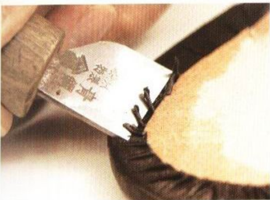
17 用皮革裁刀削掉因為拉近而凸起來的部分，然後再一次用榔頭來進行平整工作。
