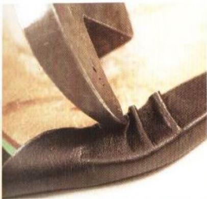
14 外側曲線的部分要將皮革拉近以來進行貼合工作。
