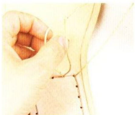
21 將繞成圈圈的縫線往外拉，然後將另一條縫線穿過縫線孔。
