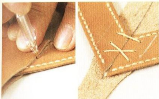
27 將皮帶放置在中央皮帶上，並在皮帶上畫出中央皮帶寬度的線條。中央皮帶要對齊兩端並折起來。
