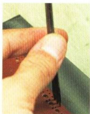
11 用菱斬沿著上下兩端的邊緣來鑽出縫線孔。木島老師所使用的是間隔比較窄，刀頭比較細的加工過的菱斬。
