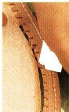
10 在會和溝槽邊緣接觸的押緣鋸齒上來進行削薄工作。如果可以先將和鞋墊之間的高低差消除的話，等一下的接著工作就可以比較容易進行。
