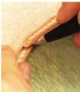
7 等四周都貼合起來之後，在終點的重疊部分做上記號，然後像和起點重疊一樣地來進行斜削薄工作。
