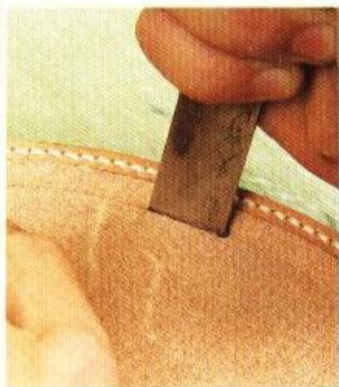
9 製作出要插入鞋帶的切口。對齊從紙型上所描繪下來的記號，用打孔棒鑽孔並切出溝槽。
