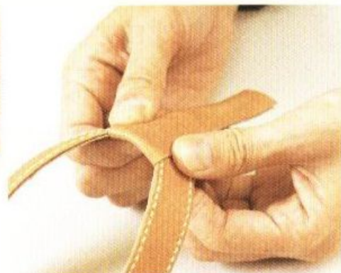
29 對齊27所畫出來的線條，將中央皮帶貼合起來。左右兩側可以稍微彎曲，在有折痕的狀態下來進行貼合工作。
