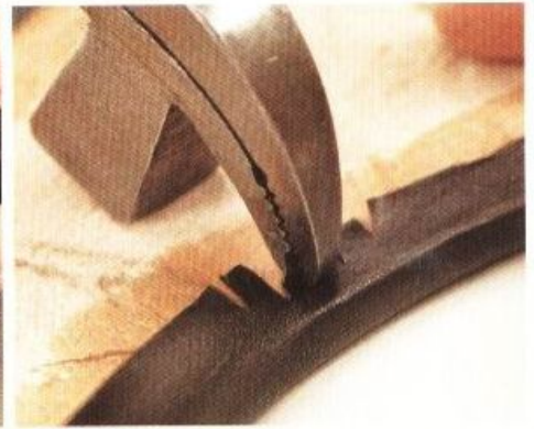
15 內側曲線的部分用剪刀先剪出切口再進行貼合工作的話，就不容易產生皺摺，而且也可以完成漂亮的貼合工作。
