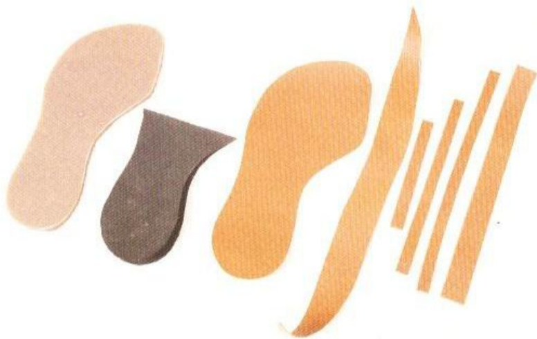
20 照片中的是已裁切出來的全部配件。接下來要用銀筆來描繪出紙型的記號，並將所有的配件組裝起來。
