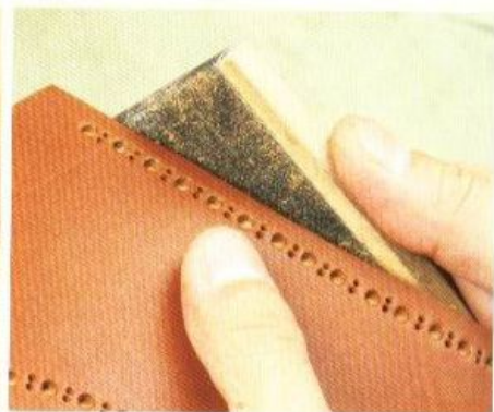
9 貼合後要進行尺寸的調整工作。用皮革裁刀切掉多餘的部分，然後用砂紙打磨。
