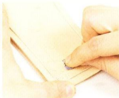
8 將本牛皮的鞋墊對齊本底並畫線，然後用砂紙將線條內側的部分弄粗糙。
