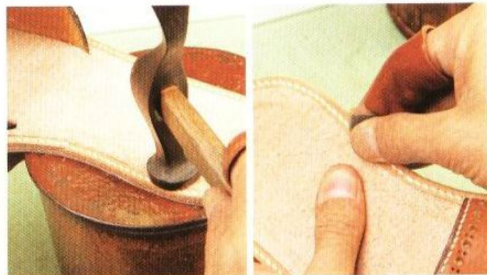
13 接著之後請務必用榔頭等工具來敲打壓著。貼合工作完成之後，要來進行毛邊的打磨工作。
