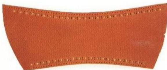
11 用菱斬沿著上下兩端的邊緣來鑽出縫線孔。木島老師所使用的是間隔比較窄，刀頭比較細的加工過的菱斬。
