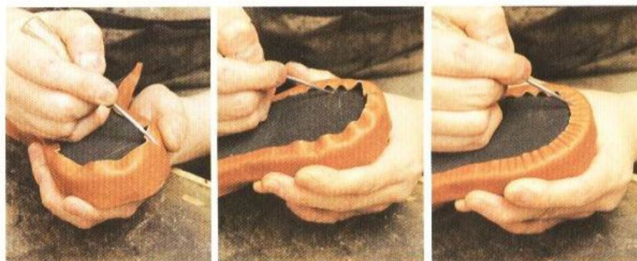
22 使用錐子等工具將捲皮間隔地反折起來。如果可以消除突出的部分，就能慢慢地仔細地反折起來。
