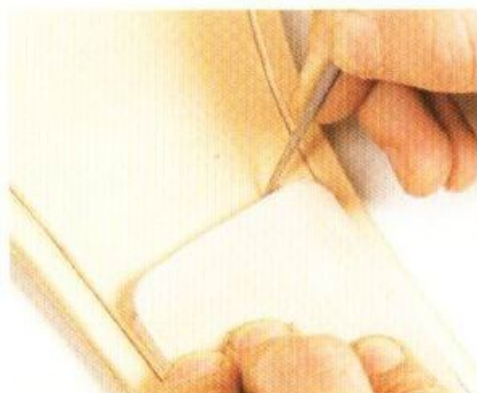
8 將本牛皮的鞋墊對齊本底並畫線，然後用砂紙將線條內側的部分弄粗糙。
