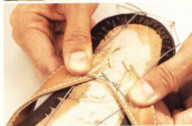
23 先將中央皮帶與鞋墊貼合起來。一邊將縫線往外拉，一邊將左右兩側的皮帶貼上去。
