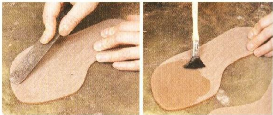
17 用木製銼刀將CRAPE鞋底的接著面弄粗糙。鞋底容易從邊緣的部分剝落，所以請確實地將所有的地方都弄粗糙。弄粗糙之後，請塗上PRIMER打底劑（P-740）。
