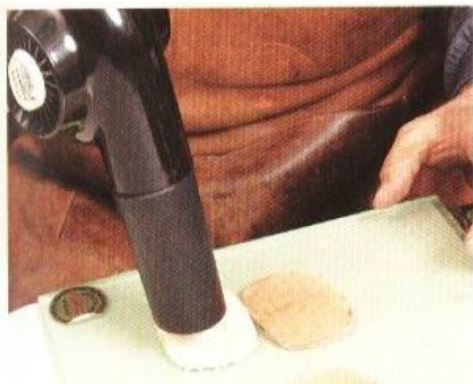
8 本底後也一樣塗上NOTAPE 8550接著劑，等接著劑乾了之後，用吹風機溫熱，然後貼合起來。
