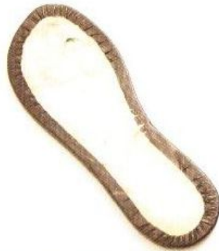
16 外皮全部貼合起來之後，用榔頭敲打並壓著起來，然後平整因為拉近而凸起來的部分。
