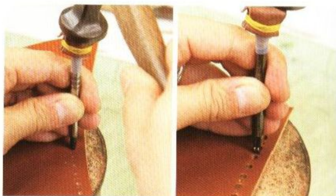
6 對齊做出來的記號鑽孔。大的孔可以用3mm的打孔棒來進行鑽孔工作。
