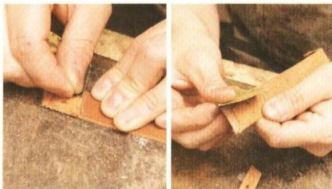
14 用砂紙將鞋帶的反折部分（光滑面）弄粗糙。然後用砂紙打磨鞋帶與鞋墊的側面會接觸到腳的部分的所有邊緣。
