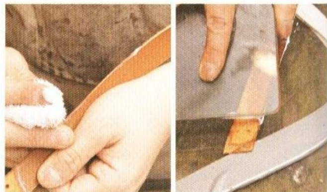
15 在鞋墊的側面、鞋帶的側面與鞋帶的粗糙面都塗上背面處理劑。然後側面請用布料，粗糙面則是用玻璃紙來進行打磨工作。
