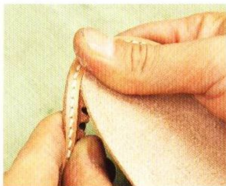
6 將削薄部分朝向表面，然後將押緣貼在鞋墊上。貼合的部分馬上要用榔頭敲打使之緊密地壓著起來。
