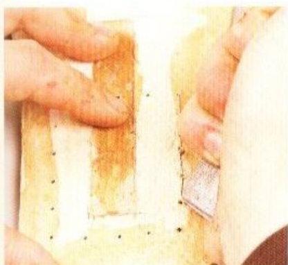
17 全部的孔都鑽出來之後，請在粗糙面上挖掘出可以連結所有孔的溝槽。
