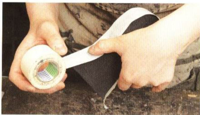
17 在裁切出來的傾斜板側面貼上護條。
