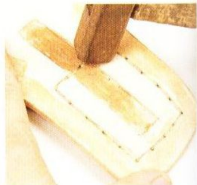
26 縫製工作完成之後，再用槌頭敲打讓針目安定下來。
