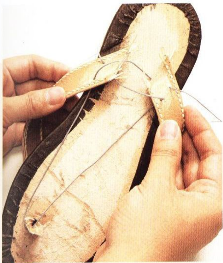
22 將中央皮帶插入鞋底，然後像照片一樣用縫線連結起來。
