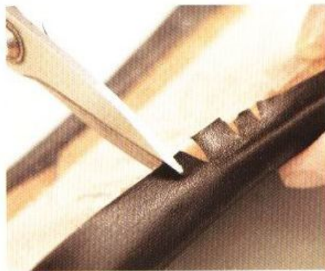
15 內側曲線的部分用剪刀先剪出切口再進行貼合工作的話，就不容易產生皺摺，而且也可以完成漂亮的貼合工作。
