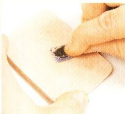
7 用砂紙打磨鞋墊兩面的話，就可以變得比較容易進行接著工作。
