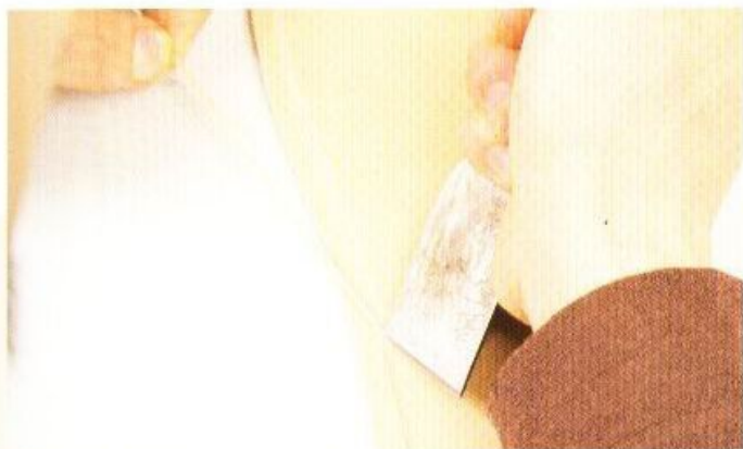
3 在距離1mm的地方，傾斜地切出切割線，讓切割線成V字型。
