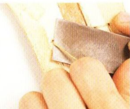
25 用皮革裁刀切掉從粗糙面與光滑面出來的縫線。因為是塗了瀝青的縫線不容易滑，所以不用接合劑來固定也可以。
