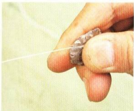
12 使用有塗抹瀝青的麻線用平縫方法來進行縫合工作。最初的一個縫線孔要往回縫成雙重縫線後再來進行縫合工作。
