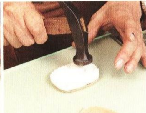
8 本底後也一樣塗上NOTAPE 8550接著劑，等接著劑乾了之後，用吹風機溫熱，然後貼合起來。
