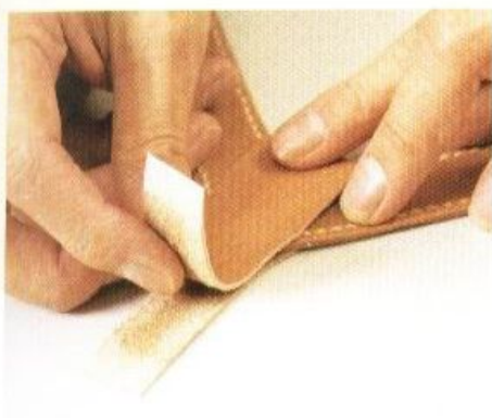
29 對齊27所畫出來的線條，將中央皮帶貼合起來。左右兩側可以稍微彎曲，在有折痕的狀態下來進行貼合工作。
