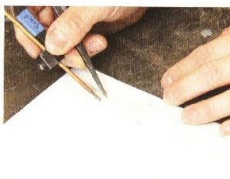
19 剝掉護條並貼在肯特紙上，畫出要反折起來的5mm寬的部分。這個部分要和輪廓線平行。畫好之後，再將配件裁切下來。這個是要當作鞋跟捲皮的紙型的。接著用正式的皮革裁切下來之後，再削薄成0.8~1.0mm厚。如果無法進行削薄工作的話，也可以選擇使用輕薄的皮革，或者是也可以選擇不製作捲皮。
