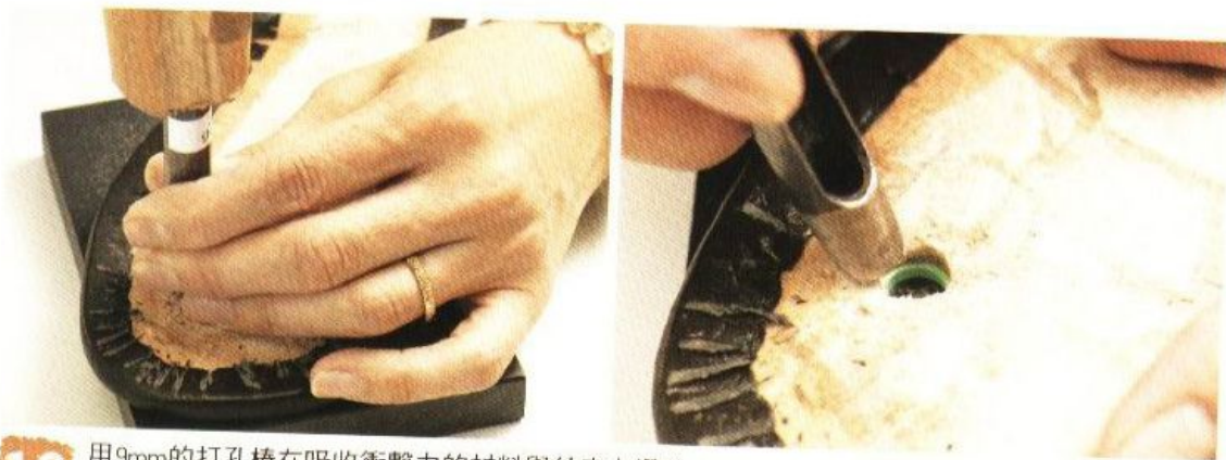
18 用9mm的打孔棒在吸收衝擊力的材料與外皮上鑽孔。
