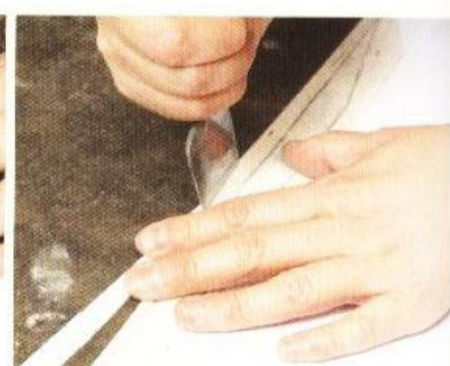
19 剝掉護條並貼在肯特紙上，畫出要反折起來的5mm寬的部分。這個部分要和輪廓線平行。畫好之後，再將配件裁切下來。這個是要當作鞋跟捲皮的紙型的。接著用正式的皮革裁切下來之後，再削薄成0.8~1.0mm厚。如果無法進行削薄工作的話，也可以選擇使用輕薄的皮革，或者是也可以選擇不製作捲皮。
