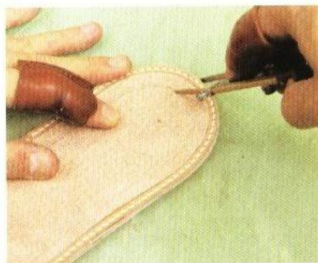
15 將銀筆間矩規設定在從邊緣到記號為止的距離，然後在記號到記號之間畫線。線畫出來之後，再用拉溝器沿著線條來挖掘出溝槽。
