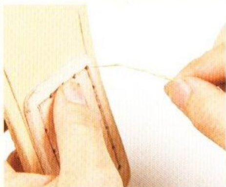
18 在這裡要使用被稱為手縫Mckay工法的方法（使用毛針的縫製方法）來進行縫合工作。搓揉上了瀝青的縫線尖端，然後將縫線穿過縫線孔。
