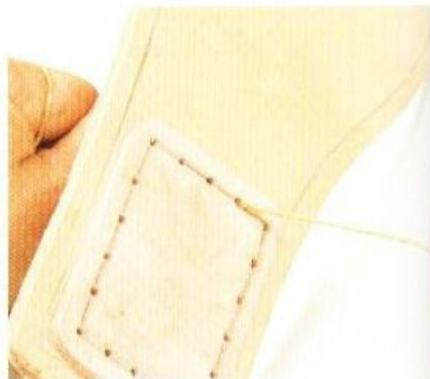
22 解開捲起來的縫線並往外拉的話，縫線就會從兩面出來。請確實將縫線往外拉並束緊，然後重覆這些動作來進行縫合工作。
