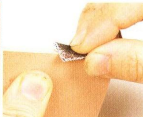
6 將本牛皮鞋墊的多餘部分切掉，讓鞋墊可以收納在溝槽內側。切掉多餘的部分之後，先用砂紙打磨毛邊。
