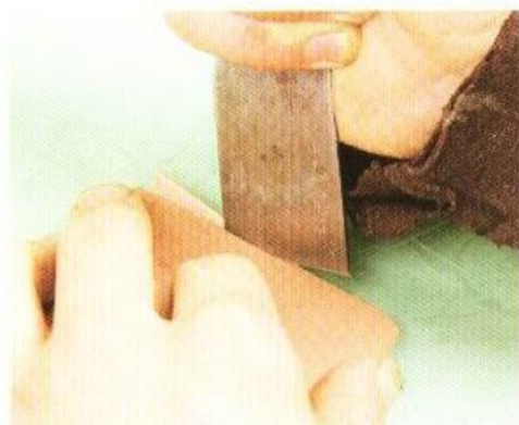
6 將本牛皮鞋墊的多餘部分切掉，讓鞋墊可以收納在溝槽內側。切掉多餘的部分之後，先用砂紙打磨毛邊。
