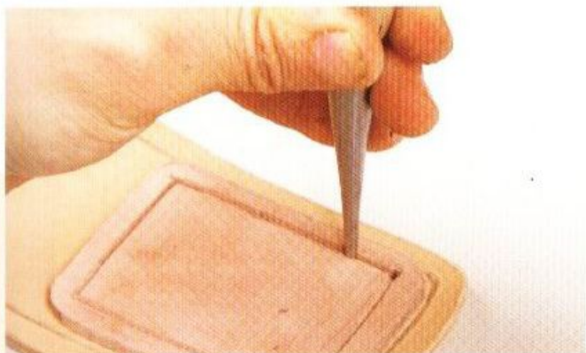
15 將兩個面貼合起來之後，用打錐在間矩規所做出來的記號上鑽孔。
