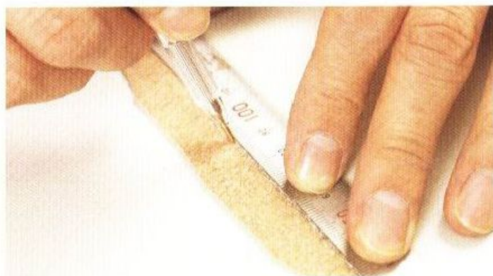
26 在中央皮帶的粗糙面（背面）上畫出縱向的中心線。
